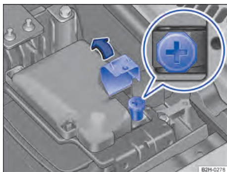
Fig. 205 No compartimento do motor, à esquerda: polo positivo do ponto de auxílio à partida.
