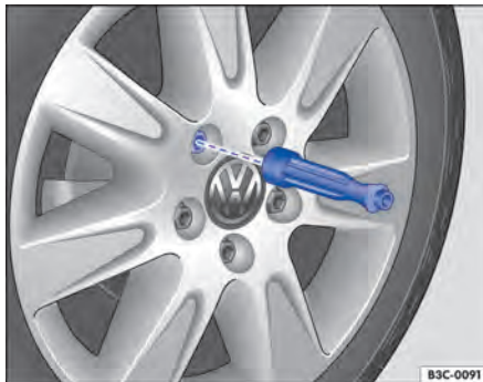
Fig. 187 Troca de roda: desaparafusar os parafusos de roda com o punho da chave de fenda.
