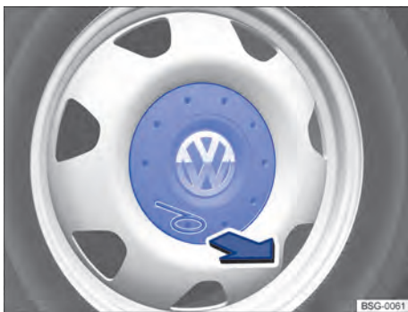
Fig. 174 Retirar a calota central.
