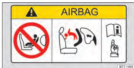
Fig. 71 Etiqueta do airbag no para-sol (representação esquemática).
