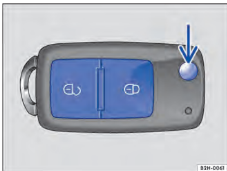
Fig. 18 Botões na chave do veículo e botão para rebaatar a haste da chave para fora.
