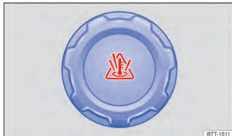
Fig. 153 No compartimento do motor: tampa do reservatório de expansão do líquido de arrefecimento do motor.
