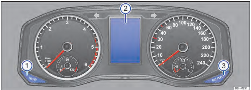
Fig. 158 Botões no instrumento combinado no painel de instrumentos.
