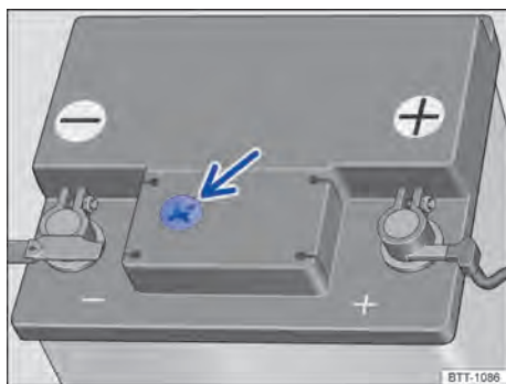
Fig. 155 Representação esquemática: visor no lado superior da bateria do veículo.
