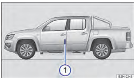
Fig. 161 Na da porta do condutor: etiqueta de pressão dos pneus.
