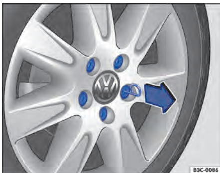
Fig. 175 Remover as capas de cobertura dos parafusos de roda.
