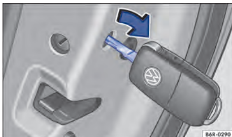
Fig. 170 Travamento de emergência do veículo com a chave do veículo.
