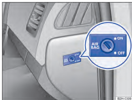
Fig. 68 Na parte frontal no lado do passageiro dianteiro: interruptor acionado pela chave para desativar e ativar o airbag frontal do passageiro dianteiro.
