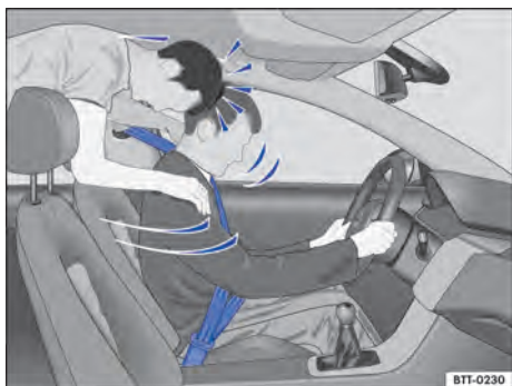
Fig. 54 O passageiro sem cinto de segurança no banco traseiro é lançado para frente sobre o condutor com cinto de segurança.
