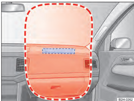
Fig. 67 Local de instalação e área de expansão do airbag frontal do passageiro dianteiro.
