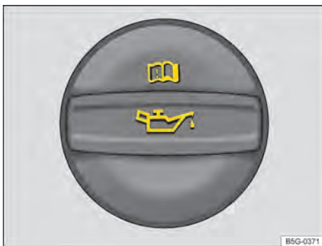
Fig. 150 No compartimento do motor: tampa da abertura para enchimento de óleo do motor (representação esquemática).
