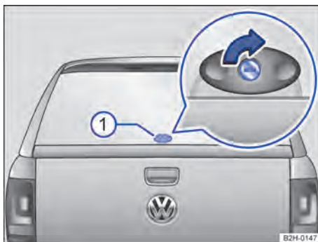
Fig. 31 Abrir a capota rígida do compartimento de carga.
