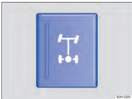
Fig. 143 No console central: botão do bloqueio do diferencial do eixo traseiro.
