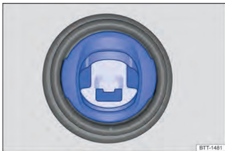
Fig. 136 No bocal de abastecimento do reservatório: proteção contra abastecimento incorreto.
