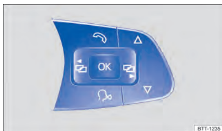
Fig. 14 Veículos com volante multifunções: botões para comandar os menus no instrumento combinado.
