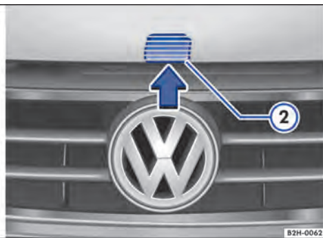
Fig. 147 ① Na área para os pés no lado do condutor: alavanca de destravamento da tampa do compartimento do motor. ② Alavanca de destravamento para abrir a tampa do compartimento do motor na grade do radiador.
