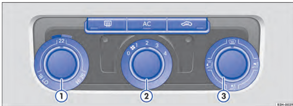
Fig. 127 No painel de instrumentos: comandos do Climatic.
