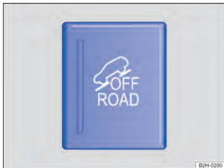
Fig. 144 No console central: botão para ligar e desligar a função off-road manualmente.
