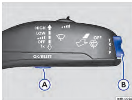
Fig. 13 Veículos sem volante multifunções: botão (A) na alavanca dos limpadores do para-brisa para confirmar itens de menu e chave (B) para trocar menus.
