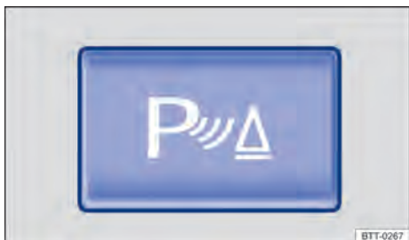
Fig. 121 No console central: botões para ligar e desligar o Park Pilot (dependendo da versão).
