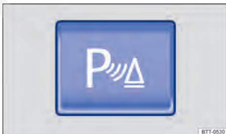
Fig. 111 Na parte superior do console central: botão para ligar e desligar o controle de distância de estacionamento (Park Pilot).
