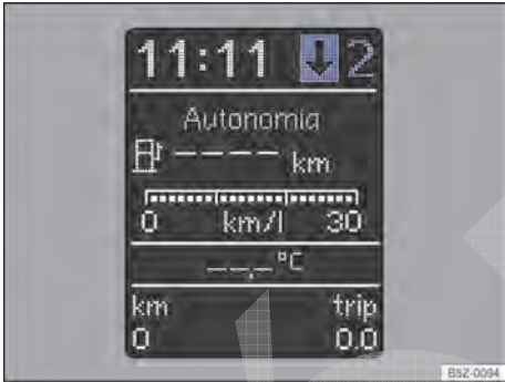
Fig. 96 No instrumento combinado: indicador de troca de marcha (variante 1).
