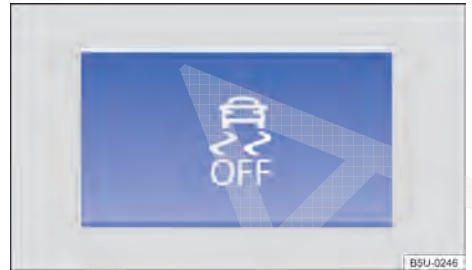
Fig. 105 No console central: botão para desligar e ligar ASR manualmente.
