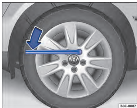
Fig. 146 Troca de roda: soltar os parafusos da roda.
