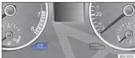
Fig. 59 No instrumento combinado: botão de regulagem da iluminação dos instrumentos e dos interruptores.
