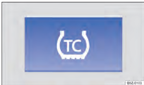
Fig. 106 No console central: botão para desligar e ligar TC (controle de tração) manualmente.
