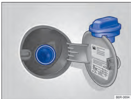
Fig. 127 Portinhola do tanque de combustível aberta com a tampa do tanque de combustível pendurada.
