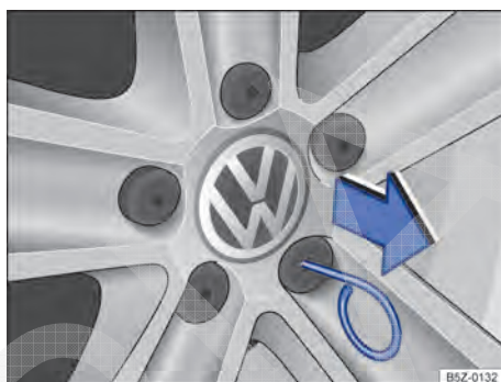
Fig. 143 Retirar as capas de cobertura dos parafusos da roda.
