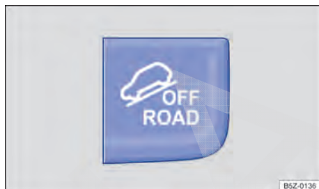
Fig. 110 No console central: botão para ligar e desligar o modo off-road manualmente.
