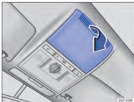
Fig. 163 No revestimento do teto: remover a cobertura.
