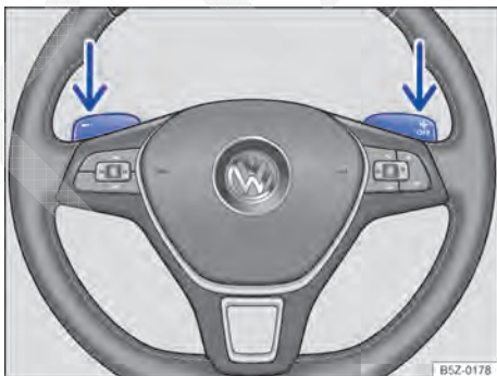
Fig. 101 Volante com dois seletores para troca de marcha no modo manual.
