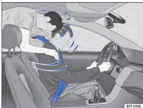
Fig. 44 O passageiro sem cinto de segurança no banco traseiro é lançado para frente sobre o condutor com cinto de segurança.
