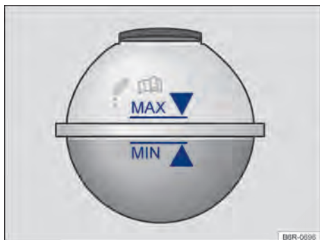
Fig. 133 No compartimento do motor: marcação no reservatório de expansão do líquido de arrefecimento do motor.
