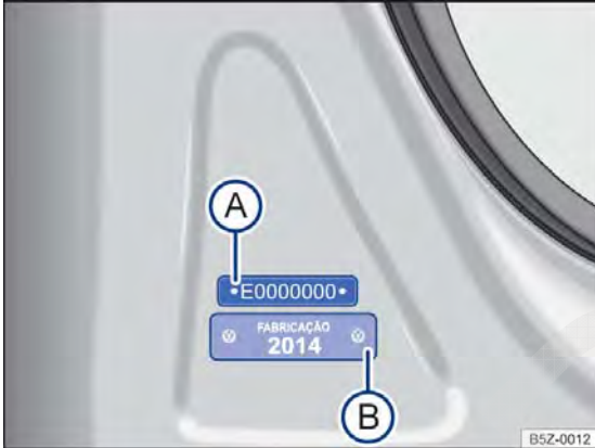
Fig. 17 Na coluna da porta dianteira direita: etiqueta com o número de identificação do veículo parcial (A) e etiqueta de identificação do ano de fabricação (B).
