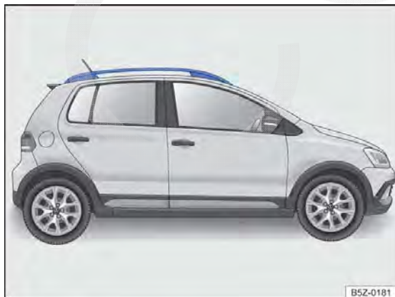
Fig. 81 Suportes longitudinais do bagageiro do teto (ambos os lados)
