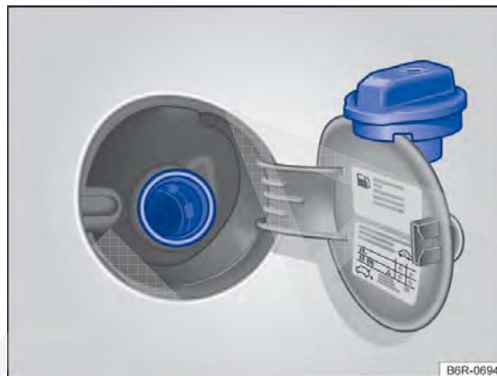
Fig. 126 Portinhola do tanque de combustível aberta com a tampa do tanque de combustível pendurada.
