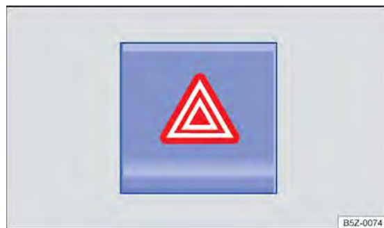
Fig. 149 Na parte superior do console central: interruptor para ligar e desligar as luzes de advertência.
