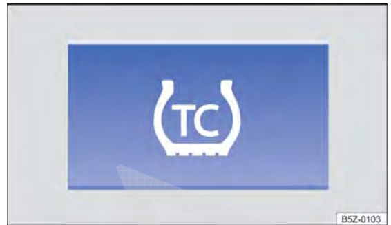
Fig. 111 No console central: botão para desligar e ligar TC (controle de tração) manualmente.
