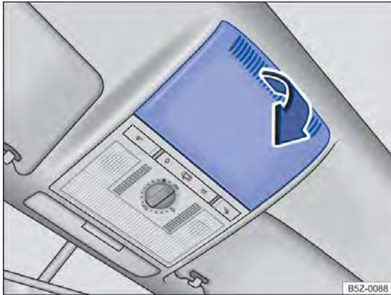
Fig. 158 No revestimento do teto: remover a cobertura.
