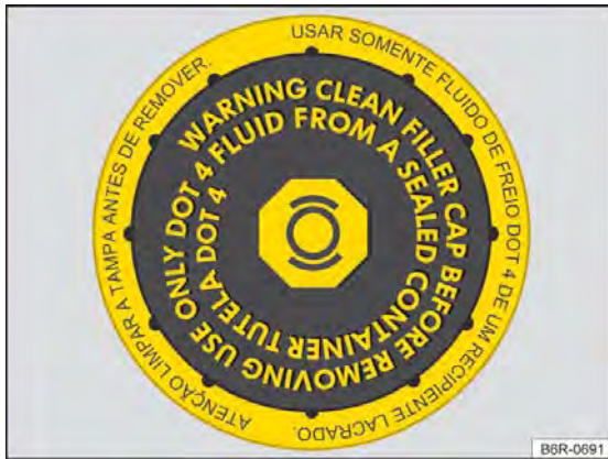
Fig. 112 No compartimento do motor: tampa do reservatório de fluido de freio.
