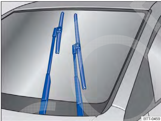
Fig. 68 Limpadores dos vidros na posição de serviço.
