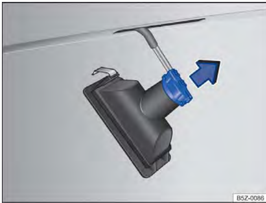
Fig. 184 Lanterna da placa de licença: remover o soquete da lâmpada.
