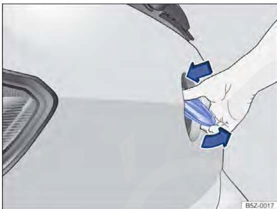
Fig. 31 Abrir a tampa traseira por fora.
