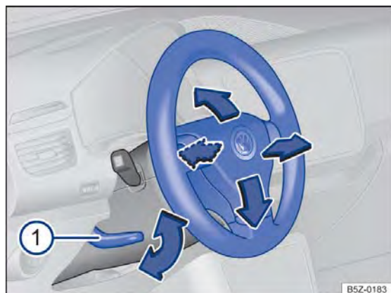
Fig. 42 Ajustar a posição do volante mecanicamente.
