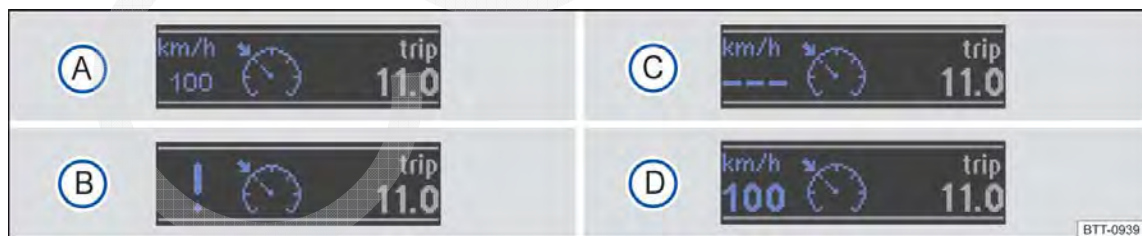
Fig. 119 No display do instrumento combinado: indicadores de status do GRA.
