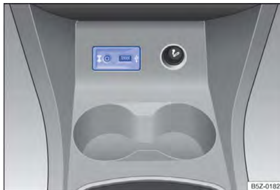
Fig. 86 No console central dianteiro: interface USB e entrada AUX-IN
