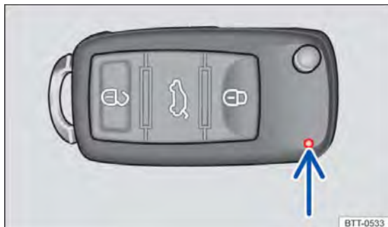
Fig. 22 Luz de controle da chave do veículo com comando remoto.
