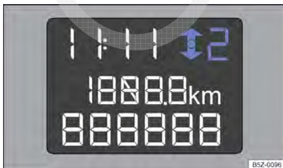
Fig. 102 No instrumento combinado: indicador de troca de marcha (variante 2).
