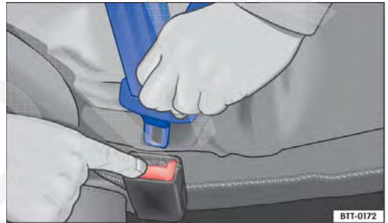
Fig. 50 Soltar a lingueta do cinto de segurança do fecho do cinto de segurança.
