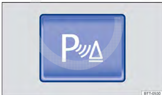
Fig. 114 Na parte superior do console central: botão para ligar e desligar o controle de distância de estacionamento (Park Pilot).
