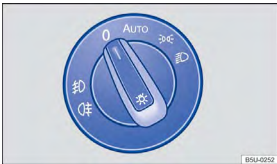
Fig. 61 No painel: interruptor das luzes.
