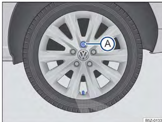
Fig. 164 Retirar a calota integral.
