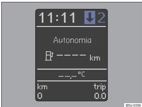
**Fig. 78** No instrumento combinado: indicador de troca de marcha (variante 2).
