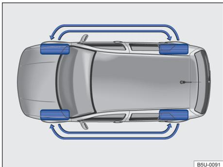
Fig. 135 Esquema para a troca das rodas.
