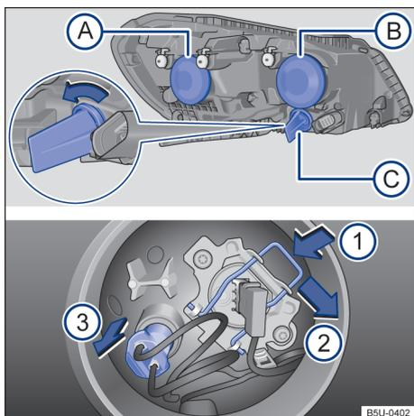
**Fig. 109** No compartimento do motor: vista traseira do farol dianteiro com cobertura de borracha (lado esquerdo da ilustração) - (A) farol baixo, (B) farol alto e luz de posição, e (C) indicador de direção. Vista traseira do farol dianteiro sem a cobertura de borracha (lado direito da ilustração): ① mola de travamento da lâmpada incandescente do farol e ② luz de posição.
