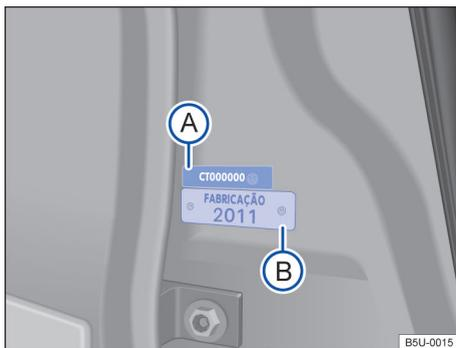
**Fig. 151** Na coluna da porta dianteira direita: etiqueta com o número de identificação do veículo parcial (A) e etiqueta de identificação do ano de fabricação (B).
