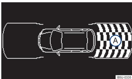
**Fig. 90** Exibição do display do controle de distância de estacionamento traseiro no rádio (não disponível para algumas versões).
