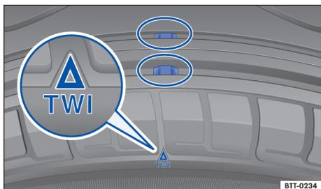
Fig. 137 Perfil do pneu: indicadores de desgaste.
