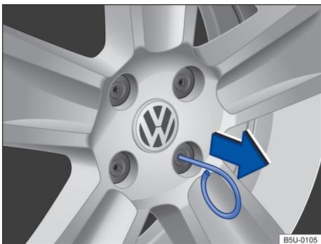
Fig. 140 Retirar as capas de cobertura dos parafusos da roda.
