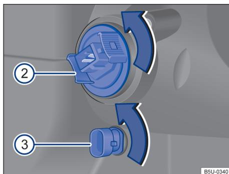
**Fig. 108** No compartimento do motor: vista traseira do farol dianteiro (2) indicadores de direção e (3) luz de posição.
