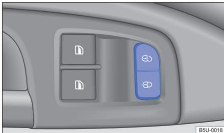
**Fig. 46** Na porta do condutor: teclas do travamento central.
