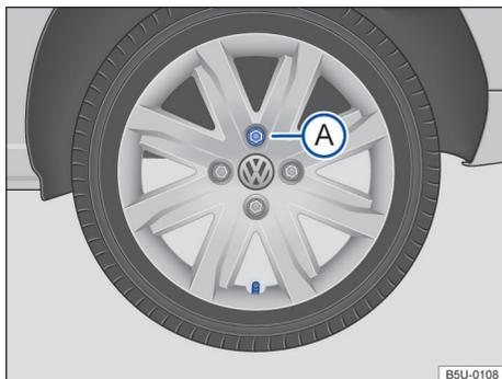
**Fig. 144** Troca de roda: sequência de remoção dos parafusos da roda.
