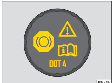
Fig. 131 No compartimento do motor: tampa do reservatório de fluido de freio.
