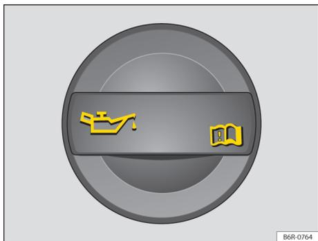
Fig. 128 No compartimento do motor: tampa da abertura para enchimento de óleo do motor.
