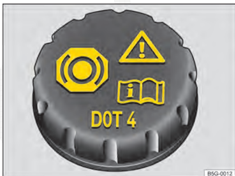
Fig. 131 No compartimento do motor: Tampa do reservatório de fluido de freio (versão 1).
