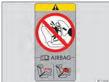
Fig. 72 Representação esquemática: etiqueta de airbag na coluna B.
