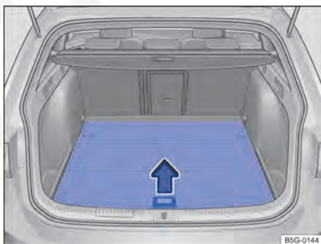
Fig. 201 No compartimento de bagagem: abrir o assoalho do compartimento de bagagem.
