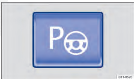
Fig. 144 Na parte inferior do console central: botão para ligar o assistente de direção para estacionamento.
