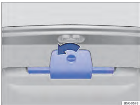
Fig. 192 Na tampa do compartimento de bagagem: suporte para o triângulo de segurança.
