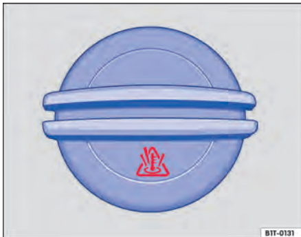
Fig. 178 No compartimento do motor: tampa do reservatório de expansão do líquido de arrefecimento do motor.
