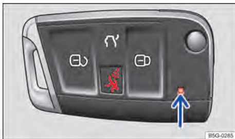
Fig. 20 Luz de controle da chave do veículo com botão do alarme.
