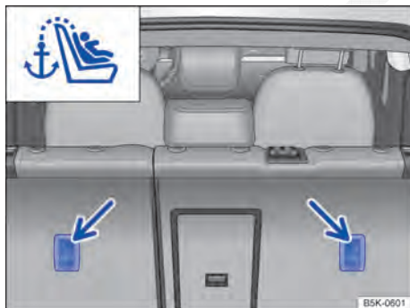
Fig. 76 Olhais de retenção para o cinto de fixação superior no lado de trás do banco traseiro.
