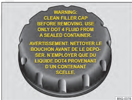
Fig. 132 No compartimento do motor: Tampa do reservatório de fluido de freio (versão 2).
