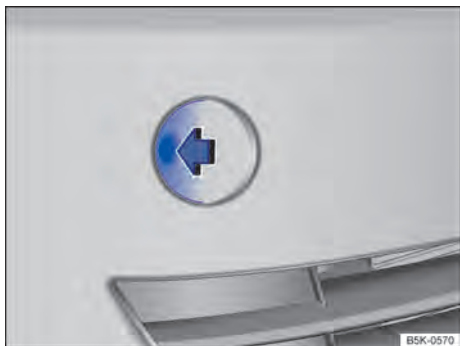
Fig. 229 No para-choque dianteiro à direita: remover a cobertura.
