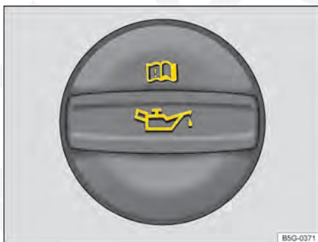
Fig. 175 No compartimento do motor: tampa da abertura para enchimento de óleo do motor.
