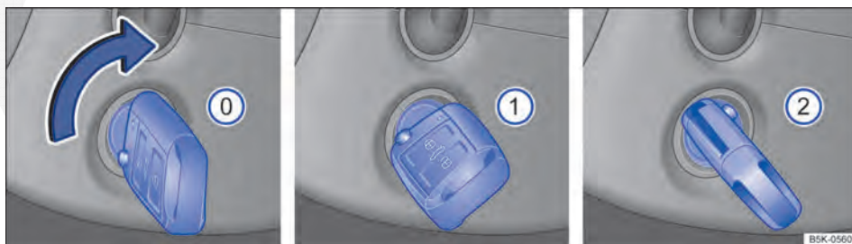
Fig. 119 Posições da chave do veículo no cilindro da ignição.
