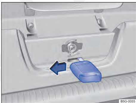
Fig. 197 Na tampa do compartimento de bagagem: destravar a tampa do compartimento de bagagem.
