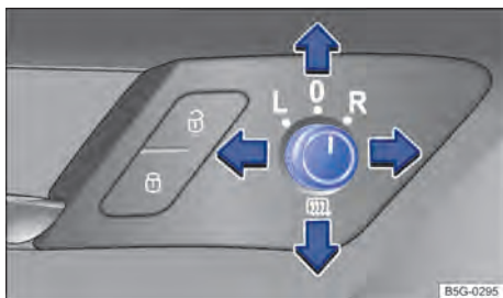
Fig. 91 Na porta do condutor: botão rotativo dos espelhos retrovisores externos.
