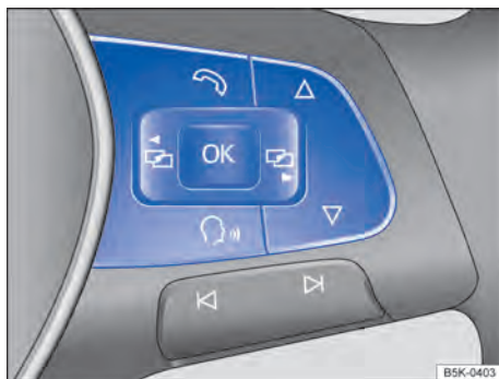
Fig. 15 Lado direito do volante multifunções: botões para comando dos menus e exibições de informação do instrumento combinado.
