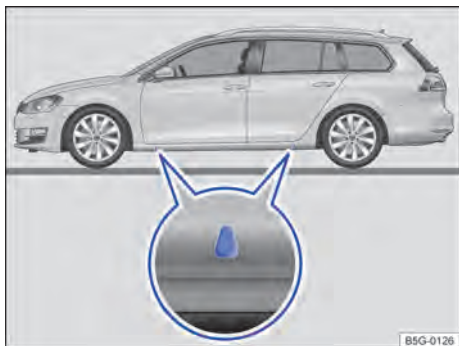
Fig. 209 Pontos de apoio do macaco.
