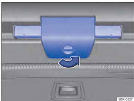
Fig. 196 Na tampa do compartimento de bagagem: abrir o suporte para o triângulo de segurança.
