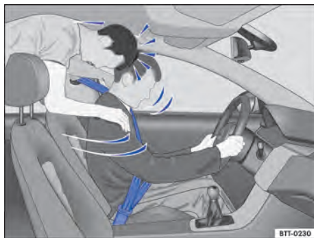
Fig. 57 O passageiro sem cinto de segurança no banco traseiro é lançado para frente sobre o condutor com cinto de segurança.
