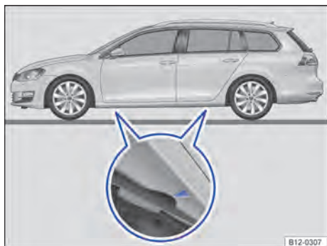
Fig. 211 Pontos de apoio do macaco.
