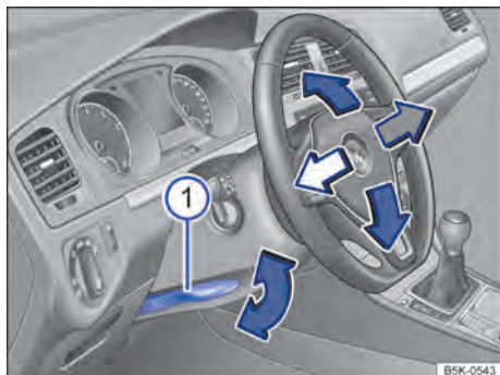
Fig. 47 Embaixo do volante no revestimento da coluna de direção: alavanca de ajuste mecânico da posição do volante.
