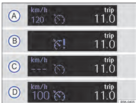
Fig. 148 No display do instrumento combinado: indicadores de status do GRA.
