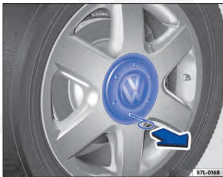
Fig. 203 Retirar a calota central.
