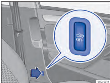
Fig. 28 Ao lado do banco do condutor: botão para desligar o monitoramento do interior do veículo e o alarme antirrebocagem.
