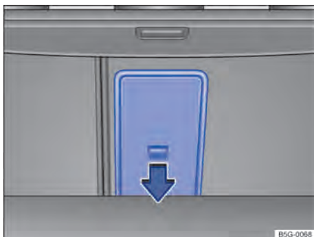
Fig. 96 No compartimento de bagagem: abrir o dispositivo para transporte de objetos longos.
