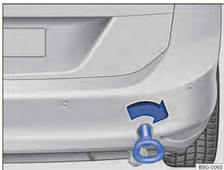
Fig. 232 No para-choque traseiro à direita: rosquear a argola de reboque.
