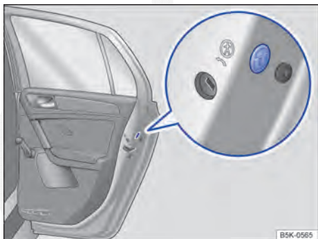
Fig. 194 Na parte dianteira da porta traseira direita: travamento de emergência, coberto por uma vedação de borracha.
