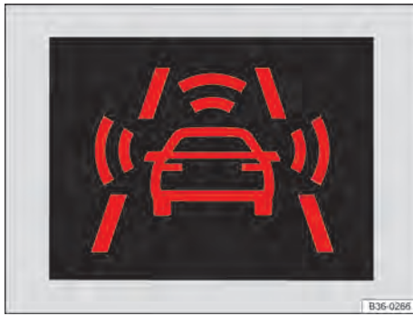
Fig. 161 No display do instrumento combinado: exibição do alerta antecipado.
