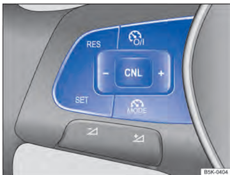
Fig. 150 Lado esquerdo do volante multifunções: botões para comandar o GRA.
