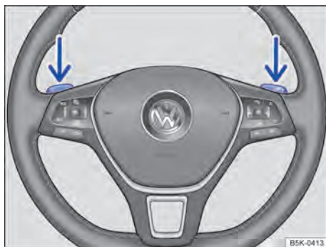
Fig. 128 Volante com 2 seletores basculantes do Tiptronic.
