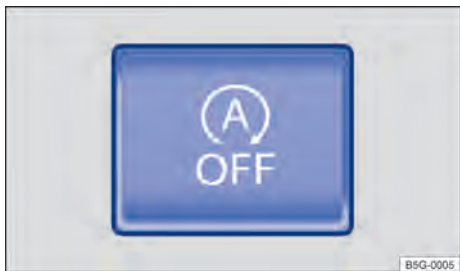
Fig. 135 Na parte inferior do console central: botão do sistema Start-Stop.
