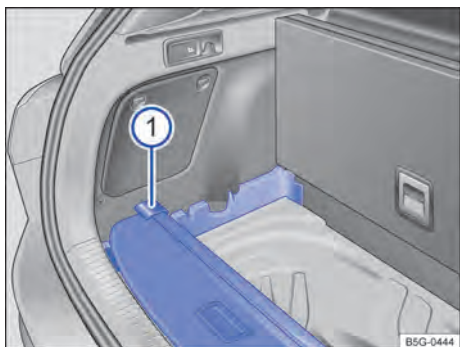
Fig. 94 Embaixo do assoalho do compartimento de bagagem variável: guardar a cobertura do compartimento de bagagem.
