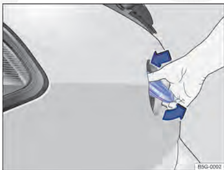
Fig. 33 Abrir a tampa do compartimento de bagagem por fora.
