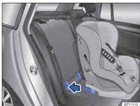
Fig. 75 Representação esquemática: instalar a cadeira de criança ISOFIX com os braços de apoio.
