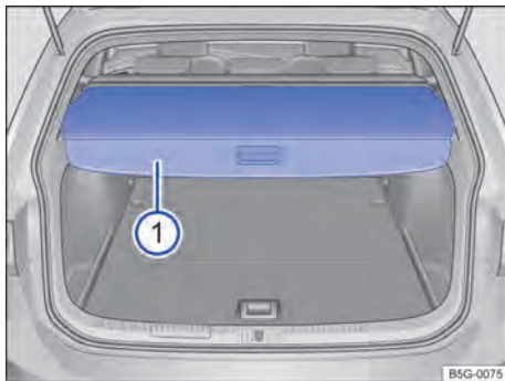
Fig. 92 No compartimento de bagagem: abrir e fechar a cobertura do compartimento de bagagem.
