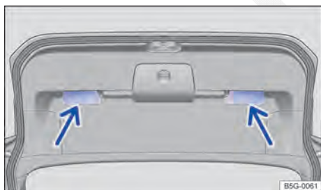
Fig. 34 Tampa do compartimento de bagagem aberta: rebaixos para puxar.
