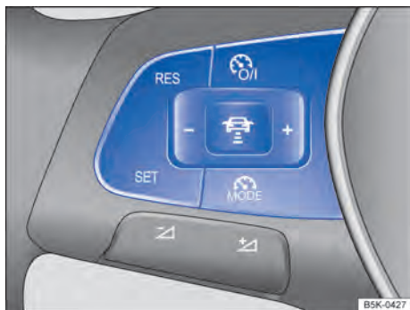
Fig. 157 Lado esquerdo do volante multifunções: botões para comandar a regulagem automática de distância.
