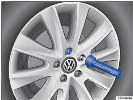
Fig. 215 Troca de roda: remover os parafusos de roda com o punho da chave de fenda.
