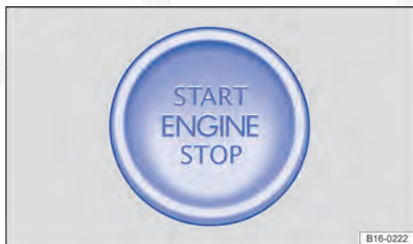
Fig. 120 Na parte inferior do console central: botão de partida do sistema de travamento e de partida Keyless Access.
