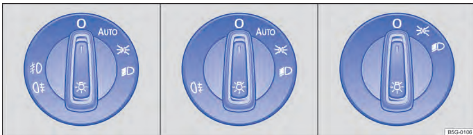
Fig. 78 Ao lado do volante: representação de algumas variantes do interruptor das luzes.
