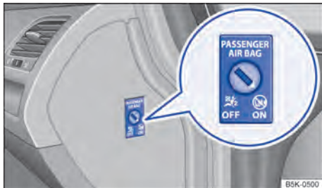
Fig. 67 No painel de instrumentos no lado do passageiro dianteiro: interruptor acionado pela chave para desligar e ligar o airbag frontal do passageiro dianteiro.
