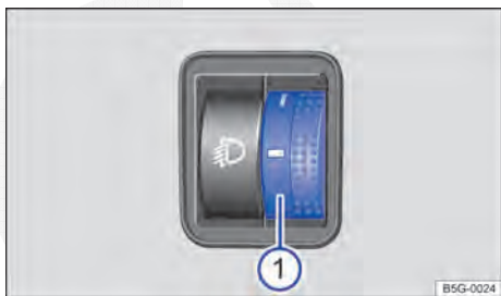
Fig. 79 Ao lado do volante: regulador da regulagem de alcance do farol ①.
