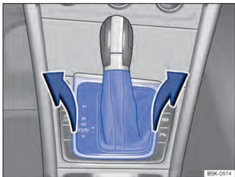
Fig. 198 Desinstalar a cobertura do quadro da alavanca seletora.
