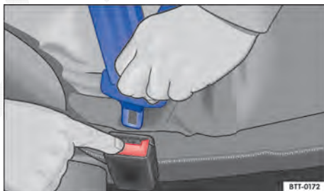
Fig. 60 Soltar a lingueta do cinto de segurança do fecho do cinto de segurança.
