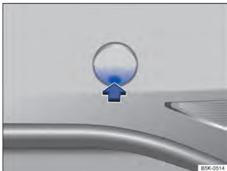
Fig. 231 No para-choque traseiro à direita: remover a cobertura.
