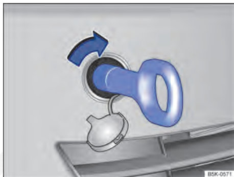
Fig. 230 No para-choque dianteiro à direita: rosquear a argola de reboque.
