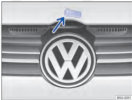
Fig. 173 Pela grade do radiador: alavanca de abertura da tampa do compartimento do motor.
