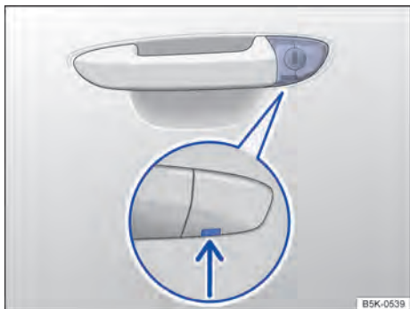
Fig. 193 Maçaneta da porta do condutor: cilindro da fechadura coberto.
