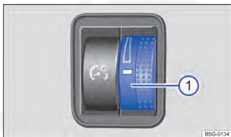
Fig. 80 Ao lado do volante: regulador da iluminação dos instrumentos e dos interruptores ①.
