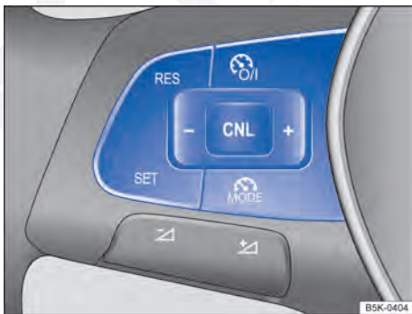
Fig. 153 Lado esquerdo do volante multifunções: botões para comandar o limitador de velocidade. ▶
