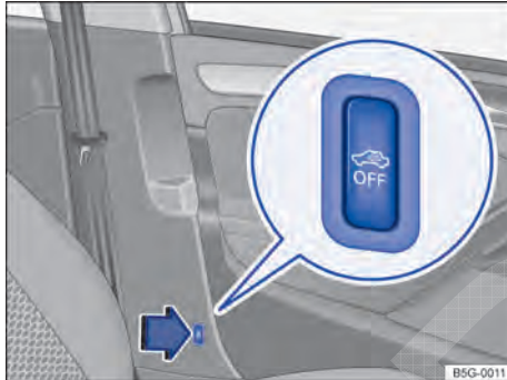
Fig. 65 Ao lado do banco do condutor: botão para desligar o monitoramento do interior do veículo e o alarme antirrebocagem.
