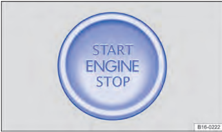
Fig. 121 Na parte inferior do console central: botão de partida do sistema de travamento e de partida Keyless Access.
