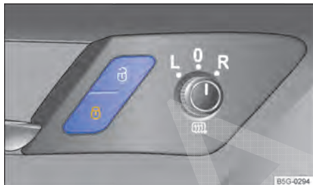
Fig. 62 Na porta do condutor: botão do travamento central.
