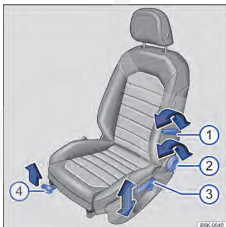
Fig. 84 No banco dianteiro esquerdo: comandos.
