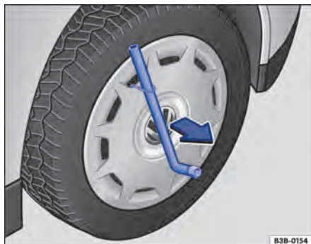
Fig. 241 Retirar a calota integral.
