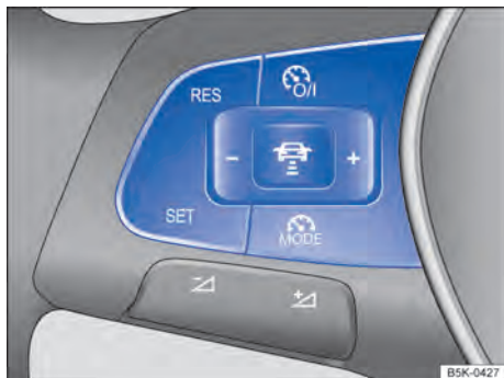
Fig. 139 Lado esquerdo do volante multifunções: botões para comandar a regulação automática de distância.
