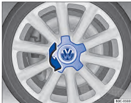
Fig. 240 Virar a calota central.
