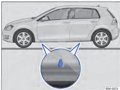
Fig. 245 Pontos de apoio do macaco.
