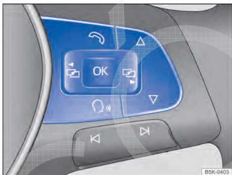
Fig. 51 Lado direito do volante multifunções: botões para comando dos menus e exibições de informação do instrumento combinado.
