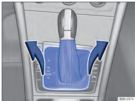
Fig. 80 Desinstalar a cobertura do quadro da alavanca seletora.
