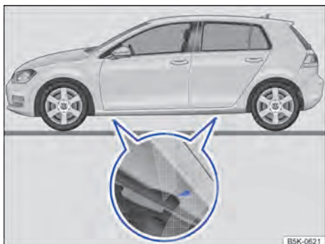
Fig. 247 Pontos de apoio do macaco.
