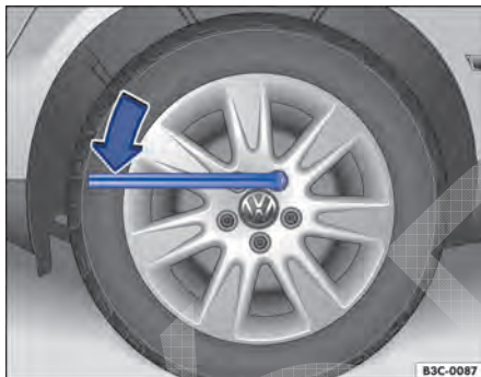
Fig. 243 Troca de roda: soltar os parafusos de roda.
