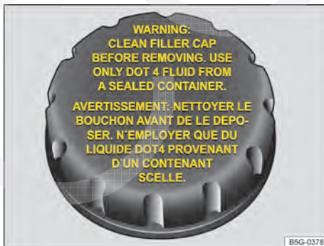
Fig. 226 No compartimento do motor: Tampa do reservatório de fluido de freio (versão 2).
