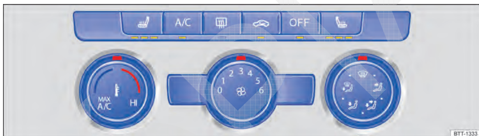
Fig. 112 Na parte superior do console central: Elementos de comando do ar-condicionado manual.
