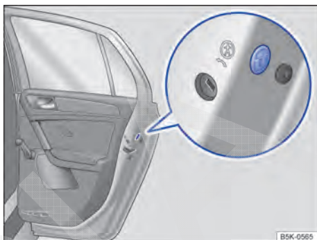
Fig. 76 Na parte dianteira da porta traseira direita: travamento de emergência, coberto por uma vedação de borracha.
