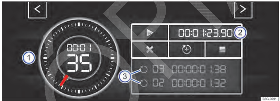
Fig. 54 No sistema Infotainment: Laptimer com cronômetro, superfície de função e tempos de voltas (depende da versão).
