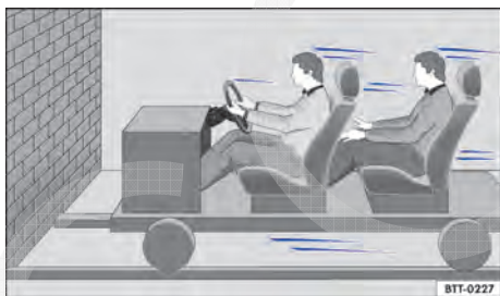
Fig. 4 Um veículo com os ocupantes do veículo sem cintos de segurança está em rota de colisão com um muro.
