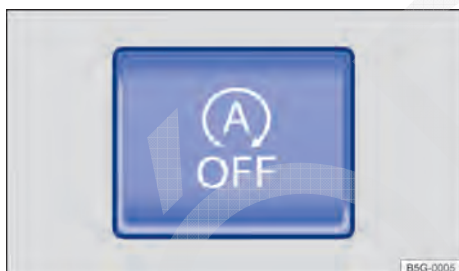
Fig. 123 Na parte inferior do console central: botão do sistema Start-Stop.
