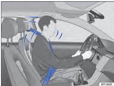
Fig. 8 Conductor protegido pelo cinto de segurança colocado corretamente numa manobra de frenagem súbita.
