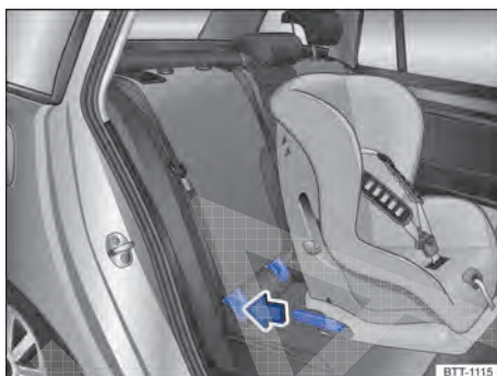
Fig. 27 Representação esquemática: instalar a cadeira de criança ISOFIX com os braços de apoio.
