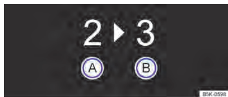
Fig. 117 No display do instrumento combinado: recomendação de marcha.
