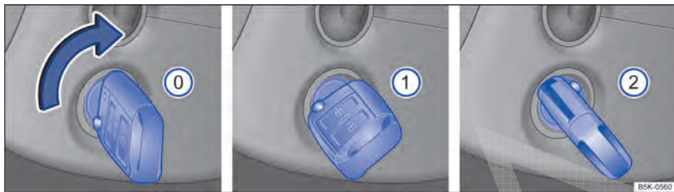
Fig. 120 Posições da chave do veículo no cilindro da ignição.
