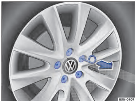
Fig. 242 Remover as capas de cobertura dos parafusos de roda.
