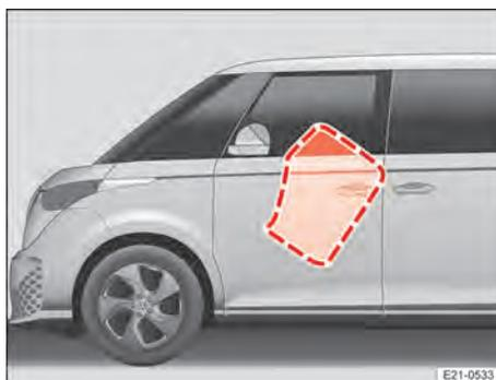
Fig. 27 No lado esquerdo do veículo: áreas de expansão do airbag lateral.
