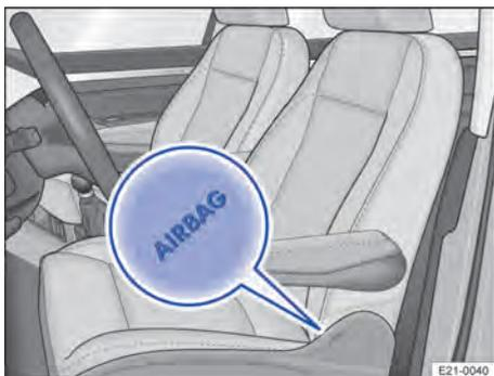
**Fig. 28** Lateralmente no banco dianteiro: local de instalação do airbag lateral.
