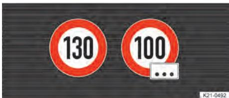
**Fig. 14** No display do instrumento combinado: exemplo para limites de velocidade detectadas com sinais adicionais genéricos.
