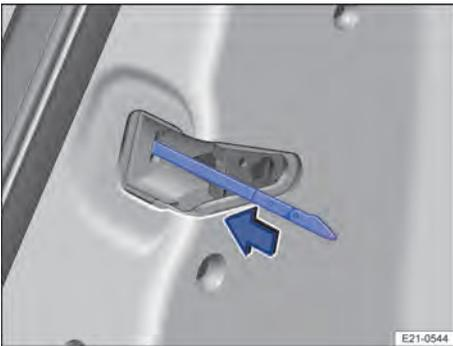
Fig. 51 Travamento de emergência da porta do veículo com a chave de emergência (Variante 2).
