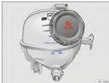
**Fig. 184** No compartimento dianteiro: marcações no reservatório de expansão do líquido de arrefecimento (representação esquemática).
