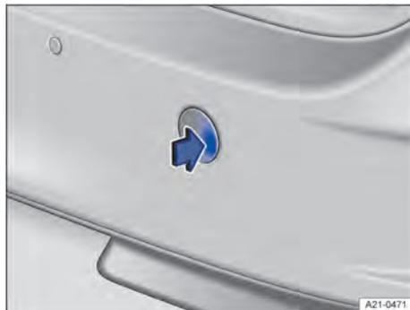
**Fig. 176** No para-choque traseiro à direita: remover cobertura.
