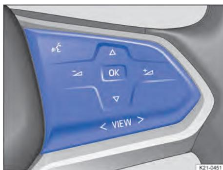
Fig. 9 Lado direito do volante multifunções: botões para comando dos menus e telas de informação do instrumento combinado digital.
