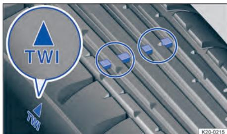
**Fig. 188** Perfil do pneu: indicador de desgaste.
