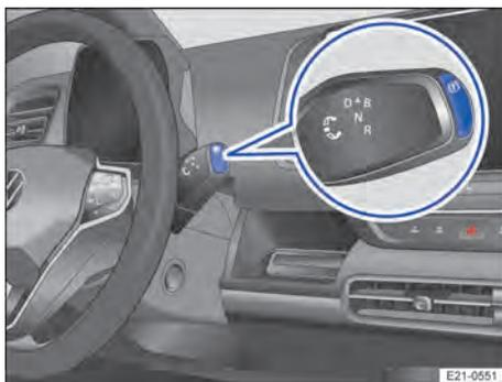
**Fig. 108** No seletor da posição de marcha: botão do freio de estacionamento eletrônico (representação esquemática).
