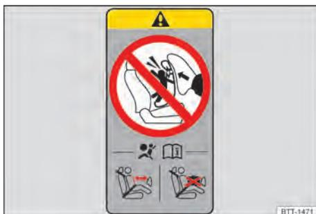
Fig. 33 Representação esquemática: etiqueta do airbag na coluna B.
