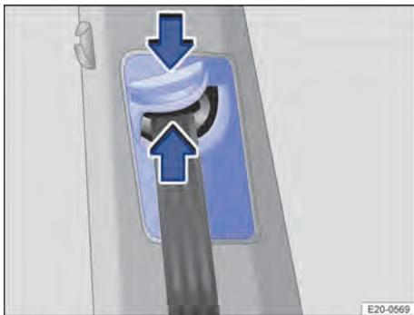
**Fig. 21** Ao lado dos bancos dianteiros: regulagem de altura do cinto de segurança.
