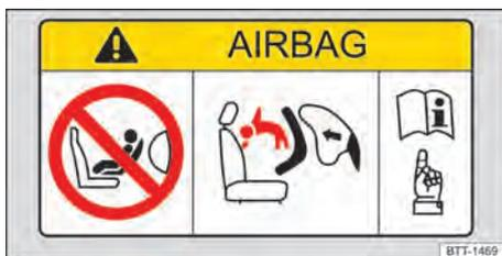
Fig. 32 Representação esquemática: etiqueta do airbag no para-sol.
