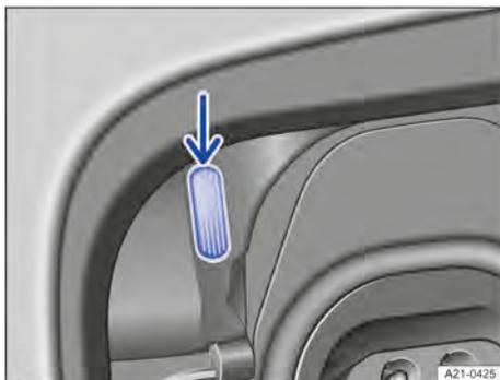
**Fig. 156** Atrás da tampa do carregamento da bateria: indicador do processo de carregamento.
