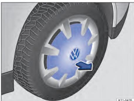
Fig. 191 Retirar a calota integral. (variante 2).
