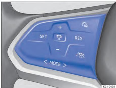
Fig. 100 Lado esquerdo do volante multifunções.
