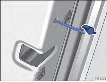
Fig. 50 Travamento de emergência da porta do veículo com a chave de emergência (Variante 1).
