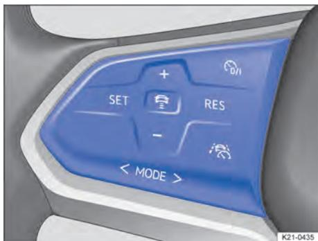
Fig. 105 Lado esquerdo do volante multifunções.
