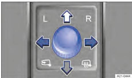
**Fig. 86** Na porta do condutor: botão rotativo dos espelhos retrovisores externos.
