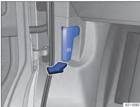
**Fig. 180** Na área para os pés do lado esquerdo: alavanca de destravamento da tampa dianteira (representação esquemática).
