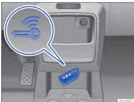
**Fig. 90** Na área inferior do console central: função de partida de emergência (representação esquemática).
