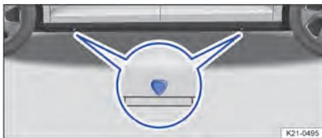
Fig. 196 Pontos de apoio do macaco.
