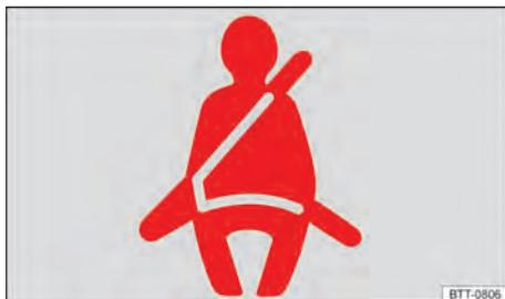
Fig. 16 No display do instrumento combinado: luz de advertência.
