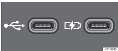
**Fig. 132** Entradas C USB do veículo (representação esquemática).
