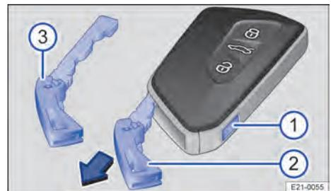
Fig. 41 Chave do veículo: destravamento da chave de emergência.
