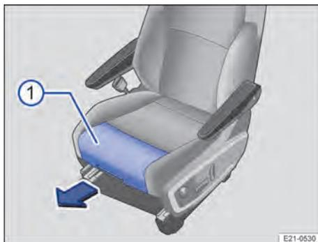
Fig. 62 No banco dianteiro esquerdo: ajuste de profundidade do banco.
