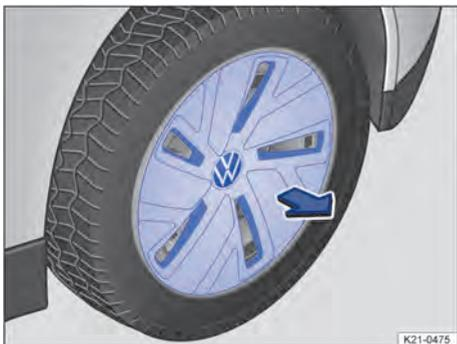
Fig. 190 Retirar a calota integral. (variante 1).
