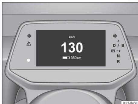
Fig. 8 Instrumento combinado digital no painel de instrumentos (representação esquemática).
