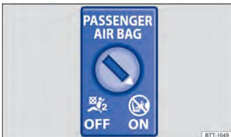
**Fig. 24** No porta-luvas: interruptor acionado pela chave para desligar e ligar o airbag frontal do passageiro dianteiro.
