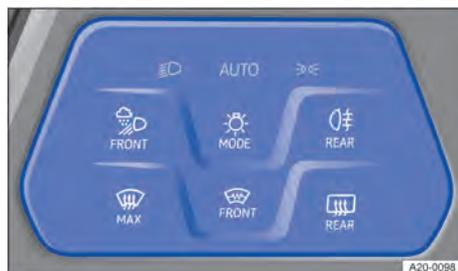
Fig. 78 Ao lado do volante: painel de controle para ligar a iluminação de condução.
