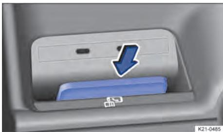
**Fig. 128** Função de carregamento sem fio: bandeja de armazenamento com tapete de revestimento para a função de carregamento sem fio.
