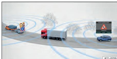
**Fig. 129** Alerta de perigos no trânsito devido a uma obra diurna ou obra móvel (representação esquemática).
