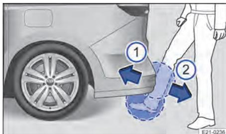
Fig. 55 Tampa traseira com abertura controlada por sensor (Easy Open).
