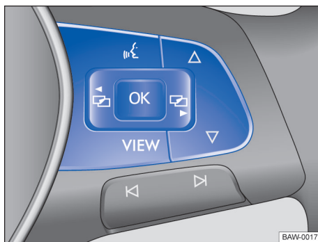
Fig. 20 Lado direito do volante multifunções: botões para comando dos menus e exibições de informação do instrumento combinado.
