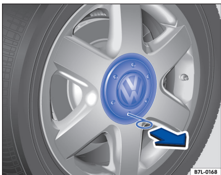
Fig. 173 Retirar a calota central.
