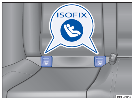
Fig. 43 Identificação dos pontos de ancoragem ISO-FIX para cadeiras de criança (representação esquemática).
