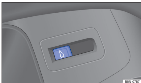
Fig. 61 Na porta do condutor, botão de destravamento da tampa do compartimento de bagagem.
