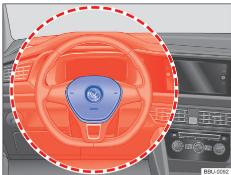
Fig. 34 Local de instalação e área de expansão do airbag frontal do condutor.
