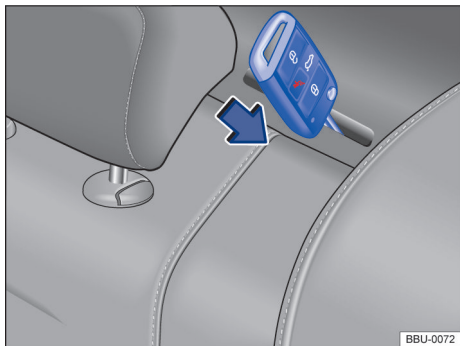
Fig. 63 Atrás do encosto do banco traseiro: destravar emergencialmente o encosto do banco traseiro.
