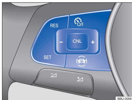
Fig. 114 Lado direito do volante multifunções: botões de comando do limitador de velocidade.
