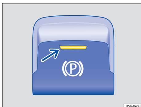
Fig. 122 No console central: botão do freio de estacionamento eletrônico.
