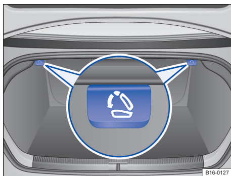
Fig. 71 No compartimento de bagagem: alavanca de destravamento.
