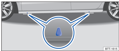
Fig. 179 Pontos de apoio do macaco.
