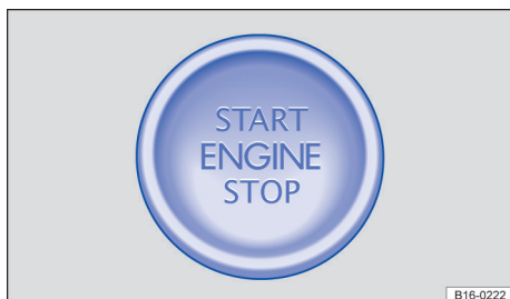
Fig. 100 Na parte inferior do console central: botão de partida para ligar o motor.
