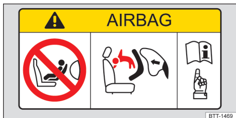
Fig. 41 Representação esquemática: etiqueta de air-bag para-solel.
