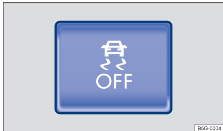
Fig. 129 No console central: botão para desligar e ligar o ASR manualmente.
