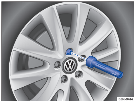
Fig. 183 Troca de roda: : desaparafusar os parafusos de roda com o punho da chave de fenda.
