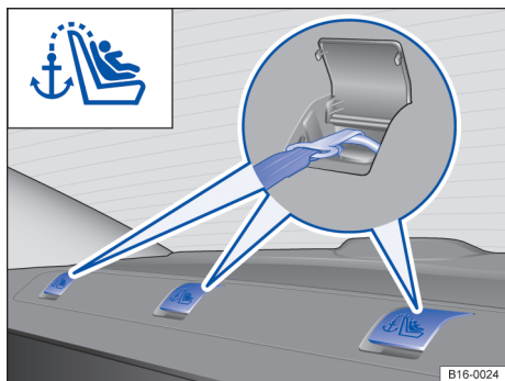
Fig. 45 No porta-objetos atrás do banco traseiro: olhais de suporte para o cinto de fixação superior (Top Tether).
