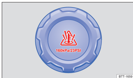
Fig. 163 No compartimento do motor: tampa do reservatório de expansão do líquido de arrefecimento (representação esquemática).
