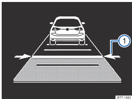
Fig. 119 No display do instrumento combinado: configurar distância (representação esquemática, ACC regulando).
