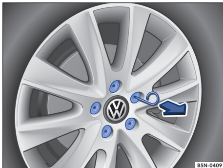
Fig. 176 Remover as capas de cobertura dos parafusos de roda.
