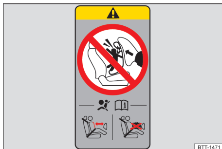
Fig. 42 Representação esquemática: etiqueta de air-bag na coluna B.
