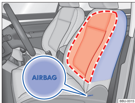
Fig. 38 Lateralmente no banco dianteiro: local de instalação e área de expansão dos airbags laterais.
