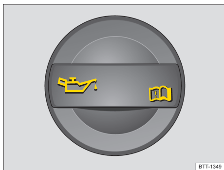
Fig. 161 No compartimento do motor: tampa da abertura para enchimento de óleo do motor (representação esquemática).
