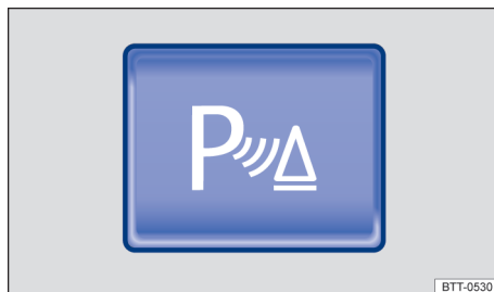
Fig. 124 No console central: botão para ligar e desligar o auxílio de estacionamento (dependendo da versão).
