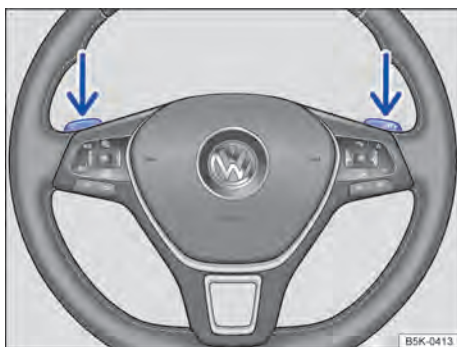
Fig. 93 Volante com seletores basculantes do Tiptronic.
