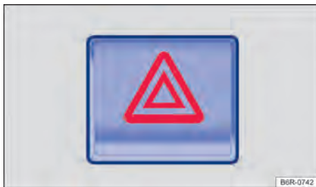
Fig. 46 Na parte superior do console central: interruptor das luzes de advertência.
