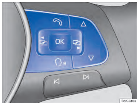
Fig. 19 Lado direito do volante multifunções: botões para comando dos menus e exibições de informação do instrumento combinado.
