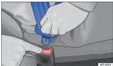
Fig. 30 Soltar a lingueta do cinto de segurança do fecho do cinto de segurança.
