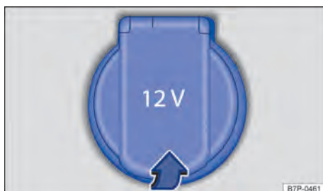
Fig. 107 No console central dianteiro: tomada 12 V.
