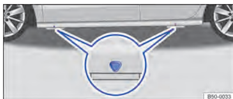
Fig. 201 Pontos de apoio do macaco.
