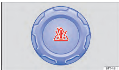
Fig. 189 No compartimento do motor: tampa do reservatório de expansão do líquido de arrefecimento do motor.
