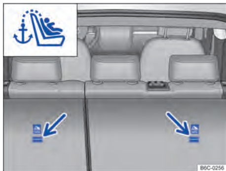
Fig. 45 Olhais de retenção para o cinto de fixação superior no lado de trás do banco traseiro.
