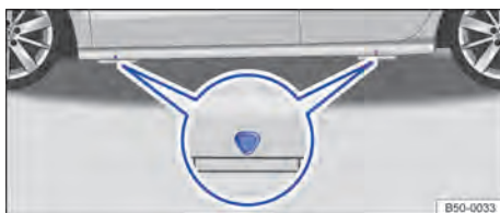
Fig. 202 Pontos de apoio do macaco.
