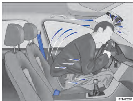
Fig. 28 O condutor sem cinto de segurança é lançado para frente.
