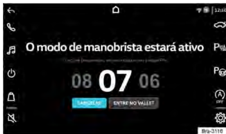
Fig. 150 Ativação do modo manobrista automático.
