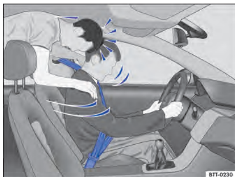
Fig. 29 O passageiro sem cinto de segurança no banco traseiro é lançado para frente sobre o condutor com cinto de segurança.
