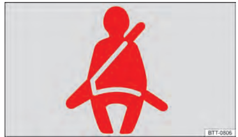
Fig. 24 Luz de advertência no display do instrumento combinado.
