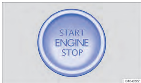
Fig. 92 Na parte inferior do console central: botão de partida para ligar o motor.
