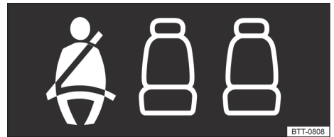
Fig. 25 Indicador de status do cinto de segurança para os assentos traseiros no display do instrumento combinado.
