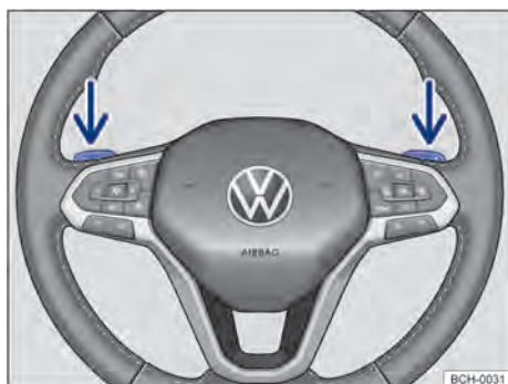
Fig. 97 Volante com seletores basculantes do Tiptronic.
