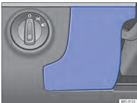
Fig. 173 No lado do condutor do painel de instrumentos: cobertura da caixa de fusíveis.
