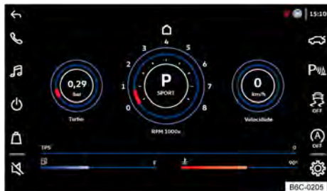
Fig. 21 No display do rádio: monitor de dados do veículo.
