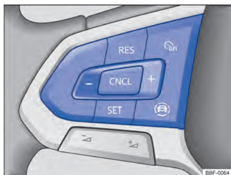
Fig. 99 Lado esquerdo do volante multifunções: botões para comandar o GRA.
