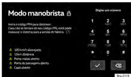
Fig. 151 Tela de bloqueio do modo manobrista.
