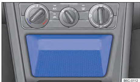
Fig. 104 Na parte inferior do console central: porta-objetos.
