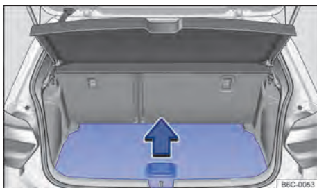
Fig. 153 No compartimento de bagagem: levantar o assoalho do compartimento de bagagem.
