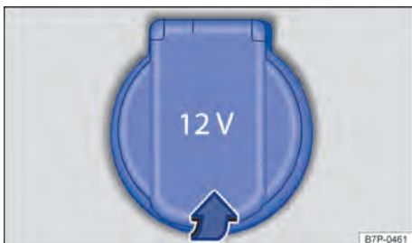
Fig. 112 No console central dianteiro: tomada 12 V.
