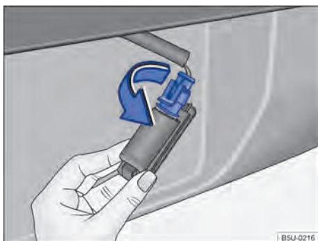
Fig. 188 Lanterna da placa de licença: remover o soquete da lâmpada.
