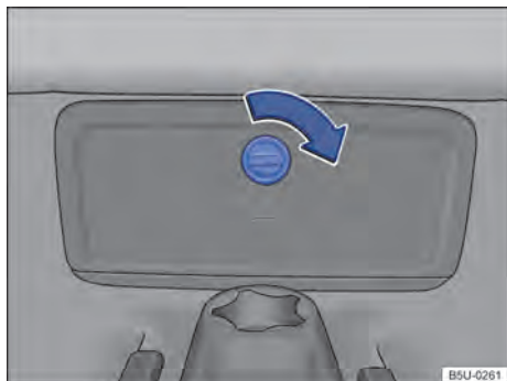
Fig. 171 No assoalho do banco traseiro: acesso à caixa de fixação das ferramentas de bordo.
