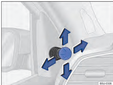
Fig. 74 Nas portas dianteiras: interruptor de ajuste dos espelhos retrovisores externos mecânicos.
