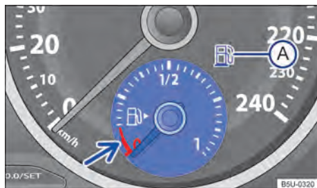
Fig. 13 No instrumento combinado: indicador do nível de combustível (variante 2).
