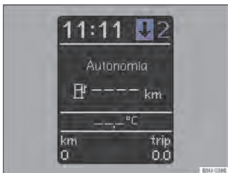
Fig. 83 No instrumento combinado: indicador de troca de marcha (variante 2).
