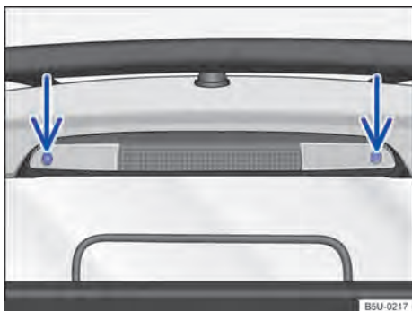
Fig. 189 No compartimento de carga: remover a lanterna de freio elevada.
