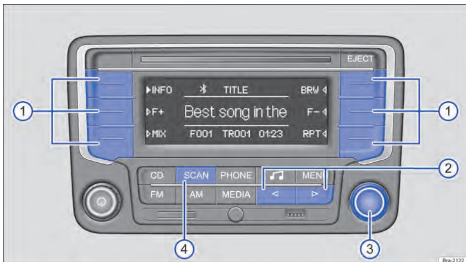
Fig. 154 Exemplo de exibição na operação de mídia: exibição do local de armazenamento de um MP3 na troca de faixa.
