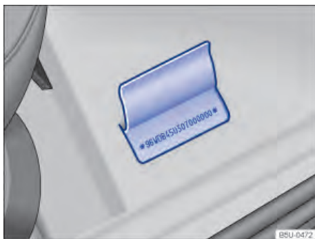
Fig. 224 Em frente ao banco do passageiro: número de identificação do veículo (número do chassi) no assoalho, em frente ao banco do passageiro dianteiro.
