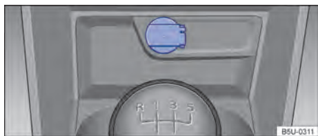
Fig. 112 No console central dianteiro: tomada 12 V.
