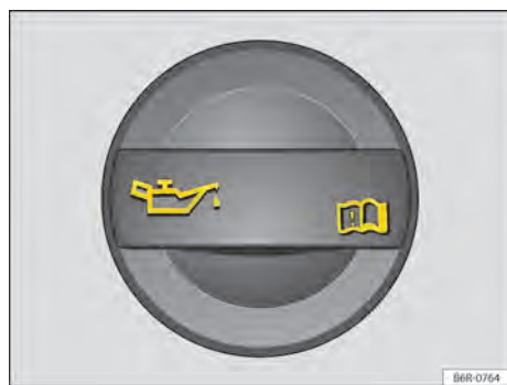
Fig. 203 No compartimento do motor: tampa da abertura para enchimento de óleo do motor.
