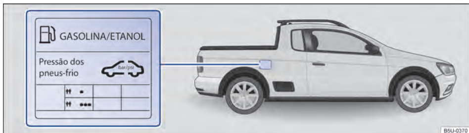
Fig. 211 Na parte interna da portinhola do tanque de combustível: etiqueta com a pressão dos pneus.
