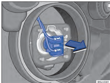
Fig. 181 Acesso à lâmpada incandescente do farol baixo.
