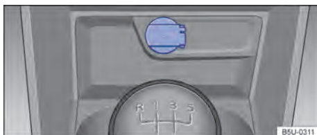
Fig. 110 No console central dianteiro: tomada 12 V.
