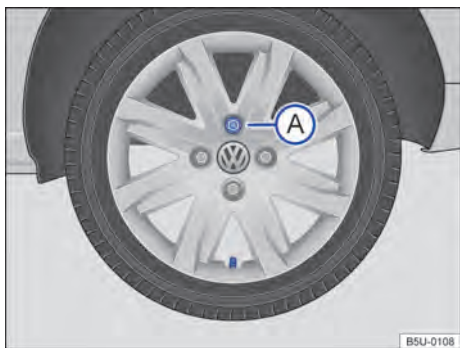
Fig. 221 Troca de roda: sequência de remoção dos parafusos da roda.
