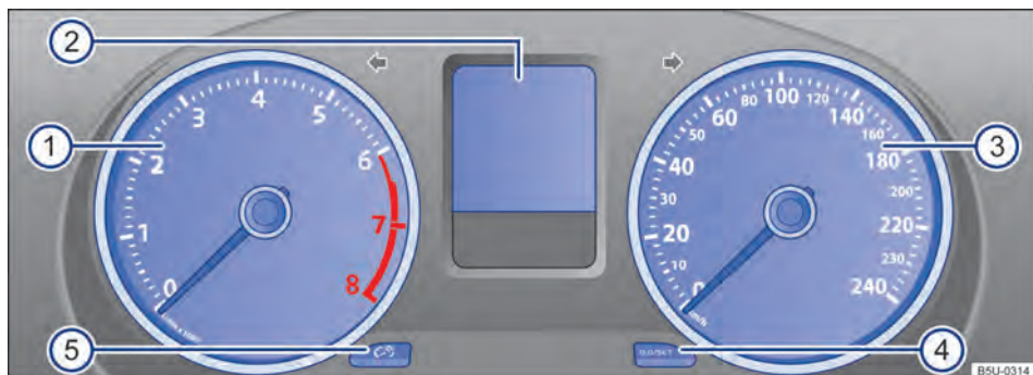
Fig. 10 Instrumento combinado no painel de instrumentos (variante 1).
