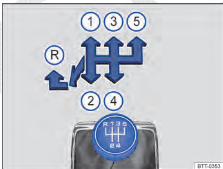
Fig. 111 Esquema de troca da transmissão manual de 5 marchas.
