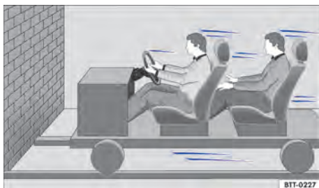
Fig. 49 Um veículo com os ocupantes sem cintos de segurança está em rota de colisão com um muro.
