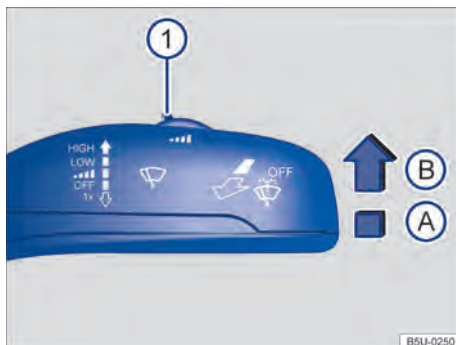
Fig. 73 Ao lado do volante: alavanca dos limpadores dos vidros: regular a sensibilidade do sensor de chuva ①.
