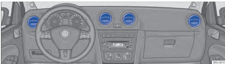
Fig. 125 Difusores de ar no painel de instrumentos.
