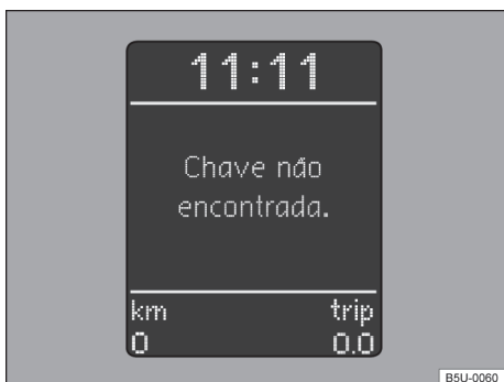
Fig. 109 No instrumento combinado: display com indicação do imobilizador ativado - veículos com Sistema de Informações Volkswagen.
