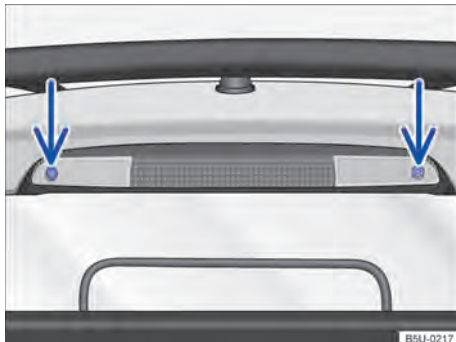
Fig. 198 No compartimento de carga: remover a lanterna de freio elevada.
