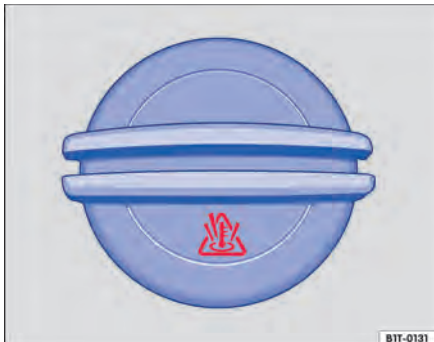
Fig. 135 No compartimento do motor: tampa do reservatório do líquido de arrefecimento do motor.
