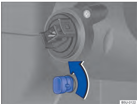
Fig. 181 Soquete da lâmpada incandescente da luz de posição.
