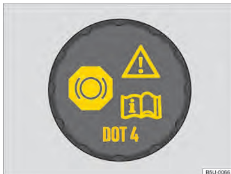
Fig. 114 No compartimento do motor: tampa do reservatório de fluido do freio.
