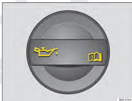
Fig. 132 No compartimento do motor: tampa da abertura de enchimento de óleo do motor.
