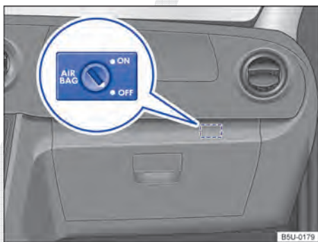
Fig. 63 No porta-luvas: interruptor desacionado pela chave para desligar e ligar o airbag frontal do passageiro.
