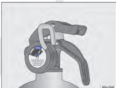
Fig. 154 No extintor de incêndio: indicador de carga (manômetro).
