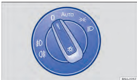
Fig. 67 No painel: interruptor giratório das luzes.
