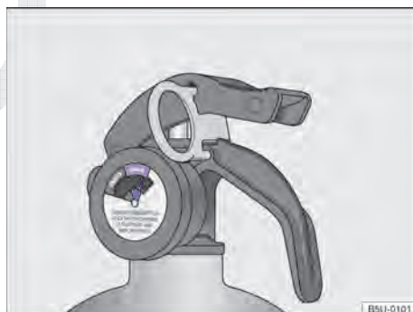
Fig. 155 No extintor de incêndio: indicador de carga (manômetro).
