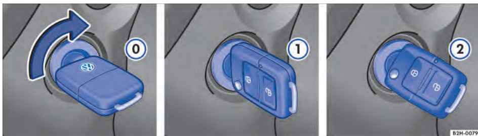
Fig. 108 Ao lado do volante, à direita: posições da chave do veículo no cilindro da ignição.
