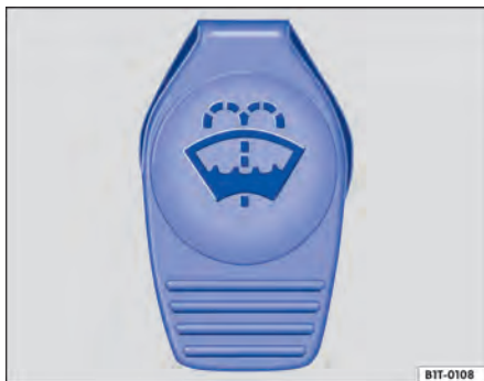
Fig. 75 No compartimento do motor: tampa do reservatório de água dos lavadores do para-brisa.
