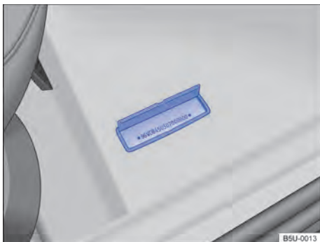
Fig. 18 Em frente ao banco do passageiro dianteiro: número de identificação do veículo (número do chassi) no assoalho, em frente ao banco do passageiro.
