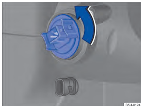
Fig. 183 Soquete da lâmpada incandescente do indicador de direção dianteiro.
