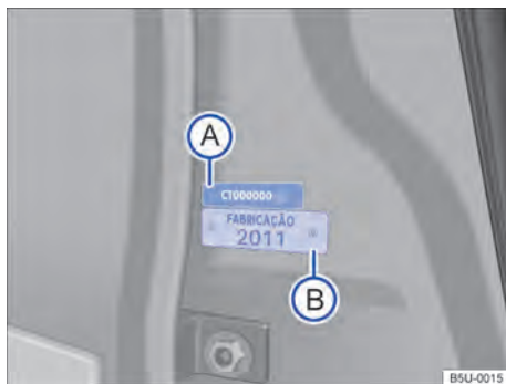
Fig. 19 Na coluna da porta dianteira direita: etiqueta com o número de identificação do veículo parcial (A) e etiqueta de identificação do ano de fabricação (B).
