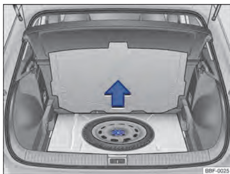
Fig. 124 No compartimento de bagagem, sob o revestimento de assoalho: roda de emergência e ferramentas de bordo.
