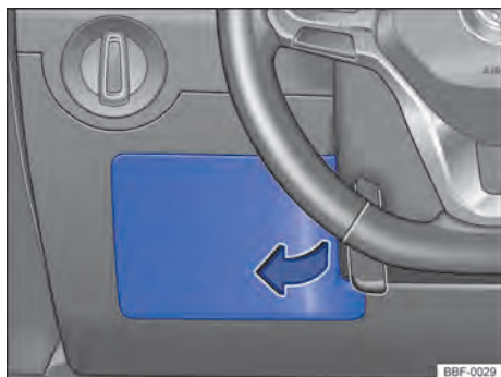
Fig. 134 No lado do condutor do painel de instrumentos: cobertura da caixa de fusíveis.
