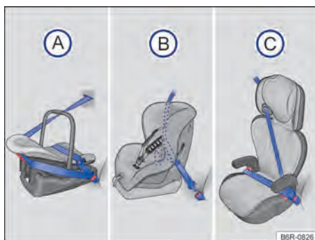
Fig. 40 As ilustrações (A), (B) e (C) mostram a fixação do sistema de retenção para crianças apenas com o cinto de segurança do veículo.
