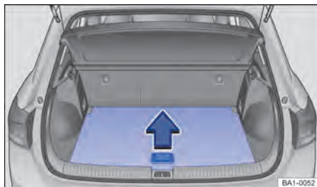
Fig. 119 No compartimento de bagagem: levantar o assoalho do compartimento de bagagem.
