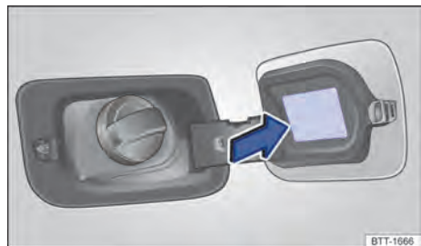
Fig. 158 Na parte interna da portinhola do tanque de combustível: etiqueta com a pressão dos pneus.
