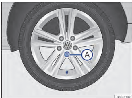
Fig. 166 Troca de roda: sequência de remoção dos parafusos da roda.
