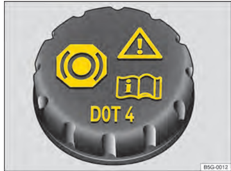
Fig. 153 No compartimento do motor: tampa do reservatório de fluido de freio.
