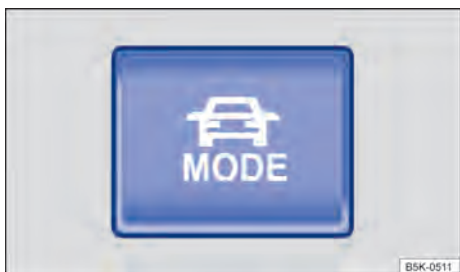
Fig. 100 Na parte superior do console central: botão de seleção do perfil de condução.
