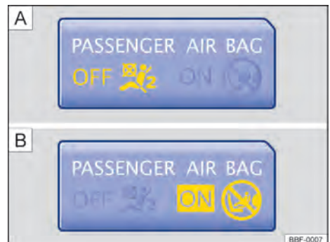
Fig. 33 Na parte superior do console central: luz de controle para o airbag frontal do passageiro dianteiro desligado [A] ou luz de controle para o airbag frontal do passageiro dianteiro ligado [B]. ▶
