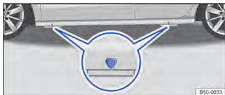
Fig. 164 Pontos de apoio do macaco.
