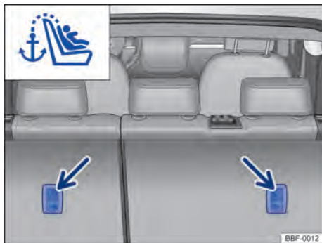
Fig. 43 Olhais de retenção para o cinto de fixação superior no lado de trás do banco traseiro.
