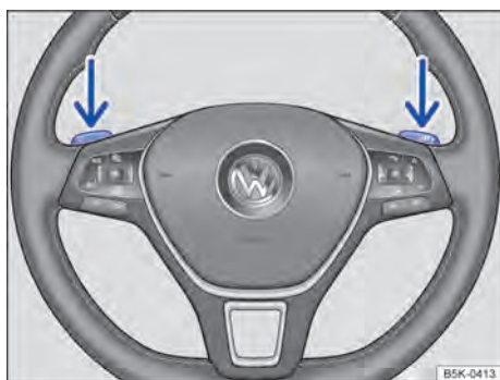
Fig. 98 Volante com seletores basculantes do Tiptronic.
