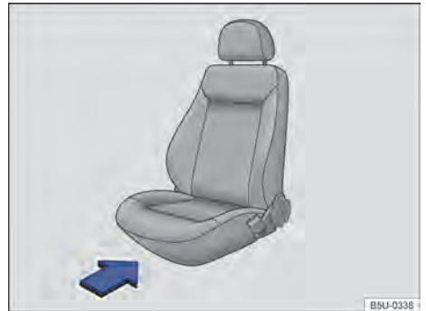
Fig. 48 Na parte frontal do banco do passageiro dianteiro: localização para instalação do suporte do extintor de incêndio.
