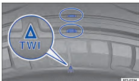
Fig. 159 Perfil do pneu: indicadores de desgaste.
