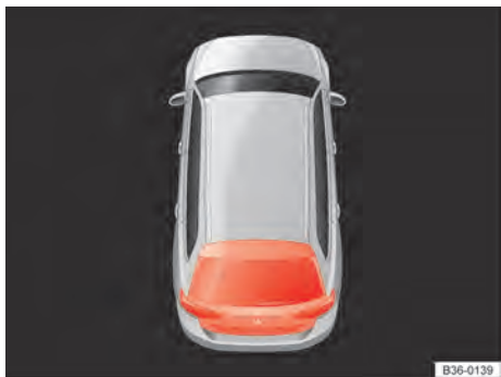
Fig. 49 No display do instrumento combinado: tampa do compartimento de bagagem aberta ou fechada incorretamente.
