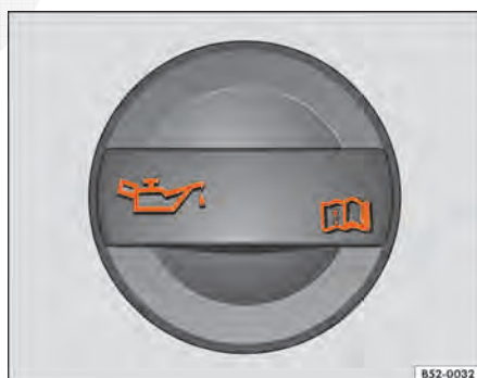
Fig. 250 No compartimento do motor: tampa da abertura para enchimento de óleo do motor.
