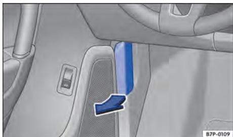
Fig. 247 No área para os pés no lado do condutor: alavanca de destravamento da tampa do compartimento do motor. Em veículos com direção à direita, a disposição dos elementos é espelhada.
