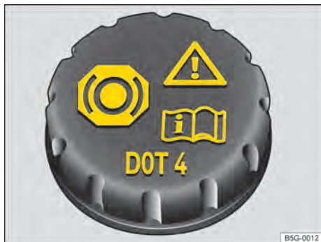
Fig. 172 No compartimento do motor: tampa do reservatório do fluido de freio.
