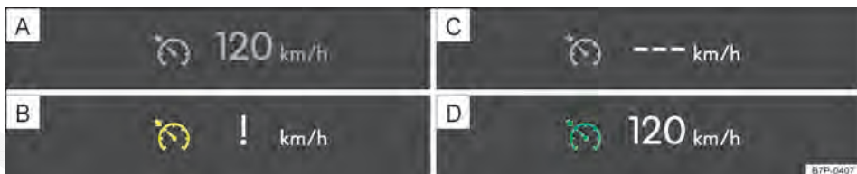
Fig. 202 No display do instrumento combinado: indicadores de status do GRA.
