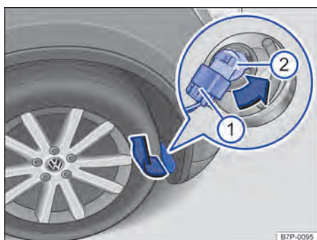
Fig. 296 Na moldura da caixa de roda dianteira direita: substituir a lâmpada incandescente no farol.
