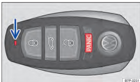
Fig. 38 Luz de controle da chave do veículo.
