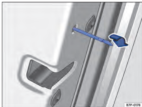
Fig. 272 Travamento de emergência do veículo com a chave de emergência.
