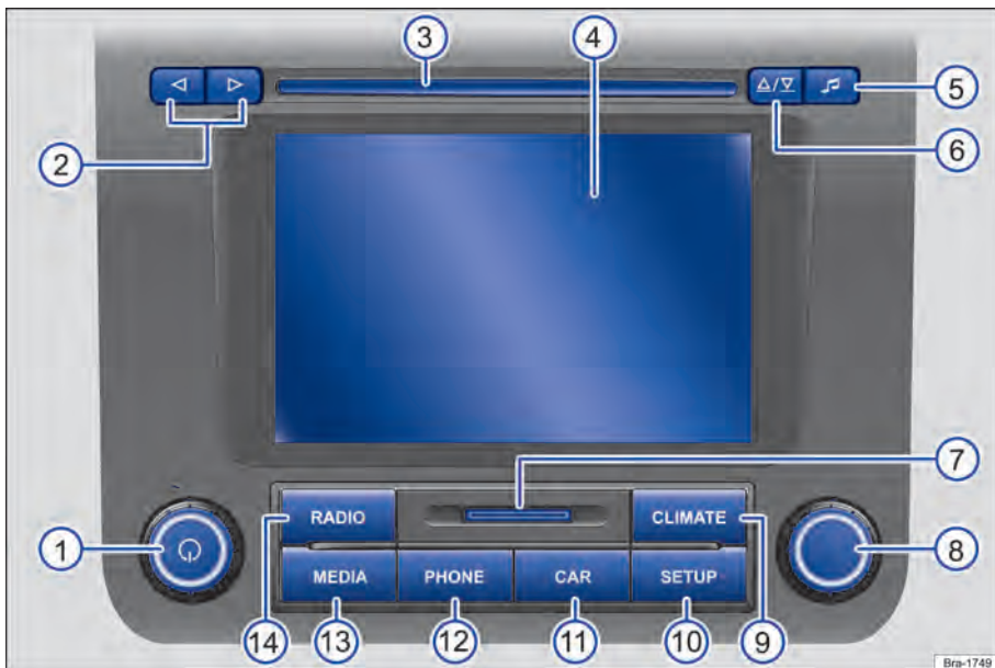
Fig. 21 Vista geral dos comandos do RCD 550.
