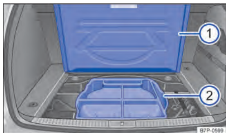
Fig. 235 Compartimento de bagagem com peça de plástico e reservatório de AdBlue.
