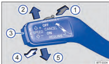
Fig. 207 À esquerda da coluna da direção: alavanca de comando do controle automático de distância.
