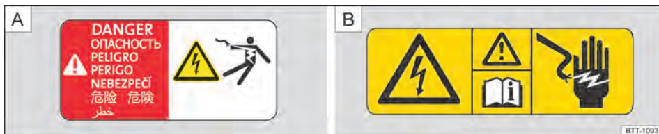
Fig. 185 A) Placa de advertência do componente de alta tensão. B) Placa de advertência de alta tensão.
