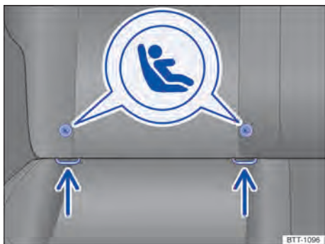
Fig. 105 No banco do veículo: identificação dos pontos de ancoragem ISOFIX para cadeiras de criança.
