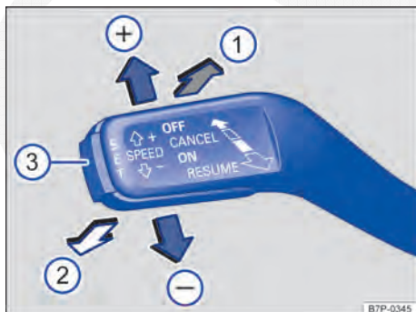
Fig. 203 À esquerda na coluna da direção: alavanca de comando do GRA.
