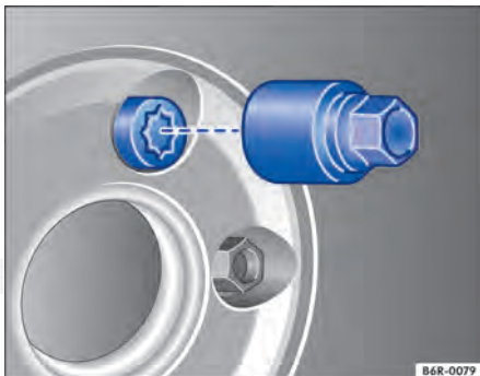
Fig. 281 Troca de roda: Parafusos de roda antifurto e adaptador.
