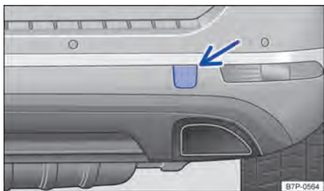
Fig. 307 No para-choque traseiro à direita: capa de cobertura para o alojamento da argola de reboque.
