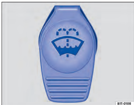
Fig. 121 No compartimento do motor: tampa do reservatório de água dos lavadores dos vidros.
