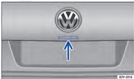
Fig. 51 Na tampa do compartimento de bagagem: botão para abrir a tampa do compartimento de bagagem.
