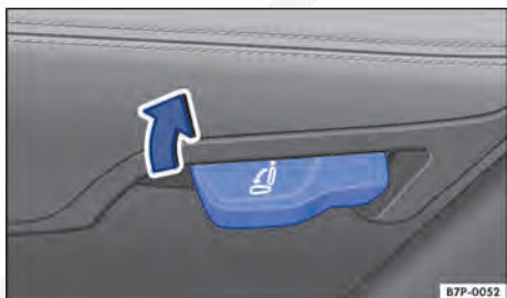
Fig. 79 Parte inferior do banco traseiro: alavanca de destravamento do encosto do banco traseiro esquerdo. Lado direito simetricamente.
