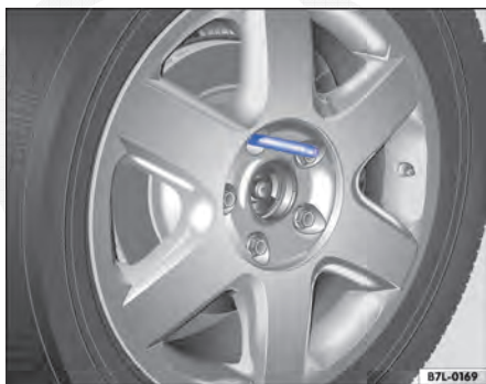
Fig. 286 Troca de roda: pino de montagem no furo superior.
