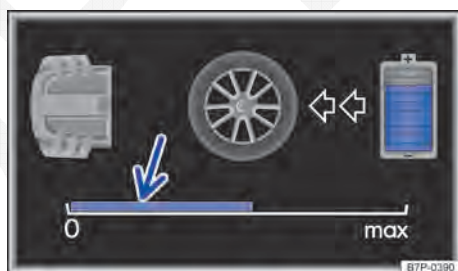
Fig. 180 Display no instrumento combinado: indicação da performance elétrica atual.
