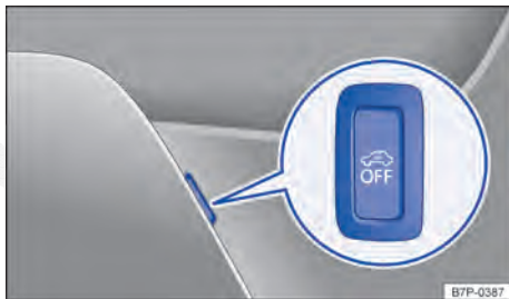
Fig. 46 No revestimento da porta do condutor: botão de desligamento do monitoramento do interior e do alarme antirrebocagem.
