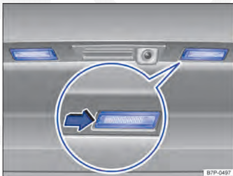
Fig. 301 Na tampa do compartimento de bagagem: lanterna da placa de licença.
