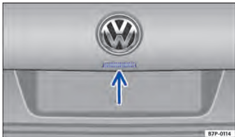
Fig. 53 Na tampa do compartimento de bagagem: botão para abrir a tampa do compartimento de bagagem.
