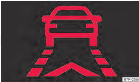
Fig. 211 No display do instrumento combinado: exibição do alerta antecipado.
