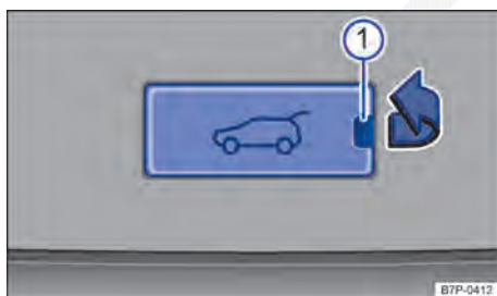
Fig. 273 Por fora do compartimento de bagagem: cobertura na região central na área inferior do revestimento interno da tampa do compartimento de bagagem.
