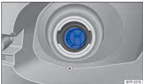
Fig. 234 Com a portinhola do tanque aberta: proteção contra abastecimento errado no bocal de abastecimento do tanque.
