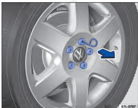
Fig. 278 Remover as capas de cobertura dos parafusos de roda.
