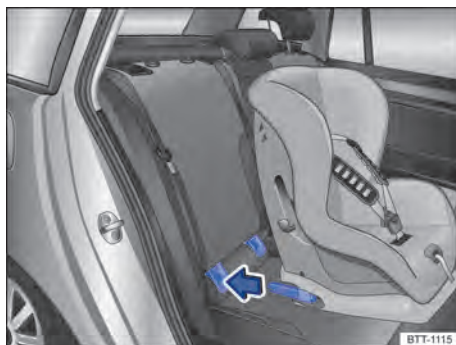
Fig. 106 Representação esquemática: instalar a cadeira de criança ISOFIX com os braços de apoio.
