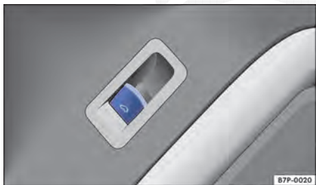
Fig. 50 Na porta do condutor: botão para destravar a tampa do compartimento de bagagem.
