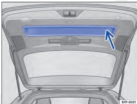
Fig. 52 Tampa do compartimento de bagagem aberta: rebaixo para puxar a tampa do compartimento de bagagem.
