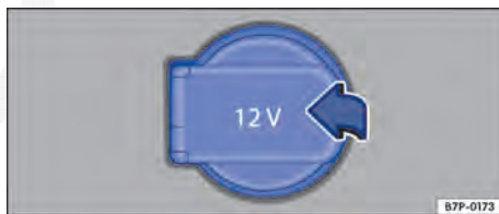
Fig. 290 No porta-objetos abaixo do descanso-braço central dianteiro: tomada de 12 V para conexão do compressor (variante 2)
