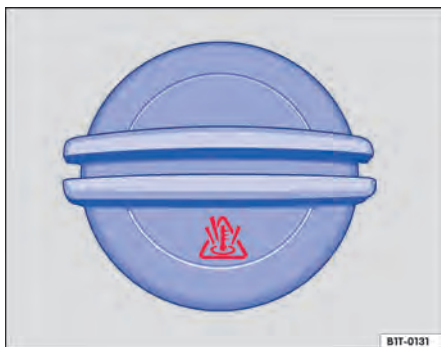
Fig. 253 No compartimento do motor: tampa do reservatório de expansão do líquido de arrefecimento do motor.
