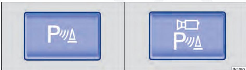
Fig. 190 Na parte superior do console central: variantes do botão para ligar ou desligar o controle de distância de estacionamento.
