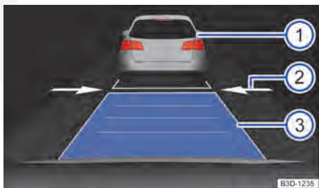
Fig. 204 No display do instrumento combinado: regulagem de distância ativa: veículo adiante reconhecido, nível de distância (grande) em um nível regulado.
