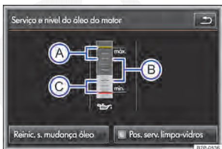
Fig. 249 Indicação do display do sistema Infotainment: indicação do nível do óleo do motor.
