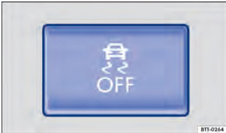
Fig. 171 No console central: botão para ligar e desligar manualmente a função ASR ou do programa eletrônico de estabilidade (ESC).
