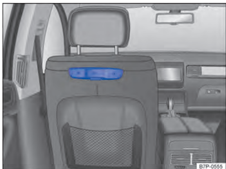
Fig. 162 No lado de trás do banco do condutor: alojamento para o Rear Seat Entertainment.
