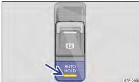
Fig. 173 Na parte inferior do console central: botão da função Auto Hold.
