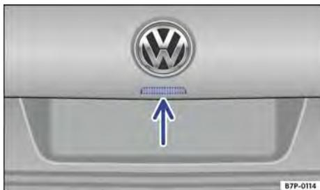
**Fig. 86** Na tampa do compartimento de bagagem: botão de abertura da tampa do compartimento de bagagem.
