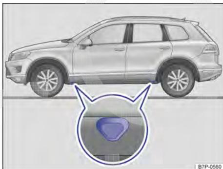
Fig. 283 Pontos de apoio do macaco.
