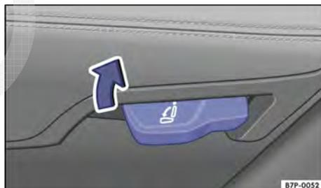
**Fig. 102** Parte inferior do banco traseiro: alavanca de destravamento do encosto do banco traseiro esquerdo. Lado direito simetricamente.
