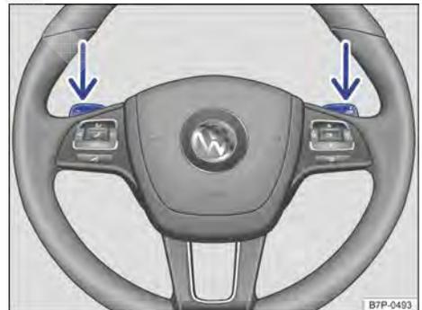
Fig. 141 Atrás do volante: seletores basculantes para o Tiptronic.
