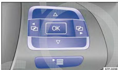
**Fig. 53** Lado direito do volante multifunções: botões para comandar os menus do instrumento combinado.
