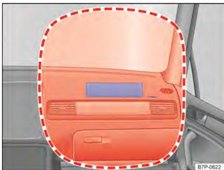
**Fig. 16** Local de instalação e área de expansão do airbag frontal do passageiro dianteiro.
