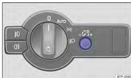
Fig. 114 Ao lado do volante: regulador da regulagem da iluminação dos instrumentos e dos interruptores. ▶
