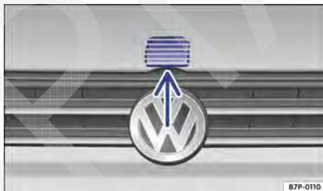
Fig. 254 Pela grade do radiador: alavanca de abertura da tampa do compartimento do motor.
