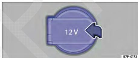
Fig. 289 No porta-objetos embaixo do apoio de braços (descansa-braço) central dianteiro: tomada de 12 V para conexão do compressor (variante 2)
