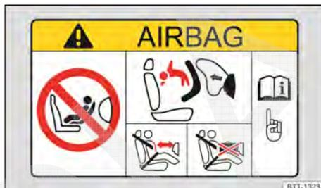
Fig. 24 Representação esquemática: etiqueta de air-bag no para-sol.
