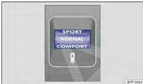
**Fig. 145** Na parte inferior do console central: regulador da regulagem da suspensão.
