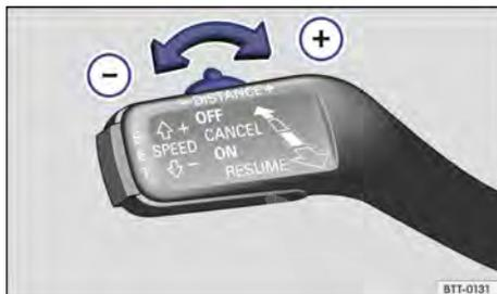
Fig. 162 À esquerda da coluna da direção: ajustar a distância do controle automático de distância.
