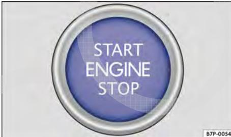
**Fig. 137** Sistema de travamento e de partida Keyless Access sem chave: botão de partida.
