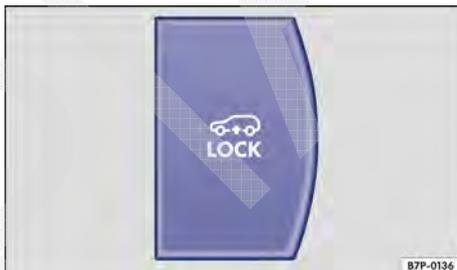
**Fig. 280** Na parte inferior do console central: botão Lock.
