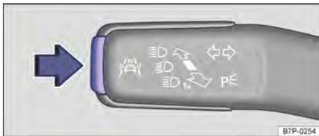
**Fig. 54** Na alavanca dos indicadores de direção e do farol alto: botão dos sistemas de assistência ao condutor.
