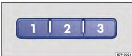
**Fig. 95** No revestimento do teto dianteiro: botões do comando de abertura de portão de garagem.
