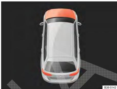
**Fig. 255** Representação esquemática no display do instrumento combinado: tampa do compartimento do motor aberta ou fechada incorretamente.
