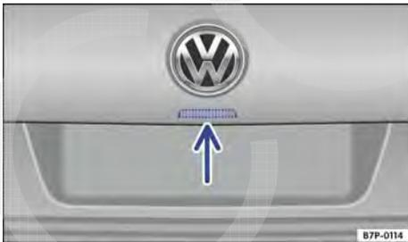
**Fig. 88** Na tampa do compartimento de bagagem: botão de abertura da tampa do compartimento de bagagem.
