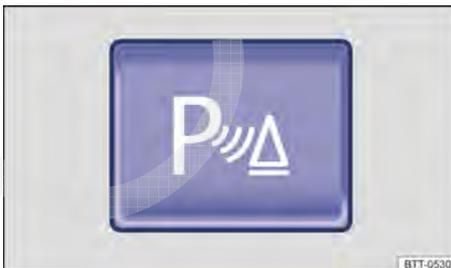
**Fig. 174** Na parte superior inferior do console central: botão para ligar ou desligar o controle de distância de estacionamento.
