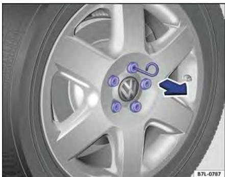
Fig. 279 Remover as capas de cobertura dos parafusos de roda.
