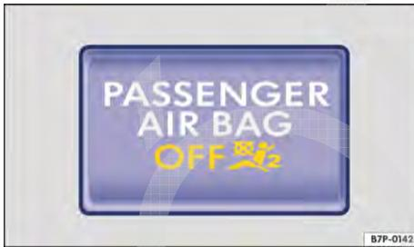
Fig. 14 Na parte superior do console central: luz de controle para o airbag frontal do passageiro dianteiro desligado.
