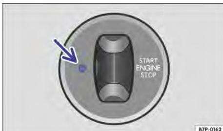
Fig. 72 Cilindro da ignição: destramento de emergência da chave do veículo.
