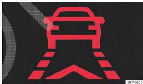
**Fig. 165** No display do instrumento combinado: exibição do alerta antecipado.
