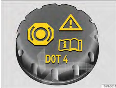
**Fig. 261** No compartimento do motor: tampa do reservatório do fluido de freio.
