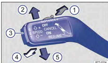
Fig. 161 À esquerda da coluna da direção: alavanca de comando do controle automático de distância.
