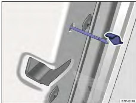
**Fig. 83** Na parte dianteira da porta traseira direita: travamento de emergência do veículo com a chave de emergência.
