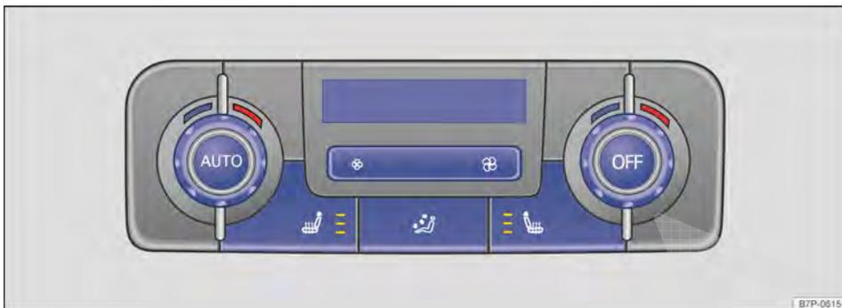
**Fig. 129** No console central traseiro: comandos do Climatronic.
