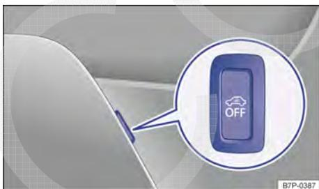
**Fig. 78** Na porta do condutor: botão para desligar o monitoramento do interior do veículo e do alarme antirrebocagem.
