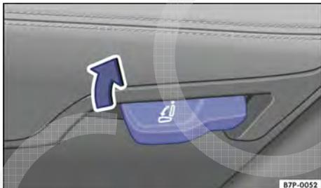
**Fig. 101** Área lateral esquerda no banco traseiro: alavanca para ajustar a inclinação do encosto do banco.
