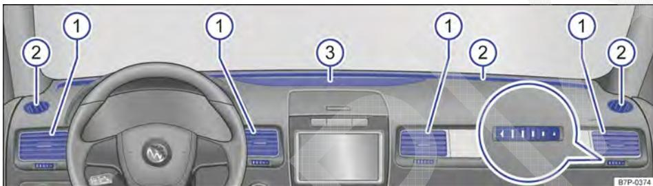
**Fig. 130** No painel de instrumentos: difusores de ar.
