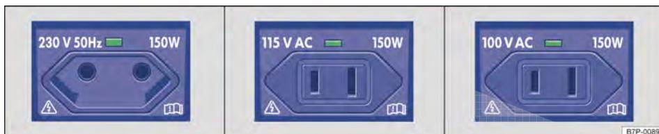
Fig. 203 Na parte traseira do console central: tomada 230 V (padrão euro), tomada 115 V ou tomada 100 V.
