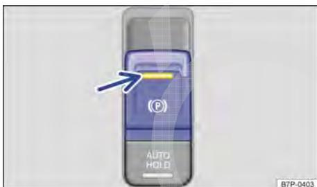
**Fig. 172** Na parte inferior do console central: botão do freio de estacionamento eletrônico.
