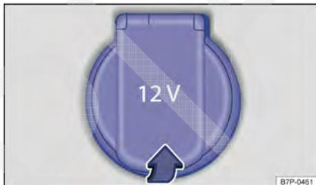
Fig. 202 No porta-objetos no painel de instrumentos: abrir a tomada 12 V.
