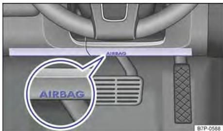
Fig. 21 No lado do condutor: local de instalação do airbag para joelhos.
