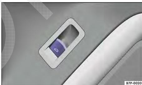
**Fig. 85** Na porta do condutor: botão de destravação da tampa do compartimento de bagagem.
