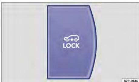
**Fig. 144** Na parte inferior do console central: botão Lock do limitador de velocidade.
