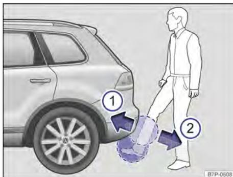
**Fig. 77** Sistema de travamento e de partida Keyless Access sem chave: Tampa do compartimento de bagagem com abertura controlada por sensor (Easy Open).
