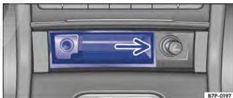
Fig. 198 No console central dianteiro: remover o cinzeiro.
