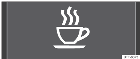
Fig. 15 No display do instrumento combinado: símbolo do sistema de reconhecimento de cansaço.
