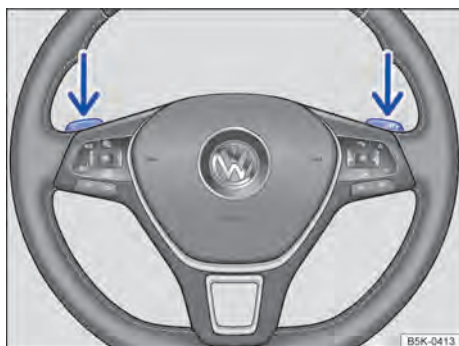
Fig. 94 Volante com seletores basculantes do Tiptronic.
