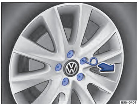
Fig. 198 Remover as capas de cobertura dos parafusos de roda.
