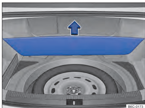
Fig. 164 No compartimento de bagagem, sob o revestimento de assoalho: roda de emergência e ferramentas de bordo.
