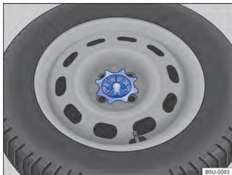
Fig. 195 No compartimento de bagagem: manípulo para fixação da roda de emergência.
