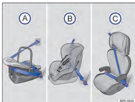
Fig. 41 As ilustrações (A), (B) e (C) mostram a fixação do sistema de retenção para crianças apenas com o cinto de segurança do veículo.
