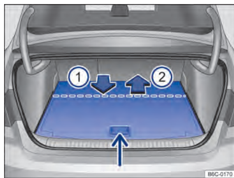
Fig. 158 No compartimento de bagagem: ajustar a altura do assoalho variável do compartimento de bagagem.
