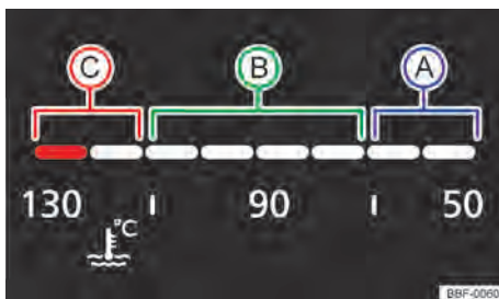
Fig. 14 Indicador de temperatura do líquido de arrefecimento do motor no instrumento combinado digital (variante 2): (A) área fria; (B) área normal; (C) área de alerta.
