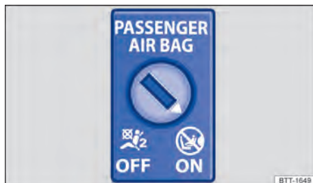
Fig. 37 No painel de instrumentos no lado do passageiro dianteiro: interruptor acionado pela chave para desligar e ligar o airbag frontal do passageiro dianteiro.
