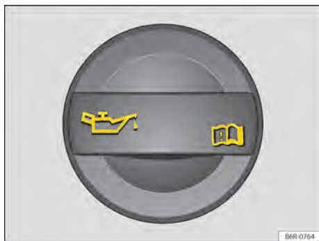
Fig. 185 No compartimento do motor: tampa da abertura para enchimento de óleo do motor.
