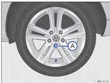
Fig. 202 Troca de roda: seqüência de remoção dos parafusos da roda.
