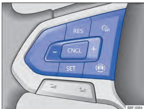
Fig. 98 Lado esquerdo do volante multifunções (variante 2); botões para comandar o limitador de velocidade.
