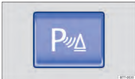
Fig. 105 No console central ou no display do rádio: botão para ligar e desligar o auxílio de estacionamento.
