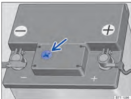
Fig. 189 No compartimento do motor: exemplo de posição do visor no lado superior da bateria do veículo.
