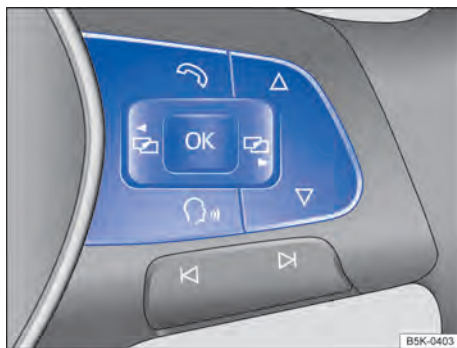
Fig. 18 Lado direito do volante multifunções: botões para comando dos menus e exibições de informação do instrumento combinado.
