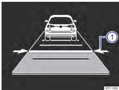
Fig. 103 No display do instrumento combinado: ajustar a distância (representação esquemática, o ACC regula).
