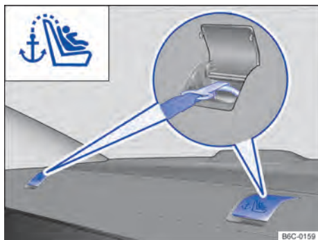
Fig. 44 Olhais de retenção para o cinto de fixação superior na cobertura do compartimento de bagagem.
