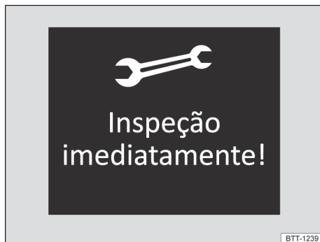
Fig. 16 No display do instrumento combinado: exemplo de indicação para um evento de serviço próximo de vencer (representação esquemática).
