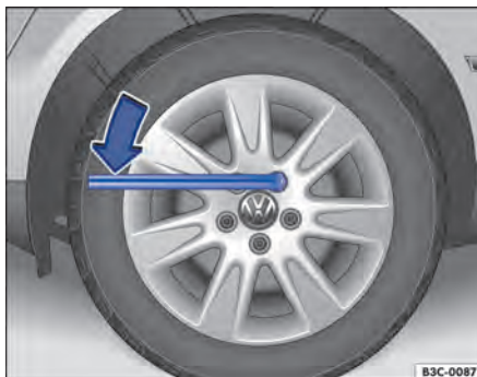
Fig. 199 Troca de roda: soltar os parafusos da roda.
