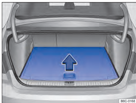
Fig. 157 No compartimento de bagagem: levantar o assoalho variável do compartimento de bagagem.
