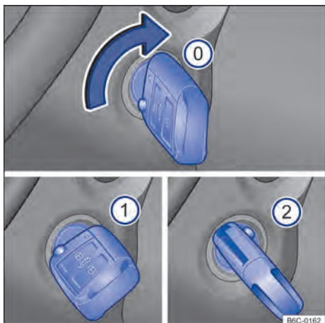
Fig. 88 Ao lado do volante, à direita: posições da chave do veículo no cilindro da ignição.
