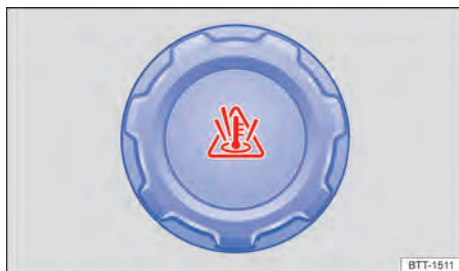
Fig. 187 No compartimento do motor: tampa do reservatório de expansão do líquido de arrefecimento do motor.
