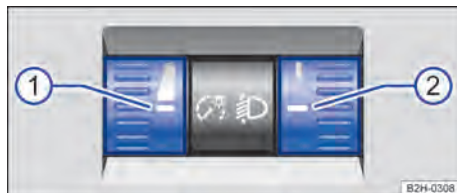
Fig. 79 Ao lado do volante: regulador da iluminação dos instrumentos e dos interruptores ① assim como regulagem de alcance do farol ②.
