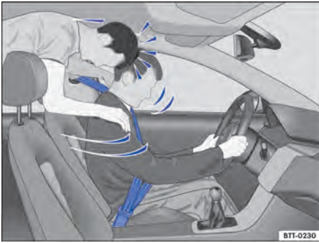
Fig. 54 O passageiro sem cinto de segurança no banco traseiro é lançado para frente sobre o condutor com cinto de segurança.
