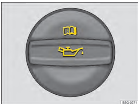
Fig. 150 No compartimento do motor: tampa da abertura para enchimento de óleo do motor (representação esquemática).
