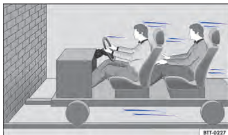
Fig. 51 Um veículo com os ocupantes do veículo sem cintos de segurança está em rota de colisão com um muro.
