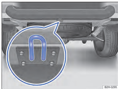
Fig. 210 Abaixo do para-choque: argola de reboque em veículos sem dispositivo de reboque de fábrica.
