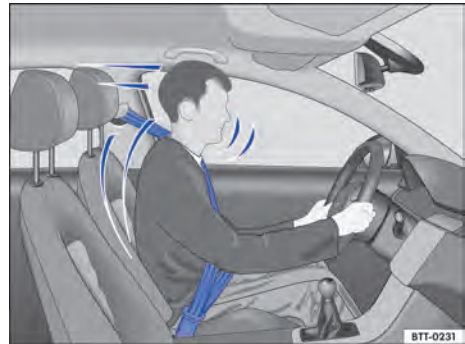
Fig. 55 Condutor protegido pelo cinto de segurança colocado corretamente em uma manobra de frenagem súbita.
