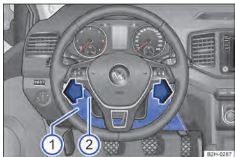
Fig. 190 Caixa de fusíveis atrás do revestimento do painel de instrumentos ①.
