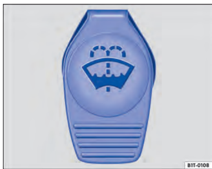
Fig. 87 No compartimento do motor: tampa do reservatório de água dos lavadores do para-brisa.
