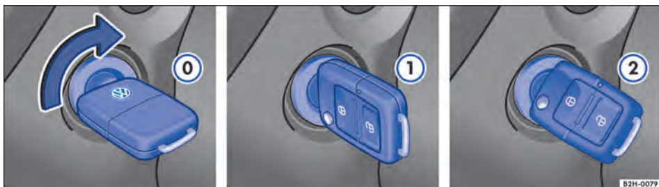
Fig. 109 Posições da chave do veículo no cilindro da ignição.
