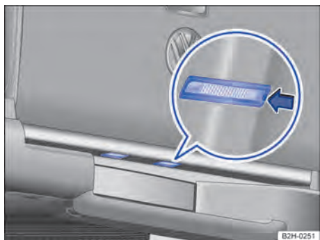
Fig. 199 Na chapa terminal traseira embaixo da tampa do compartimento de carga: lanternas da placa de licença.
