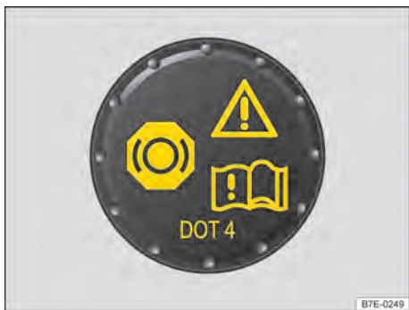
Fig. 118 No compartimento do motor: tampa do reservatório do fluido de freio.
