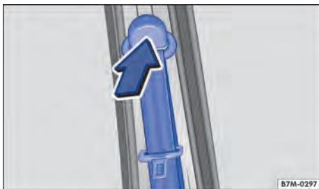
Fig. 64 Ao lado dos bancos dianteiros: regulagem de altura do cinto de segurança.
