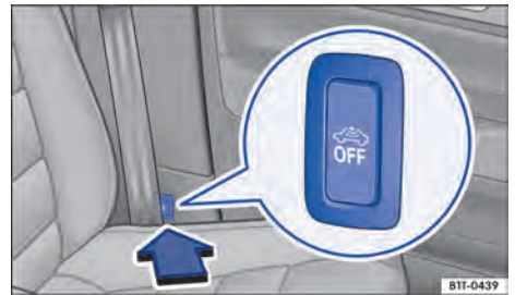
Fig. 21 Ao lado do banco do condutor na coluna B: botão para desligar o monitoramento do interior do veículo e o alarme antirrebocagem.
