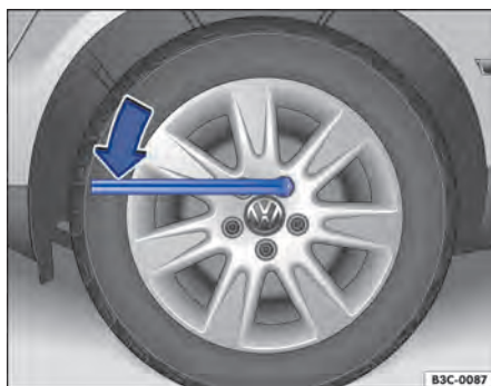
Fig. 180 Troca de roda: soltar os parafusos de roda.
