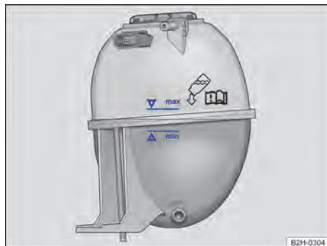
Fig. 152 No compartimento do motor: marcações no reservatório de expansão do líquido de arrefecimento (representação esquemática).
