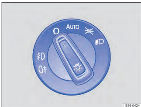
Fig. 78 Ao lado do volante: interruptor de luzes (uma variante).
