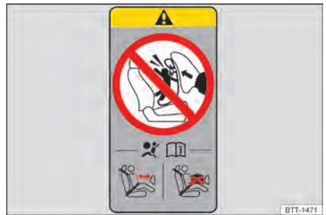
Fig. 72 Etiqueta do airbag na coluna B (representação esquemática).
