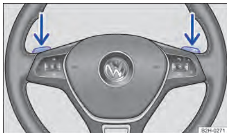
Fig. 115 Volante com seletores basculantes do Tiptronic.
