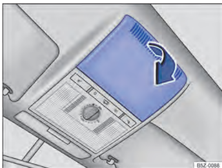
Fig. 60 No revestimento do teto: remover a cobertura.
