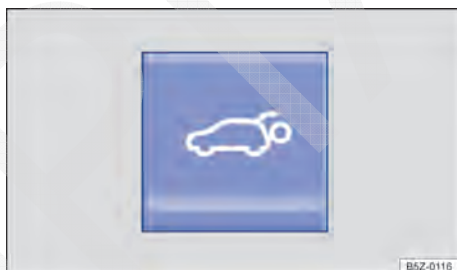
Fig. 54 Na parte superior do console central: interruptor de destravamento do suporte da roda de emergência para abertura da tampa traseira.
