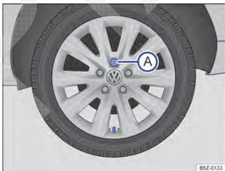
Fig. 174 Retirar a calota integral.
