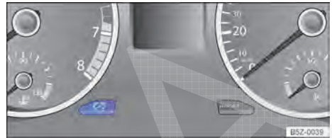
Fig. 73 No instrumento combinado: botão de regulação da iluminação dos instrumentos e dos interruptores.
