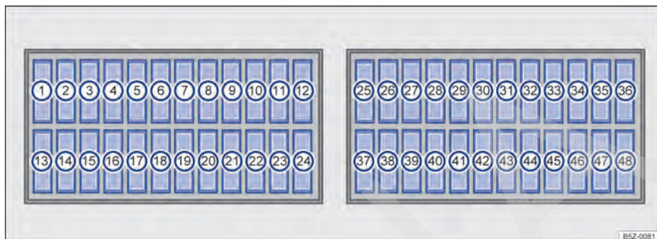
Fig. 147 Caixa de fusíveis.
