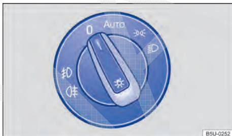
Fig. 71 No painel: interruptor das luzes.
