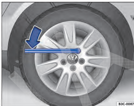
Fig. 176 Troca de roda: soltar os parafusos da roda.
