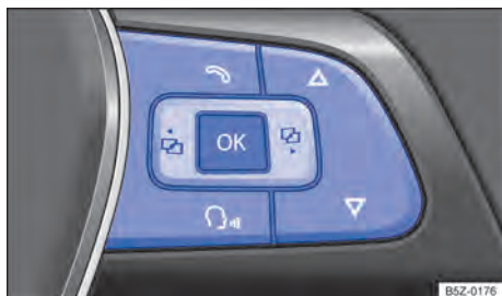
Fig. 39 Lado direito do volante multifunções: teclas de comando dos menus do instrumento combinado.
