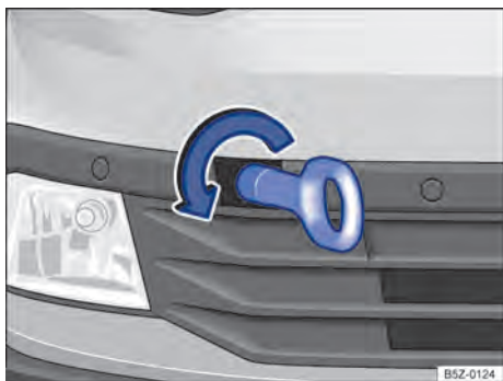
Fig. 154 No para-choque dianteiro à direita: rosquear a argola de reboque.
