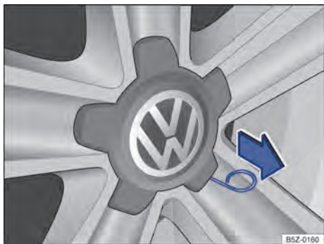
Fig. 175 Retirar a calota central da roda de emergência.
