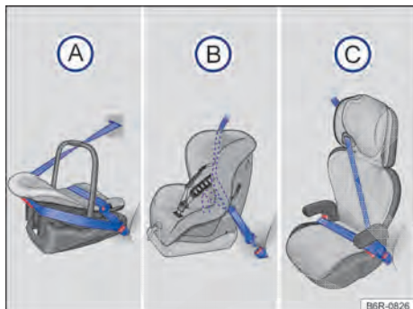
Fig. 17 As ilustrações (A), (B) e (C) mostram a fixação do sistema de retenção para crianças apenas com o cinto de segurança do veículo.
