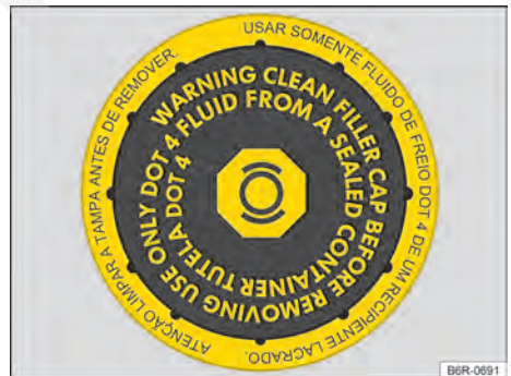
Fig. 163 No compartimento do motor: tampa do reservatório de fluido de freio (variante 1).
