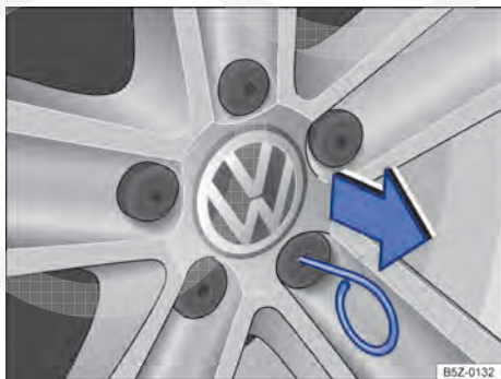
Fig. 173 Retirar as capas de cobertura dos parafusos da roda.
