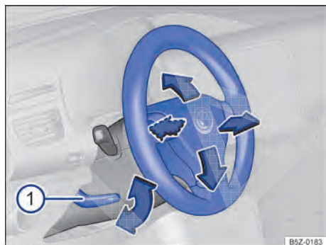
Fig. 62 Ajustar a posição do volante mecanicamente.
