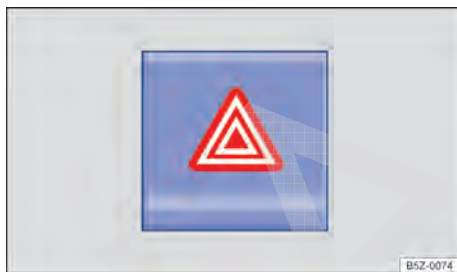
Fig. 20 Na parte superior do console central: interruptor para ligar e desligar as luzes de advertência.
