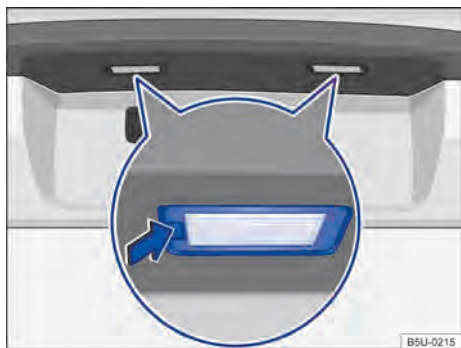
Fig. 143 No para-choque traseiro: remover a lanterna da placa de licença.
