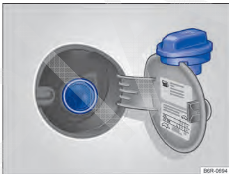
Fig. 128 Portinhola do tanque de combustível aberta com a tampa do tanque de combustível pendurada.
