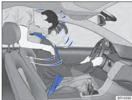
Fig. 7 O passageiro sem cinto de segurança no banco traseiro é lançado para frente sobre o condutor com cinto de segurança.
