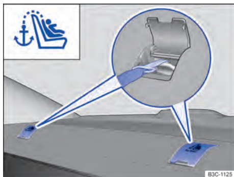
Fig. 8 No porta-objetos atrás dos bancos traseiros: olhal de retenção do Top Tether.
