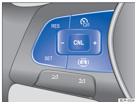
Fig. 142 Lado esquerdo do volante multifunções: botões para comandar o GRA.
