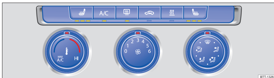
Fig. 118 Na parte superior do console central: comandos do painel de comando do ar-condicionado manual.
