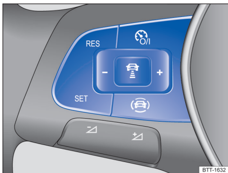
Fig. 148 Lado esquerdo do volante multifunções: botões para comandar o ACC.
