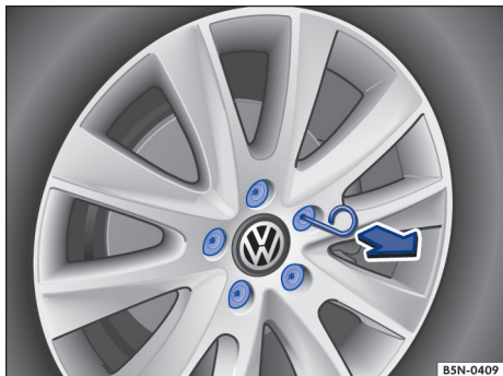
Fig. 259 Remover as capas de cobertura dos parafusos de roda.
