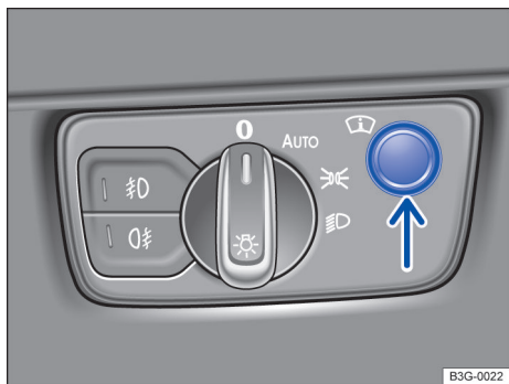
Fig. 16 Ao lado do volante: regulador do head-up display (seta).
