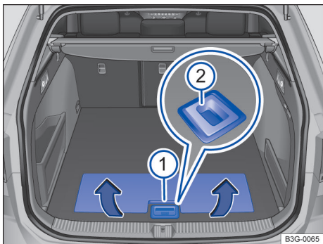
Fig. 180 No compartimento de bagagem: assoalho do compartimento de bagagem repartido.
