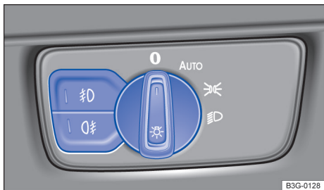
Fig. 103 Ao lado do volante: interruptor de luzes (uma variante).
