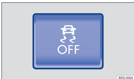
Fig. 165 No controle central: botão para desligar e ligar ASR manualmente.
