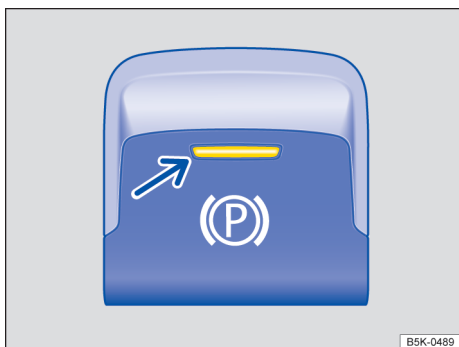
Fig. 152 No console central: botão do freio de estacionamento eletrônico.
