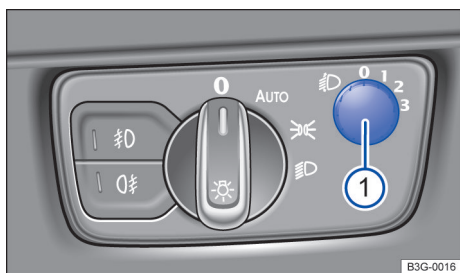
Fig. 106 Ao lado do volante: regulador da regulagem de alcance do farol ①.
