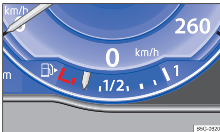
Fig. 21 No instrumento combinado digital, indicador do nível de combustível.
