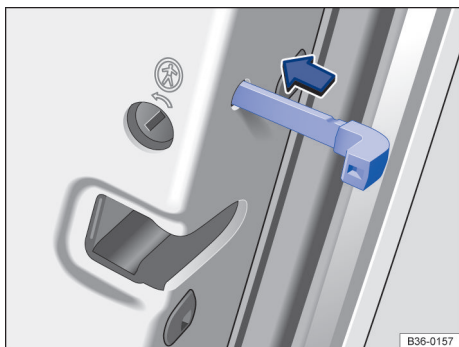
Fig. 75 Na parte dianteira da porta traseira direita: travamento de emergência do veículo com a chave de emergência.
