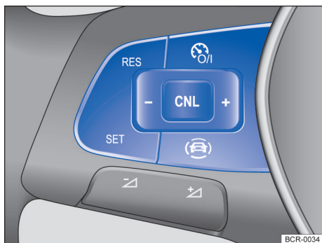
Fig. 144 Lado esquerdo do volante multifunções: botões para comandar o limitador de velocidade.
