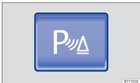
Fig. 154 No console central: botões para ligar e desligar o auxílio de estacionamento (dependendo da versão).
