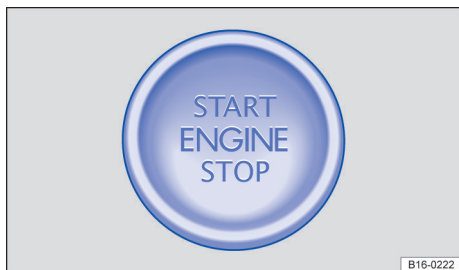
Fig. 128 Na parte inferior do console central: botão de partida para arrancar o motor.
