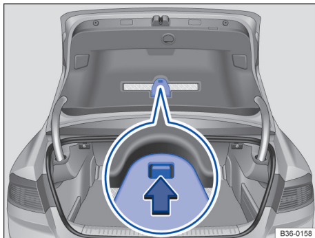
Fig. 65 Na tampa do compartimento de bagagem: suporte para o triângulo de segurança (Passat).
