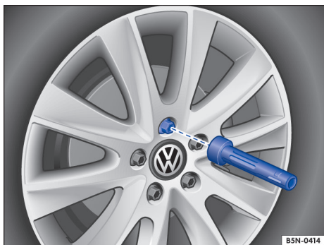
Fig. 265 Troca de roda: desaparafusar os parafusos de roda com o punho da chave de fenda.
