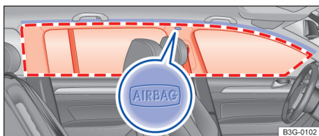
Fig. 50 No lado esquerdo do veículo (Passat Variant): local de instalação e área de expansão do airbag para cabeça.
