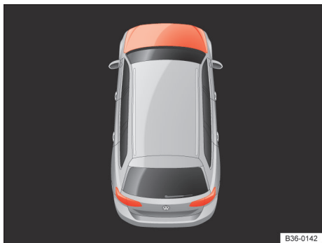
Fig. 240 No display do instrumento combinado: tampa do compartimento do motor aberta ou fechada incorretamente.
