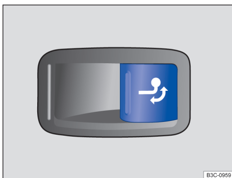
Fig. 206 No compartimento de bagagem, à direita: botão para destravamento da rótula de engate.
