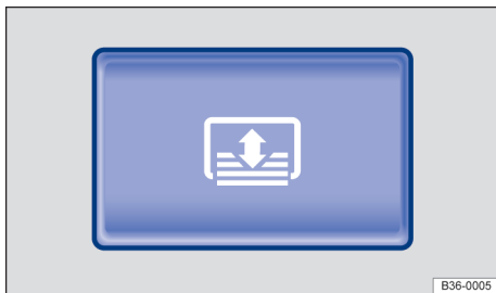
Fig. 117 No console central: botão da cortina de proteção solar do vidro traseiro.
