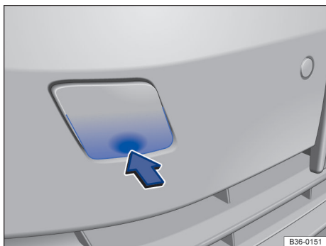
Fig. 236 No para-choque dianteiro à direita: retirar a cobertura.
