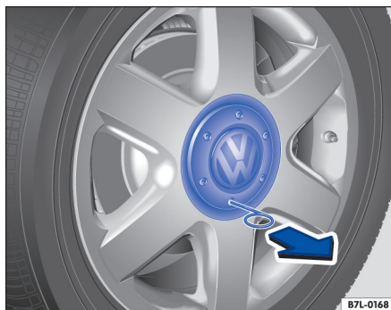
Fig. 256 Retirar a calota central.
