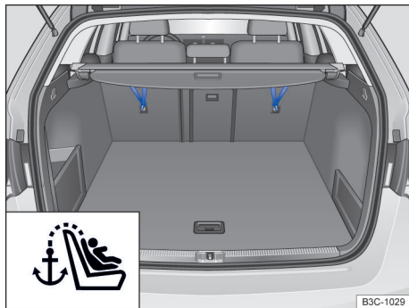
Fig. 59 No compartimento de bagagem: cinto de fixação superior pendurado (Variant).
