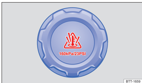
Fig. 245 No compartimento do motor: tampa do reservatório de expansão do líquido de arrefecimento (representação esquemática).
