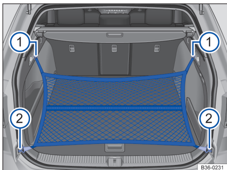
Fig. 196 No compartimento de bagagem: rede para bagagem presa no canto do compartimento de bagagem.
