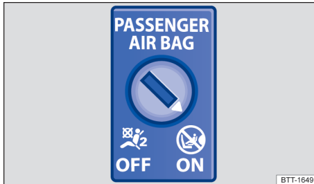
Fig. 46 No painel de instrumentos no lado do passageiro dianteiro: interruptor acionado pela chave para desligar e ligar o airbag do passageiro dianteiro.
