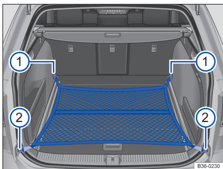
Fig. 195 No compartimento de bagagem: rede para bagagem presa de forma plana.
