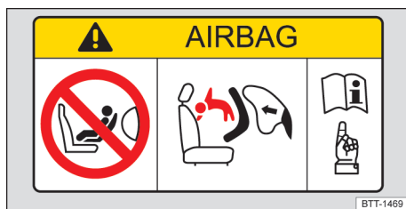
Fig. 54 Representação esquemática: etiqueta de air-bag no para-sol.
