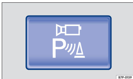
Fig. 163 No console central: botão para a ligação manual da visão do ambiente.
