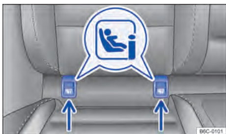
Fig. 44 No banco do veículo: identificação dos pontos de ancoragem inferiores para cadeiras de criança.
