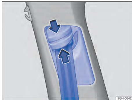
Fig. 34 Ao lado dos bancos dianteiros: regulagem de altura do cinto de segurança.
