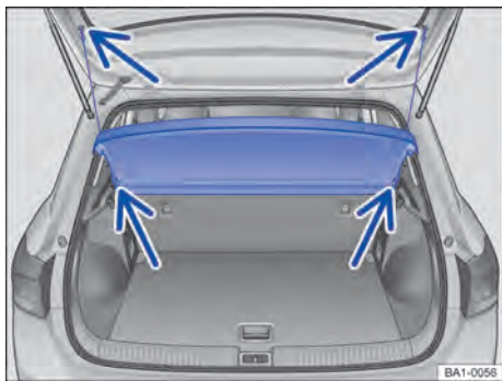
Fig. 172 No compartimento de bagagem: remover e instalar a cobertura do compartimento de bagagem.
