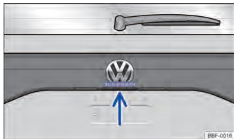
Fig. 61 Na tampa traseira: botão para abrir a tampa traseira.
