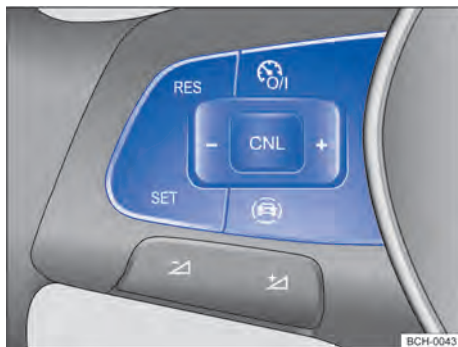
Fig. 102 Lado esquerdo do volante multifunções (variante 1): botões para comandar o limitador de velocidade.
