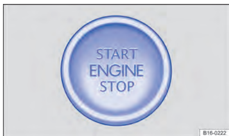
Fig. 90 Na parte inferior do console central: botão de partida para ligar o motor.
