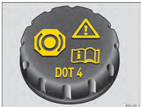
Fig. 207 No compartimento do motor: tampa do reservatório de fluido de freio.
