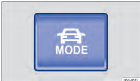
Fig. 97 Na parte superior do console central: botão MODE de seleção do perfil de condução.
