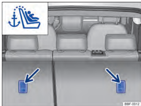
Fig. 45 Olhal de retenção para o cinto de fixação superior no lado de trás do banco traseiro.
