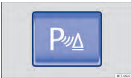
Fig. 110 No console central: botão para ligar e desligar o auxílio de estacionamento.
