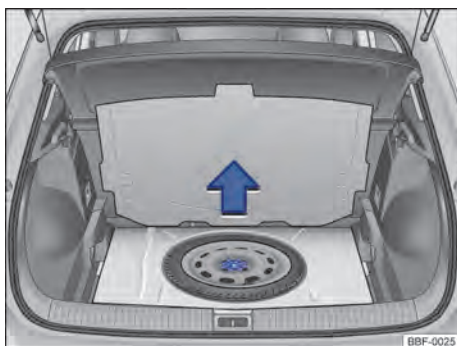
Fig. 178 No compartimento de bagagem, sob o revestimento de assoalho: roda de emergência e ferramentas de bordo.
