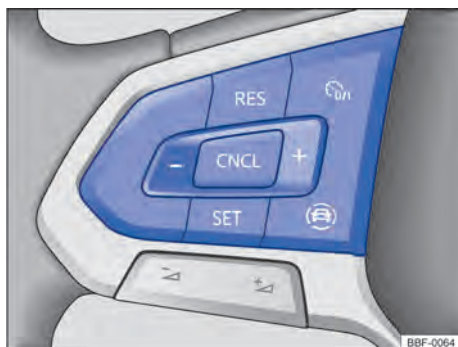
Fig. 103 Lado esquerdo do volante multifunções (variante 2): botões para comandar o limitador de velocidade.
