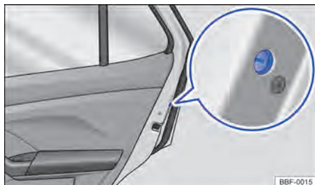
Fig. 58 Na porta traseira: travamento de emergência.
