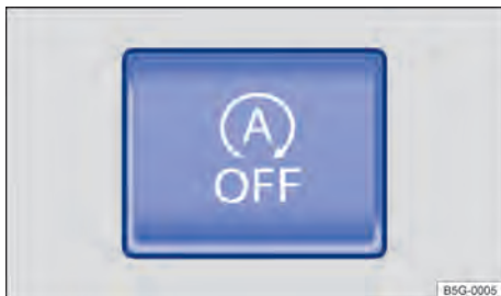
Fig. 92 Na parte superior do console central: botão do sistema Start-Stop.
