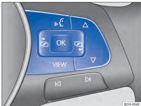
Fig. 20 Lado direito do volante multifunções (variante 1): botões para comando dos menus e exibições de informação do instrumento combinado.
