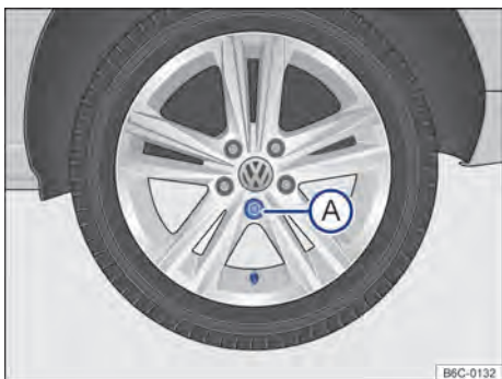
Fig. 216 Retirar a calota integral.
