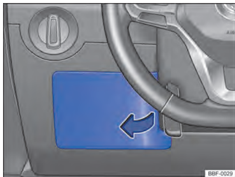
Fig. 188 No lado do condutor do painel de instrumentos: cobertura da caixa de fusíveis.
