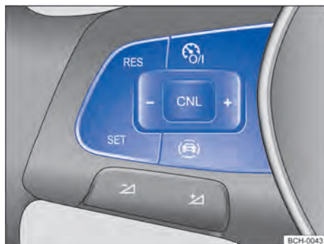
Fig. 100 Lado esquerdo do volante multifunções (variante 1): botões para comandar o GRA
