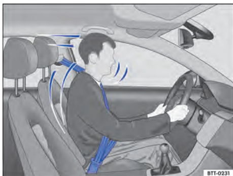
Fig. 29 Condutor protegido pelo cinto de segurança colocado corretamente em uma manobra de frenagem súbita.
