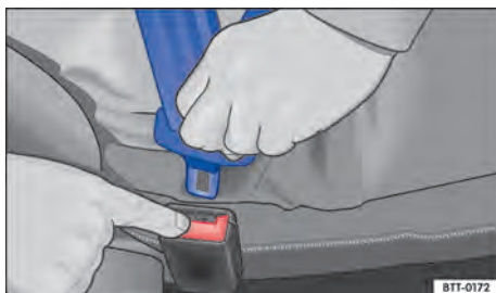
Fig. 31 Soltar a lingueta do cinto de segurança do fecho do cinto de segurança.
