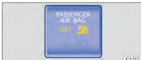
Fig. 41 No console central: luz de controle para o airbag frontal do passageiro dianteiro desligado.
