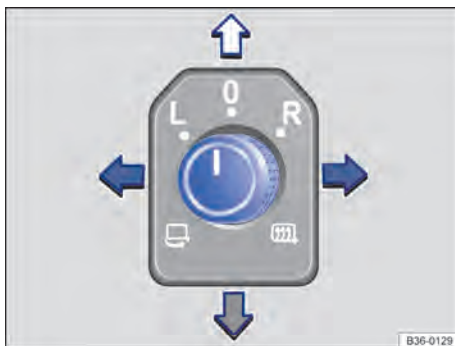
Fig. 119 Na porta do condutor: botão rotativo dos espelhos retrovisores externos.
