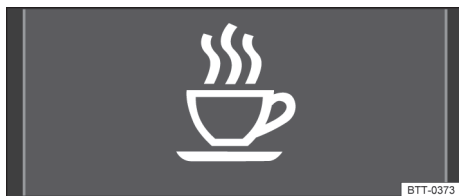
Fig. 20 No display do instrumento combinado: símbolo do sistema de reconhecimento de cansaço.
