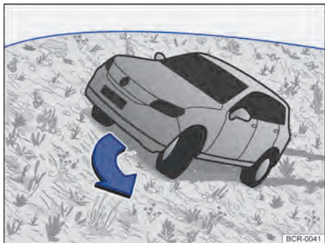
Fig. 144 Representação esquemática: dirigir na linha de inclinação.
