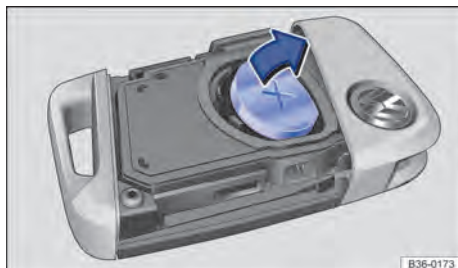
Fig. 67 Chave do veículo: substituir a pilha-botão.
