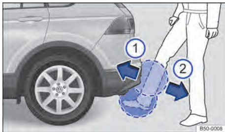
Fig. 80 Tampa traseira com abertura controlada por sensor (Easy Open).
