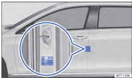
Fig. 247 Na coluna do condutor: etiqueta com as pressões dos pneus (alternativa ao lado interno da portinhola do tanque).
