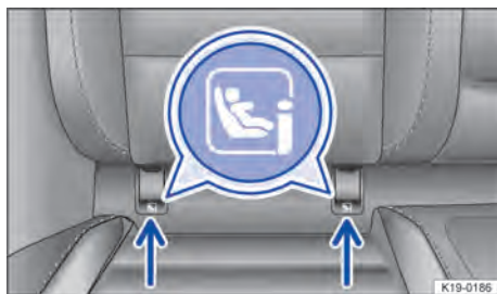
Fig. 57 Identificação dos pontos de ancoragem do i-Size para cadeiras de criança.
