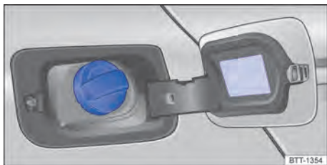
Fig. 202 No lado interno da portinhola do tanque: placa de indicação de combustível.
