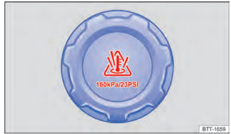
Fig. 240 No compartimento do motor: tampa do reservatório de expansão do líquido de arrefecimento (representação esquemática).
