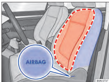
Fig. 47 Lateralmente no banco dianteiro: local de instalação e área de expansão dos airbags laterais.
