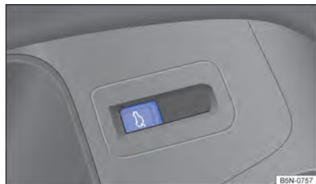
Fig. 78 Na porta do condutor: botão de destravamento da tampa traseira.
