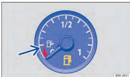
Fig. 14 Representação esquemática: indicador do nível de combustível no instrumento combinado analógico.
