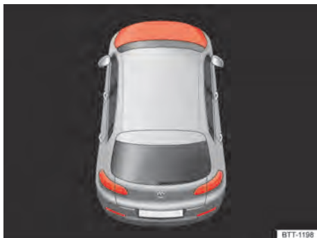
Fig. 235 No display do instrumento combinado: tampa dianteira aberta ou não fechada corretamente (representação esquemática).
