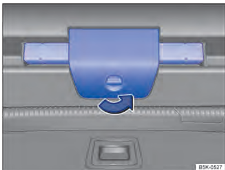
Fig. 81 Na tampa traseira: abrir o suporte do triângulo de segurança.
