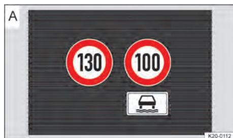
Fig. 21 No display do instrumento combinado: exemplos de exibições do sistema de reconhecimento da sinalização de trânsito.
