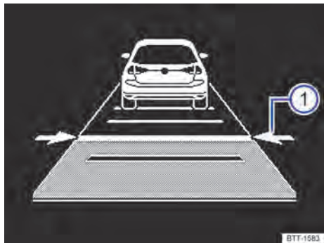
Fig. 156 No display do instrumento combinado: distância regulada ① (representação esquemática, ACC regula).
