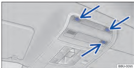
Fig. 75 No console do teto: sensores do monitoramento do interior do veículo (setas).
