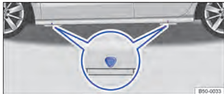
Fig. 258 Pontos de apoio do macaco.
