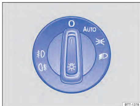
Fig. 109 Ao lado do volante: interruptor de luzes (uma variante).
