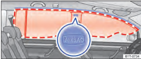
Fig. 48 No lado esquerdo do veículo (5 lugares): local de instalação e área de expansão do airbag para cabeça.
