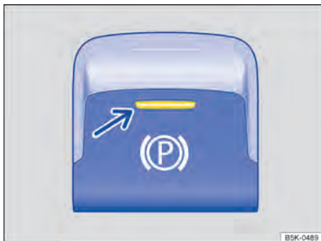
Fig. 160 No console central: botão do freio de estacionamento eletrônico (representação esquemática).
