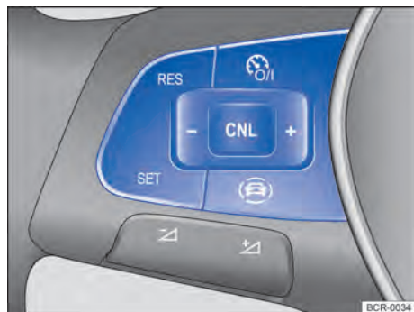
Fig. 147 Lado esquerdo do volante multifunções: botões para comandar o GRA.
