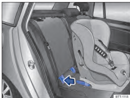
Fig. 58 Representação esquemática: instalar a cadeira de criança com braços de apoio.
