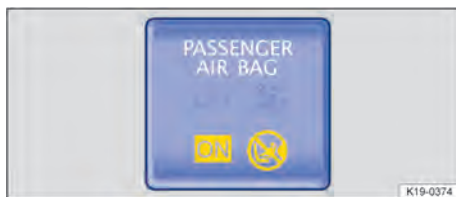
Fig. 42 No console central: luz de controle para airbag frontal do passageiro dianteiro ativado.
