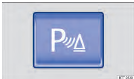
Fig. 163 No console central: botão para ligar ou desligar o auxílio de estacionamento (representação esquemática).
