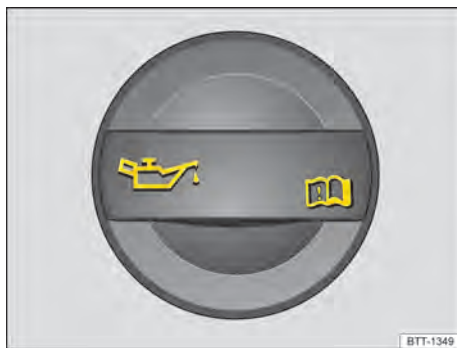
Fig. 238 No compartimento do motor: tampa da abertura para enchimento de óleo do motor (representação esquemática).
