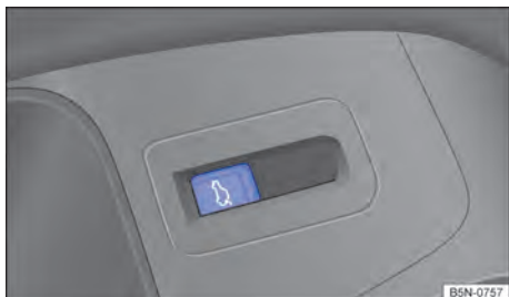
Fig. 71 Na porta do condutor: botão para abertura elétrica da tampa traseira.
