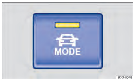
Fig. 139 No console central: botão MODE na seleção do perfil de condução.
