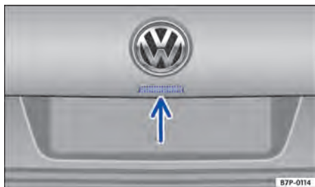
Fig. 76 Na tampa traseira: botão para abrir a tampa traseira.
