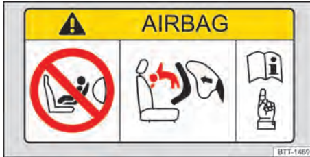
Fig. 53 Representação esquemática: etiqueta do airbag no para-sol.
