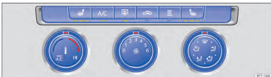
Fig. 122 Na parte superior do console central: painel de comando do ar-condicionado do ar-condicionado manual.
