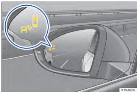
Fig. 158 No espelho retrovisor externo: exibição do sensor de ponto cego.
