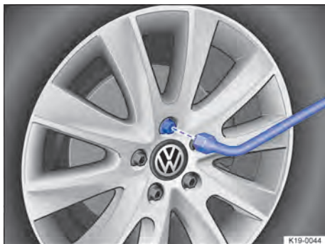
Fig. 261 Troca de roda: desaparafusar os parafusos de roda com a chave de roda.
