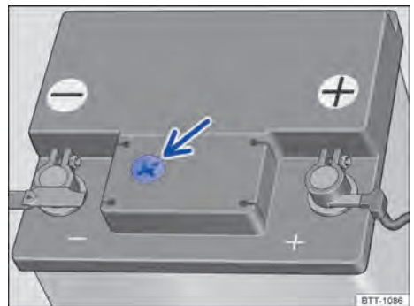
Fig. 243 Visor no lado superior da bateria do veículo 12 V (representação esquemática).
