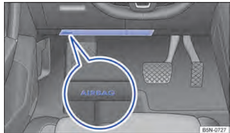
Fig. 50 No lado do condutor: local de instalação do airbag para joelhos.
