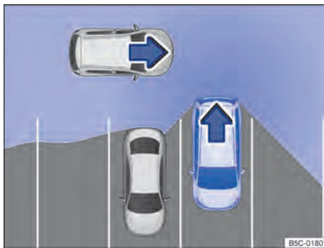
Fig. 174 Representação esquemática do assistente de saída de vaga: área monitorada ao redor do veículo.
