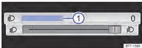
Fig. 113 No sistema Infotainment: regulador touch para regulagem do alcance do farol.
