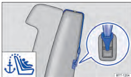
Fig. 59 Na parte traseira da segunda fileira de assentos: olhais de retenção do cinto de fixação superior.
