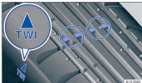
Fig. 248 Perfil do pneu: indicador de desgaste.
