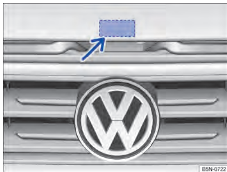
Fig. 234 Acima da grade do radiador: alavanca de acionamento para a tampa dianteira.
