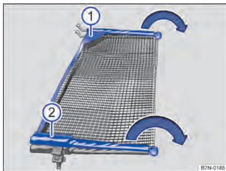
Fig. 193 Abrir a rede divisória.
