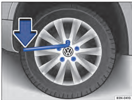
Fig. 253 Troca de roda: afrouxar os parafusos de roda.
