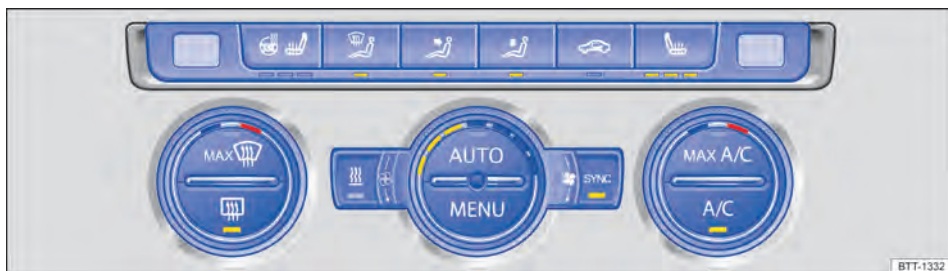
Fig. 123 Na parte superior do console central: painel de comando do ar-condicionado do Climatronic.
