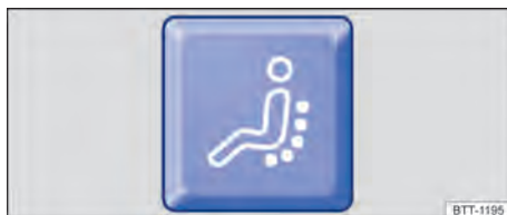
Fig. 106 Na região inferior do banco do condutor: botão da função de massagem.
