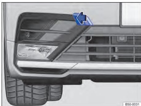
Fig. 230 No para-choque dianteiro à direita: capa de cobertura para o alojamento da argola de reboque.
