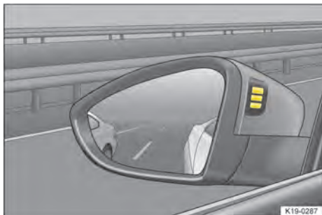
Fig. 159 Nas carcaças dos espelhos retrovisores externos: indicações visuais do assistente de mudança de faixa.
