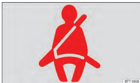
Fig. 30 No display do instrumento combinado: luz de advertência.
