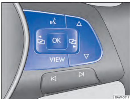
Fig. 25 Lado direito do volante multifunções: botões para comando dos menus e exibições de informação do instrumento combinado.
