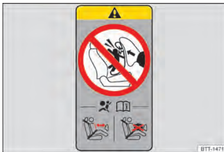
Fig. 54 Representação esquemática: etiqueta do airbag na coluna B.
