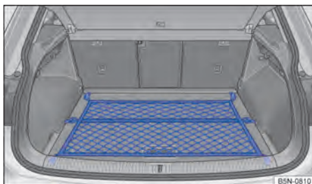
Fig. 196 No compartimento de bagagem: rede para bagagem presa de forma plana.
