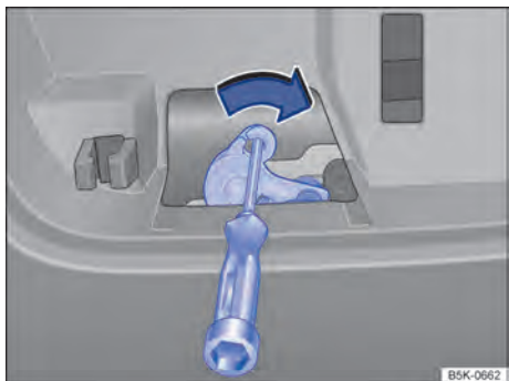
Fig. 82 Na tampa traseira: destravamento de emergência para a tampa traseira.
