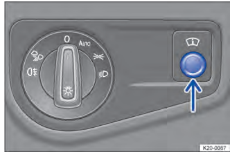
Fig. 18 Ao lado do volante: regulador do head-up display (seta).
