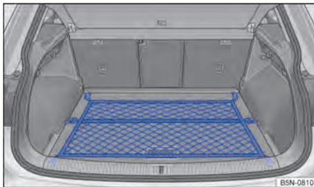
**Fig. 220** No compartimento de bagagem: fixar a rede para bagagem no assoalho.
