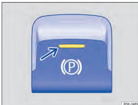
Fig. 173 Na parte inferior do console central: botão do freio de estacionamento eletrônico.
