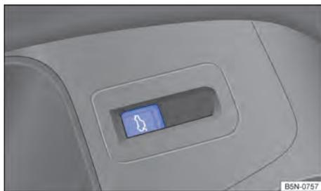
**Fig. 70** Na porta do condutor: destravamento da tampa do compartimento de bagagem.
