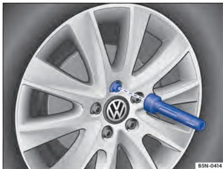
**Fig. 278** Troca de roda: desaparafusar os parafusos de roda com o punho da chave de fenda.
