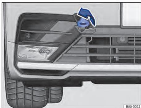
Fig. 251 No para-choque dianteiro à direita: rosquear a argola de reboque.
