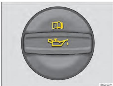
**Fig. 258** No compartimento do motor: tampa da abertura para enchimento de óleo do motor (representação esquemática).
