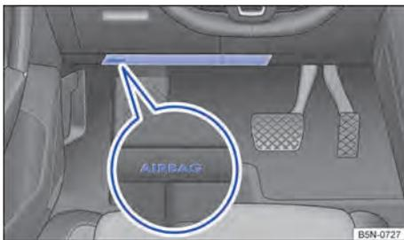
Fig. 21 No lado do condutor: local de instalação do airbag para joelhos.
