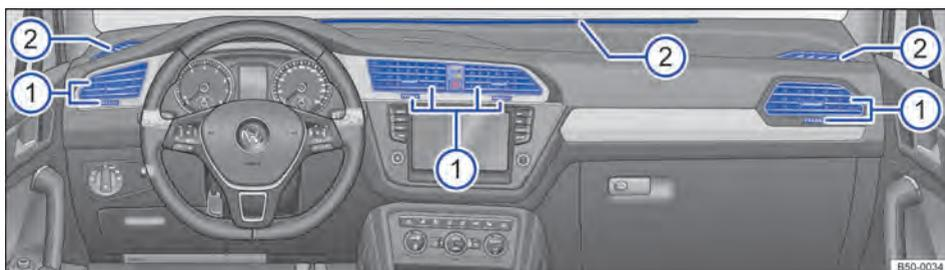
Fig. 124 No painel de instrumentos: difusores de ar.
