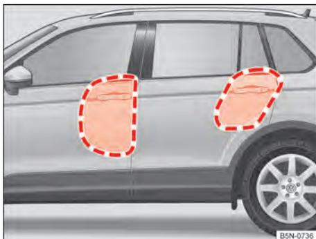
Fig. 18 No lado esquerdo do veículo: áreas de desenvolvimento do airbag lateral.
