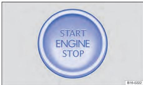
**Fig. 134** Na parte inferior do console central: botão de partida para ativação do motor.
