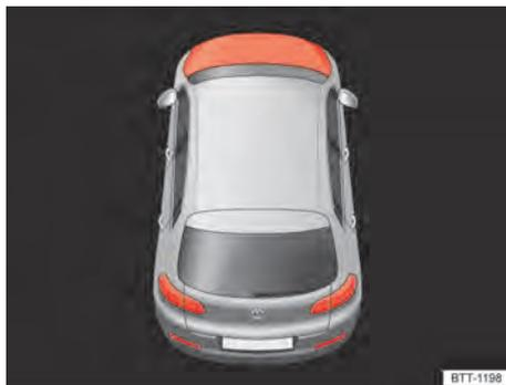
**Fig. 255** No display do instrumento combinado: tampa do compartimento do motor aberta ou fechada incorretamente (representação esquemática).
