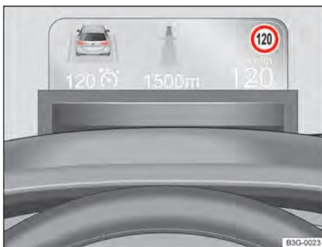
Fig. 50 No painel de instrumentos acima do volante: head-up display.
