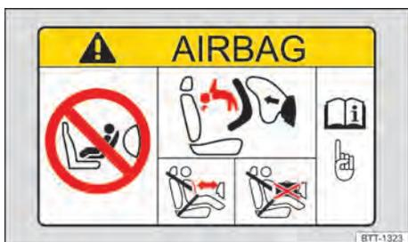
**Fig. 24** Representação esquemática: etiqueta de airbag no para-sol.
