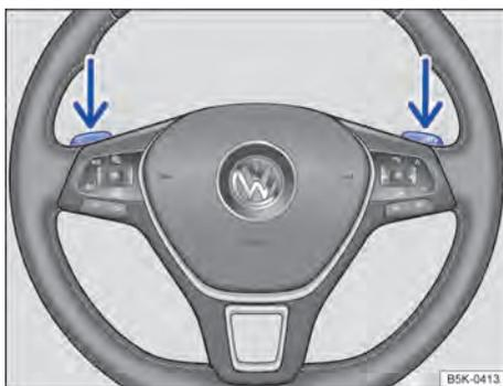
Fig. 141 Volante com seletores basculantes do Tiptronic.
