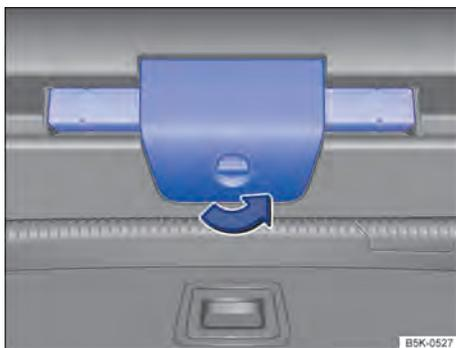
**Fig. 30** Na tampa do compartimento de bagagem: suporte para o triângulo de segurança.
