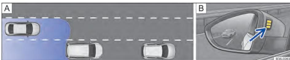
Fig. 170 **A** Situação de condução ao ultrapassar com o trânsito traseiro. **B** Indicação visual no espelho retrovisor externo esquerdo.
