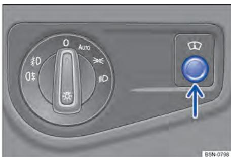
Fig. 49 Ao lado do volante: regulador do head-up display (seta).
