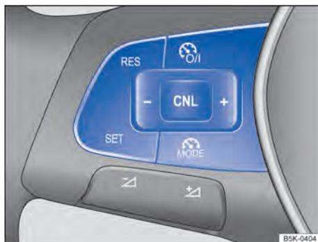
Fig. 153 Lado esquerdo do volante multifunções: botões para comandar o sistema regulador de velocidade. ▶
