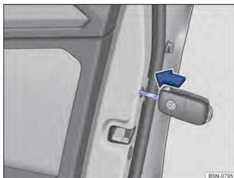
**Fig. 79** Na parte dianteira da porta traseira direita: travamento de emergência do veículo com a chave do veículo.
