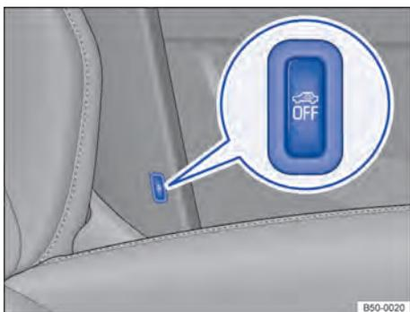
**Fig. 72** Ao lado do banco do condutor: botão para desligar o monitoramento do interior do veículo e o alarme antirrebocagem.
