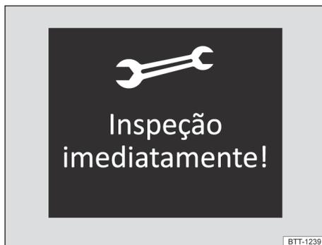
Fig. 56 No display do instrumento combinado: exemplo de indicação para um evento de serviço próximo de vencer (representação esquemática).
