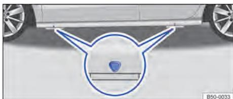
Fig. 276 Pontos de apoio do macaco.
