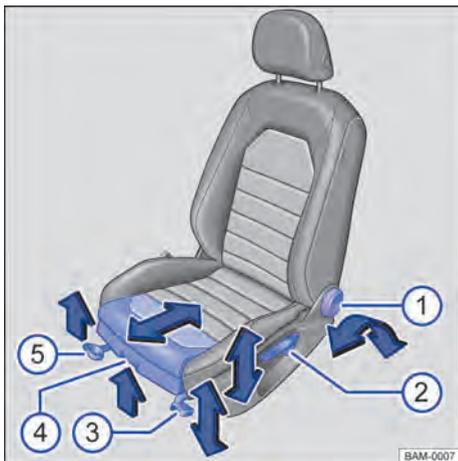
Fig. 90 Comandos do banco dianteiro esquerdo (variante 2).
