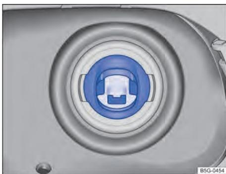
Fig. 229 Representação esquemática: proteção contra abastecimento errôneo no bocal de abastecimento do tanque.
