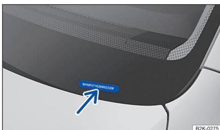
**Fig. 13** Na área esquerda do para-brisa: número de identificação do veículo.
