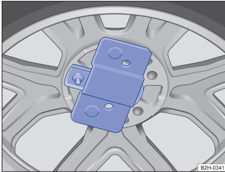
**Fig. 15** Roda sobressalente ou roda de emergência: soltar o suporte do aro.
