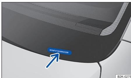
Fig. 18 Na área esquerda do para-brisa: número de identificação do veículo.
