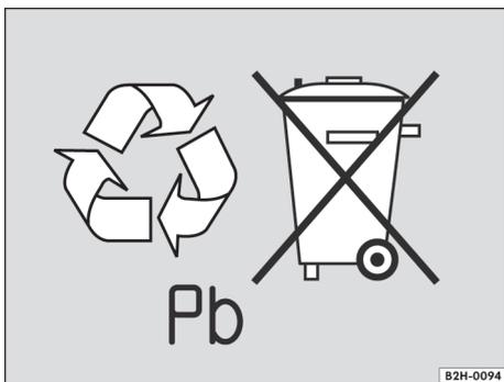
**Fig. 10** As baterias contêm substâncias tóxicas. Por isso, é proibido o seu descarte / disposição com o lixo doméstico. A legislação determina procedimentos específicos para o descarte / disposição de baterias usadas.
