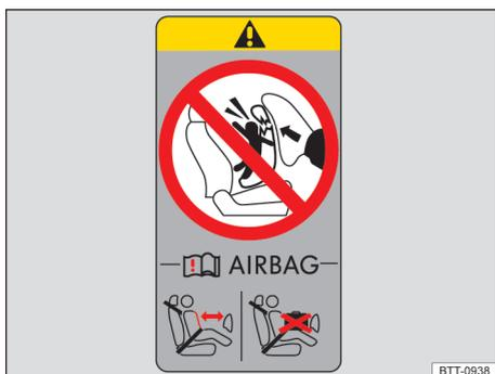
Fig. 5 Na coluna B do lado do passageiro dianteiro: etiqueta adesiva do airbag.
