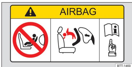
Fig. 4 No para-sol do lado do passageiro dianteiro: etiqueta adesiva do airbag.
