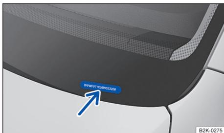
Fig. 12 Na área esquerda do para-brisa: número de identificação do veículo.
