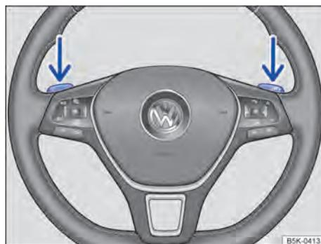
Fig. 84 Volante com seletores basculantes do Tiptronic.
