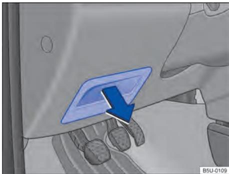
**Fig. 161** No lado do condutor no painel de instrumentos: cobertura da caixa de fusíveis.
