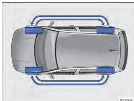
Fig. 180 Esquema para a troca das rodas.
