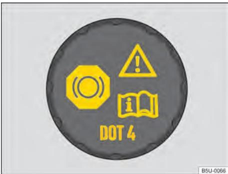
Fig. 176 No compartimento do motor: tampa do reservatório de fluido de freio.
