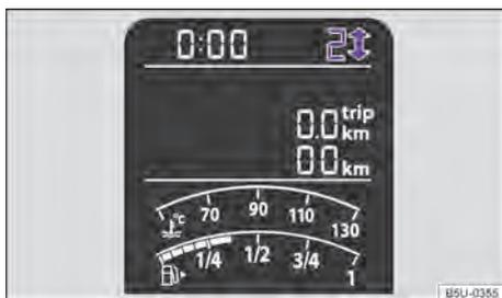
Fig. 76 No instrumento combinado: indicador de troca de marcha (variante 1).
