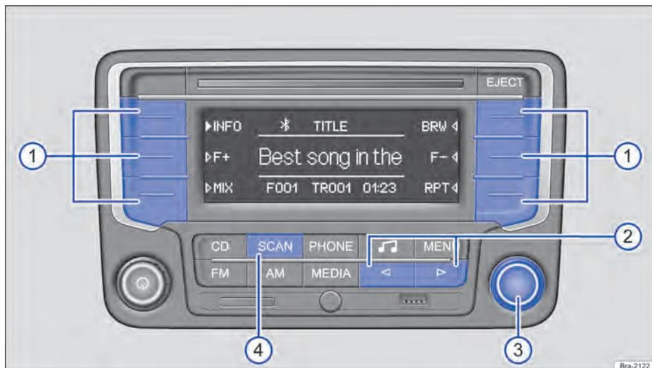
**Fig. 136** Exemplo de exibição na operação de mídia: exibição do local de armazenamento de um MP3 na troca de faixa.
