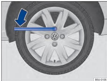
Fig. 187 Troca de roda: soltar os parafusos da roda.
