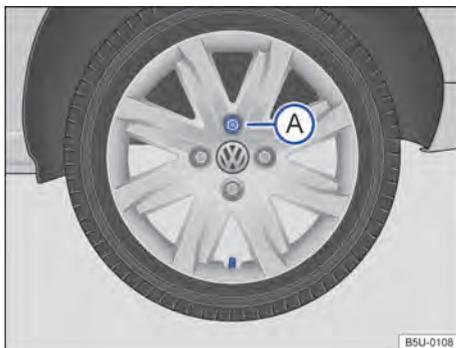
Fig. 186 Retirar a supercalota.
