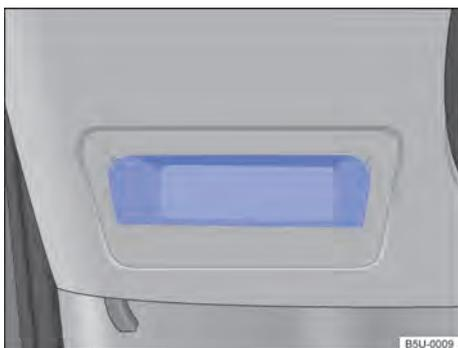
**Fig. 90** No lado esquerdo, na parte inferior no console: porta-objetos.
