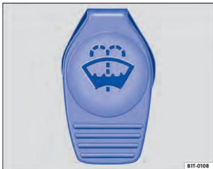
**Fig. 171** No compartimento do motor: tampa do reservatório de água dos lavadores dos vidros.
