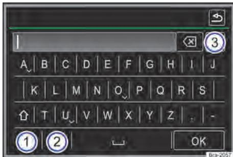
Fig. 101 Representação do princípio: máscara de inserção com teclado de display.
