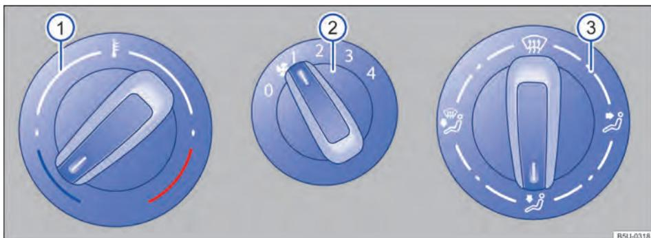
Fig. 71 Comandos do sistema de ventilação e aquecimento.
