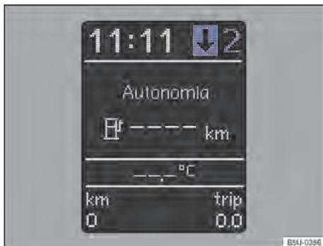
Fig. 77 No instrumento combinado: indicador de troca de marcha (variante 2).
