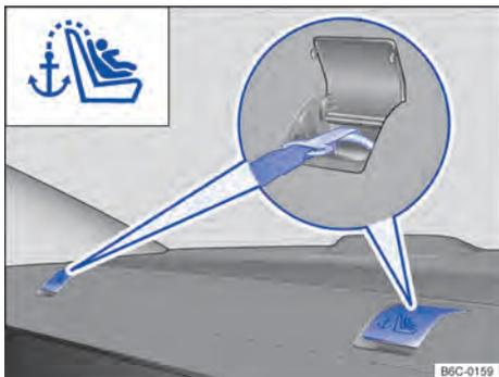
**Fig. 37** Olhal de retenção para o cinto de fixação superior na cobertura do compartimento de bagagem.
