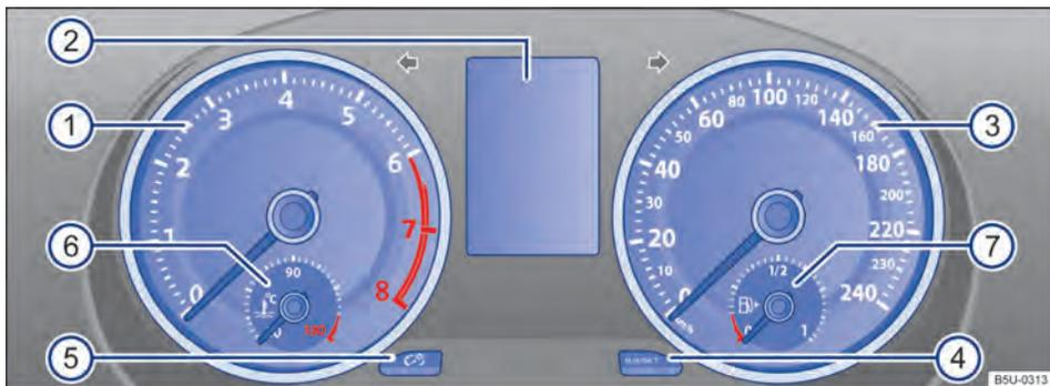
Fig. 11 Instrumento combinado no painel de instrumentos (variante 2).
