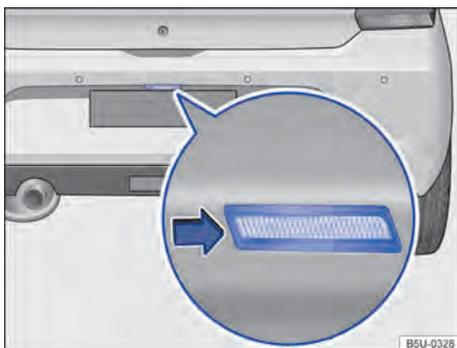
Fig. 159 No para-choque traseiro: remover a lanterna da placa de licença.
