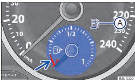
Fig. 13 No instrumento combinado: indicador do nível de combustível (variante 2).
