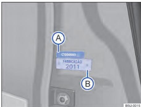
**Fig. 194** Na coluna da porta dianteira direita: etiqueta com o número de identificação do veículo parcial (A) e etiqueta de identificação do ano de fabricação (B).
