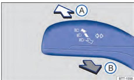
Fig. 63 À esquerda na coluna de direção: alavanca dos indicadores de direção e do farol alto.
