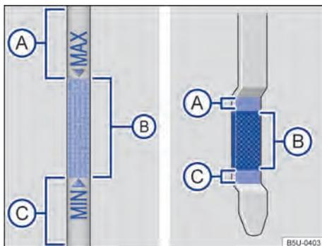
Fig. 172 Vareta de medição do óleo com marcas de nível do óleo do motor.
