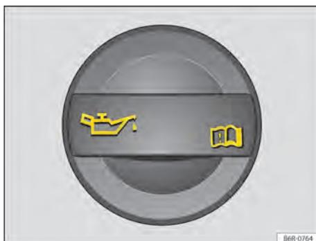
Fig. 173 No compartimento do motor: tampa da abertura para enchimento de óleo do motor.
