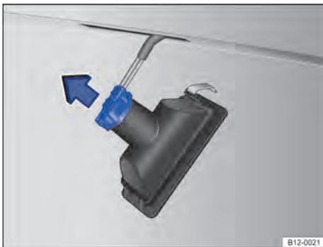
Fig. 160 Lanterna da placa de licença: remover o soquete da lâmpada.
