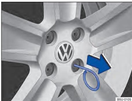
Fig. 185 Retirar as capas de cobertura dos parafusos da roda.
