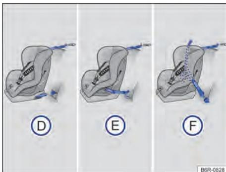
**Fig. 35** No banco traseiro: as figuras (D) e (E) mostram o princípio da fixação do sistema de retenção para crianças nos olhais de retenção inferiores e com o cinto de fixação superior. A figura (F) mostra a fixação do sistema de retenção para crianças com o cinto de segurança do veículo e com o cinto de fixação superior.
