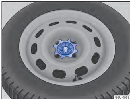
**Fig. 183** No compartimento de bagagem: manípulo para fixação da roda de emergência.
