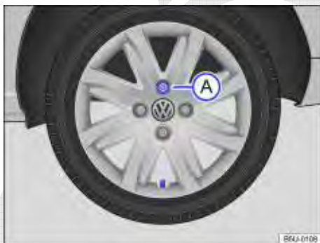
Fig. 159 Retirar a supercalota.
