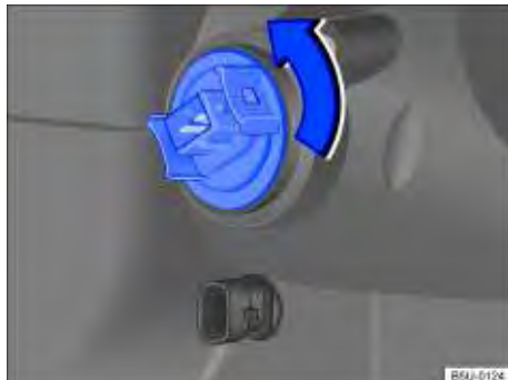
Fig. 176 Soquete da lâmpada incandescente do indicador de direção dianteiro.
