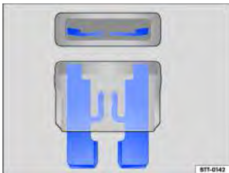
Fig. 167 Representação de um fusível queimado.
