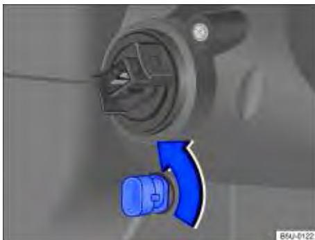
Fig. 174 Soquete da lâmpada incandescente da luz de posição.
