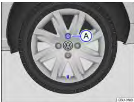
Fig. 164 Troca de roda: sequência de remoção dos parafusos da roda.
