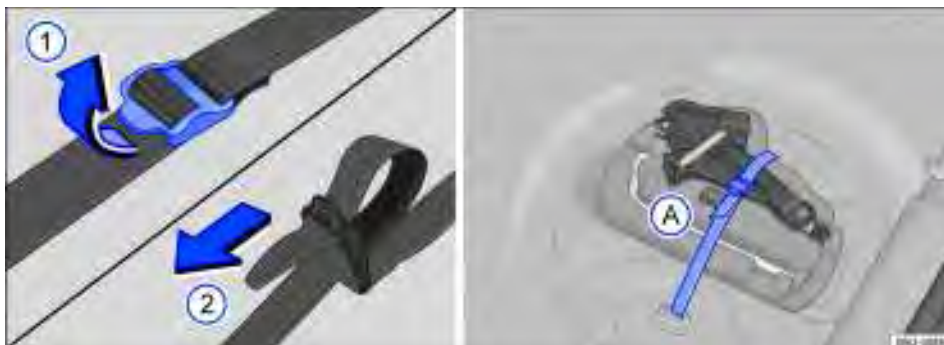
Fig. 157 No compartimento de bagagem: cinta de fixação da caixa de ferramentas e caixa de ferramentas de bordo.
