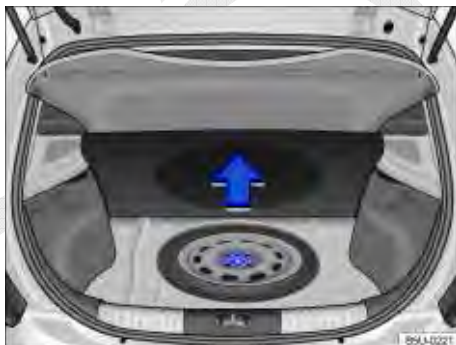
Fig. 156 No compartimento de bagagem, sob o revestimento de assoalho: roda de emergência e ferramentas de bordo.
