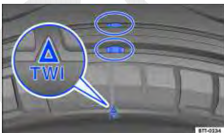
Fig. 140 Perfil do pneu: indicador de desgaste.
