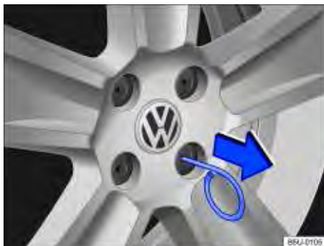
Fig. 160 Remover as capas de cobertura dos parafusos da roda.
