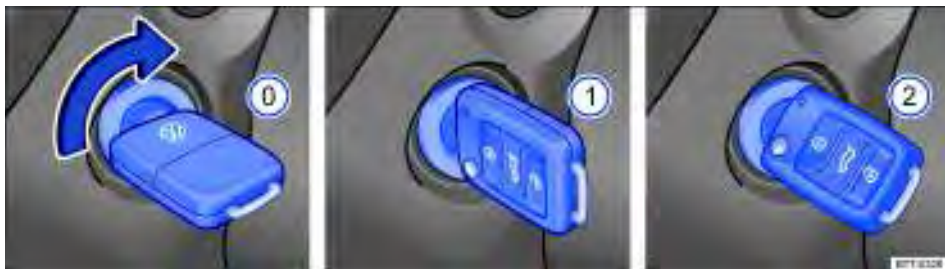
Fig. 96 Ao lado do volante, à direita: posições da chave do veículo no cilindro da ignição.
