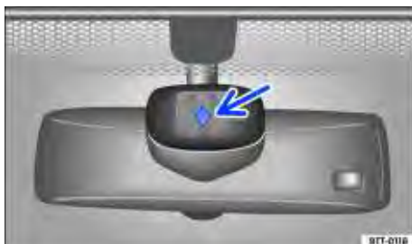
Fig. 71 No para-brisa: superfície sensível do sensor de chuva.
