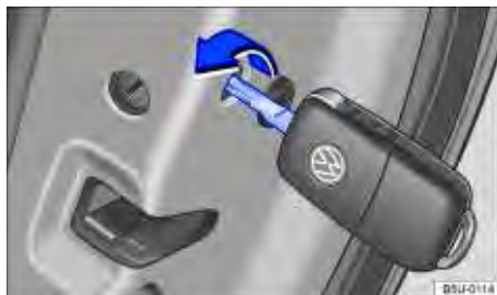
Fig. 155 Travamento de emergência do veículo com a chave do veículo.
