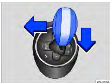
Fig. 103 Alavanca seletora da transmissão automatizada ASG.
