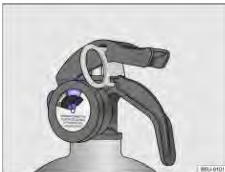
Fig. 153 No extintor de incêndio: indicador de carga (manômetro).
