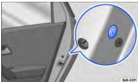
Fig. 154 Na parte dianteira da porta traseira direita: travamento de emergência, coberto por uma vedação de borracha.
