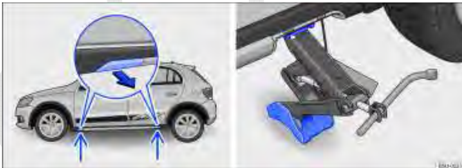
Fig. 163 Pontos de apoio do macaco e macaco posicionado no lado esquerdo traseiro do veículo - veículos com soleiras externas.
