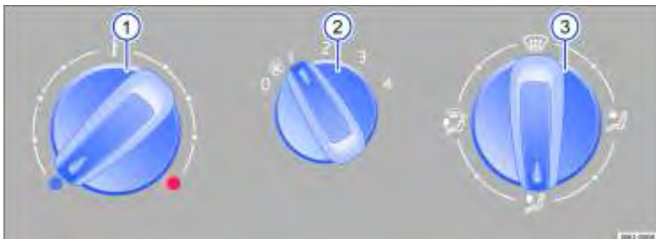
Fig. 117 No console central: comandos do aquecimento e da ventilação.
