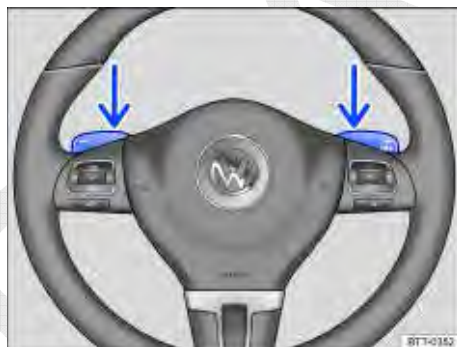
Fig. 105 Volante com dois seletores basculantes para troca de marcha no modo manual.
