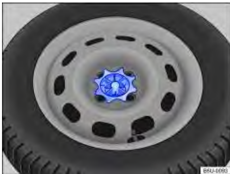
Fig. 141 No compartimento de bagagem: manípulo para fixação da roda de emergência.
