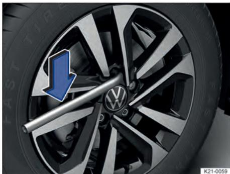
Fig. 187 Troca de roda: afrouxar os parafusos de roda.
