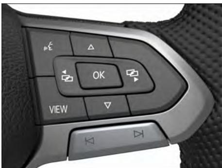
**Fig. 10** Lado direito do volante multifunções: botões para comando dos menus e telas de informação do instrumento combinado digital versão Pro (variante 1).
