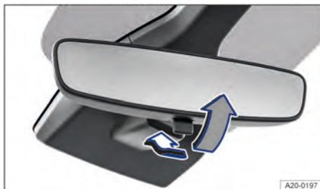
Fig. 89 No para-brisa: espelho retrovisor interno com antiofuscante manual.
