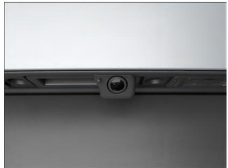
**Fig. 199** Na traseira do veículo: câmera de marcha a ré no botão da alça (representação esquemática).
