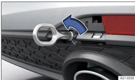
**Fig. 164** No para-choque traseiro à direita: rosquear a argola de reboque da variante 2.
