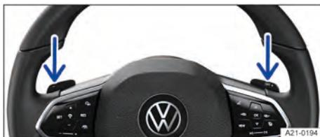
Fig. 106 Volante com seletores basculantes do Tiptronic.
