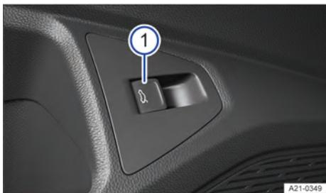
Fig. 61 Na porta do condutor: botão de destravamento da tampa traseira.
