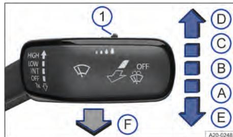
**Fig. 86** À direita da coluna de direção: comandar os limpadores do para-brisa.
