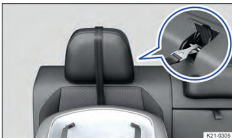
**Fig. 44** No encosto do banco traseiro: posição do cadarço do cinto de segurança no caso de apoios para cabeça não ajustáveis com cinto individual Top Tether.
