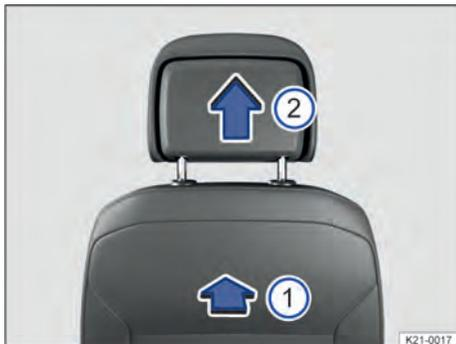
Fig. 74 Apoio para cabeça dianteiro: remover.
