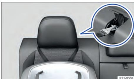
**Fig. 45** No encosto do banco traseiro: posição do cadarço do cinto de segurança no caso de apoios para cabeça não ajustáveis com cinto Top Tether em forma de V.
