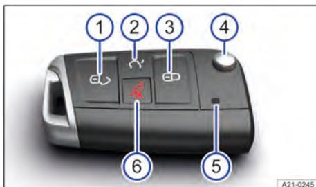
Fig. 48 Chave do veículo com haste da chave.
