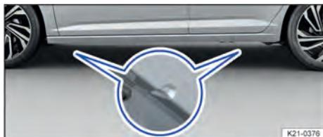
Fig. 191 Pontos de apoio do macaco (variante 1).
