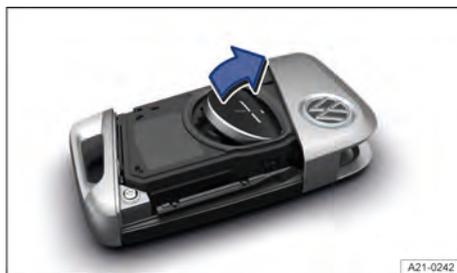
**Fig. 53** Chave do veículo: trocar a pilha-botão.
