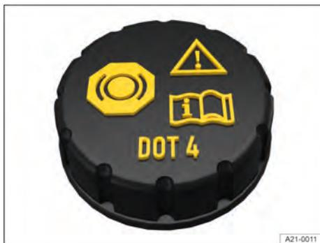
**Fig. 177** No compartimento do motor: tampa do reservatório do fluido de freio.
