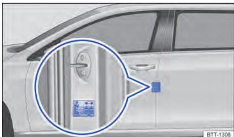
Fig. 181 Na coluna do condutor: etiqueta com as pressões dos pneus (alternativa ao lado interno da portinhola do tanque).
