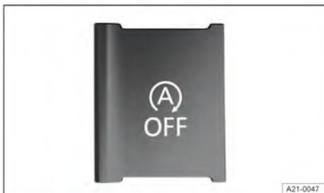
**Fig. 102** Na parte inferior do console central ou, dependendo da versão, no sistema Infotainment: botão do sistema Start-Stop.
