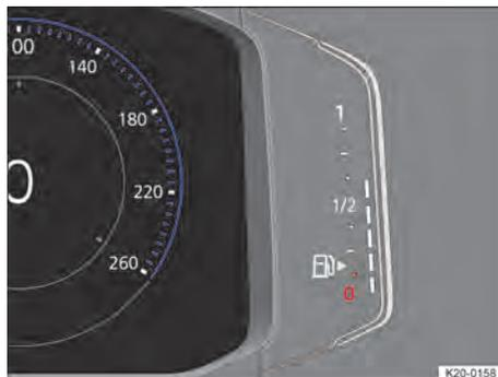
Fig. 15 Indicador do nível de combustível no instrumento combinado digital versão Pro (representação esquemática).
