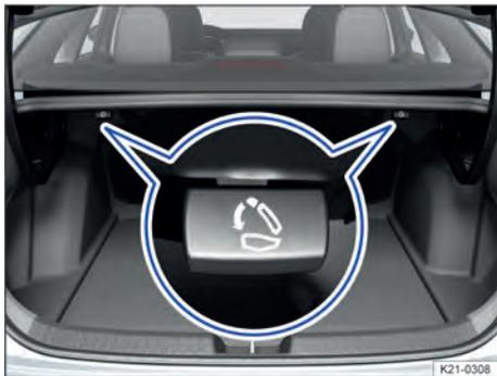
Fig. 70 No compartimento de bagagem: alavanca de destravamento.
