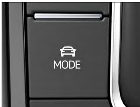
**Fig. 109** No console central: botão MODE na seleção do perfil de condução.
