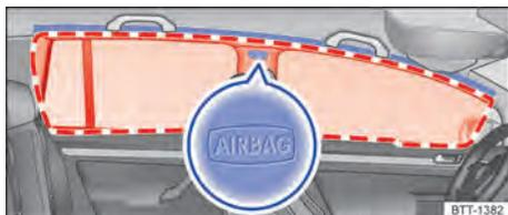
**Fig. 38** No lado esquerdo do veículo: local de instalação e área de expansão do airbag para cabeça.
