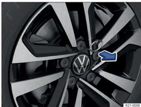
Fig. 186 Remover as capas de cobertura dos parafusos de roda.
