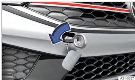
**Fig. 160** No para-choque dianteiro à direita: rosquear a argola de reboque da variante 2.
