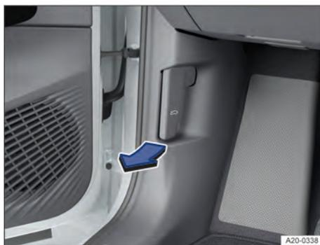
**Fig. 165** Na área para os pés no lado do condutor: alavanca de destravamento da tampa dianteira (representação esquemática).
