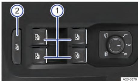
Fig. 63 Na porta do condutor: botões do acionamento dos vidros.
