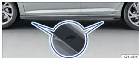
Fig. 192 Pontos de apoio do macaco (variante 2).
