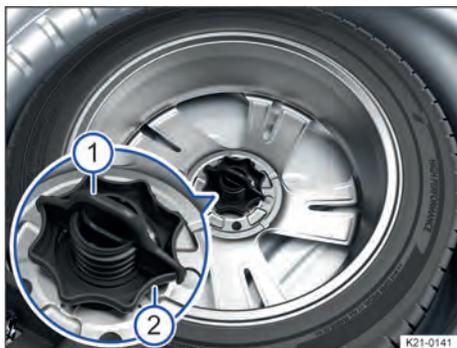
Fig. 190 No compartimento de bagagem: manipulador para fixação da roda sobressalente.
