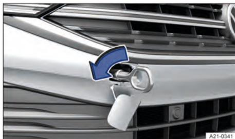
**Fig. 159** No para-choque dianteiro à direita: rosquear a argola de reboque da variante 1.
