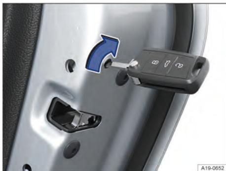
**Fig. 58** Na parte dianteira da porta traseira direita: travamento de emergência do veículo com a chave do veículo (representação esquemática).
