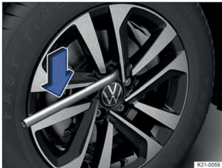
**Fig. 197** Troca de roda: desaparafusar os parafusos de roda com a chave de roda.
