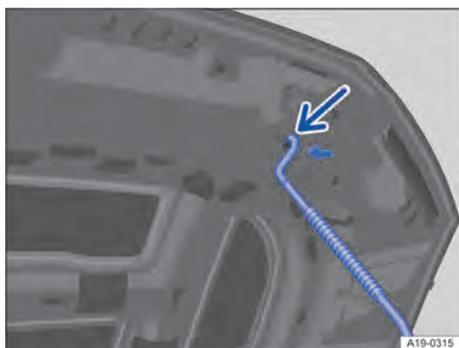
Fig. 168 Na tampa dianteira: alojamento para a haste de sustentação da tampa.
