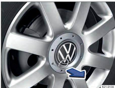
Fig. 184 Retirar a calota central.
