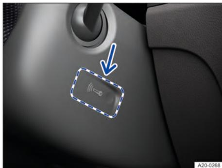
**Fig. 101** À direita na coluna de direção: função de partida de emergência em veículos com sistema de travamento e de partida Keyless Access sem chave.
