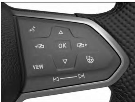
**Fig. 11** Lado direito do volante multifunções: botões para comando dos menus e telas de informação do instrumento combinado digital versão Pro (variante 2).
