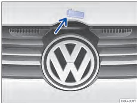
Fig. 166 Acima da grade do radiador: alavanca de comando da tampa dianteira (representação esquemática).
