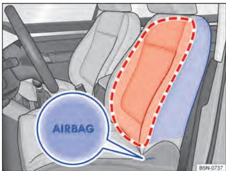
**Fig. 37** Lateralmente no banco dianteiro: local de instalação e área de expansão dos airbags laterais.
