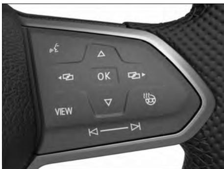
**Fig. 14** Lado direito do volante multifunções: botões para comando dos menus e telas de informação do instrumento combinado digital versão Basic (variante 2).
