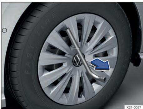
Fig. 185 Retirar a calota integral.
