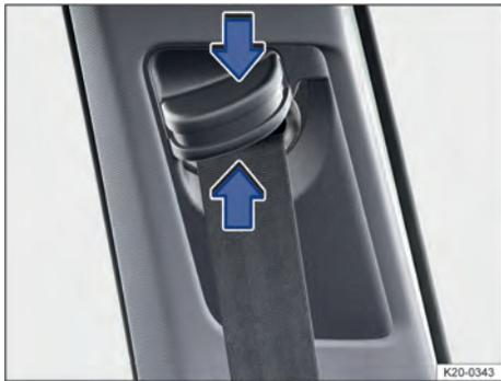
**Fig. 30** Ao lado dos bancos dianteiros: regulagem de altura do cinto de segurança.
