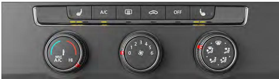
Fig. 93 Na parte superior do console central: painel de comando do ar-condicionado manual.
