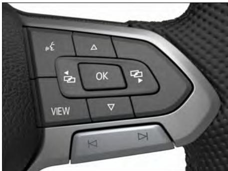
**Fig. 13** Lado direito do volante multifunções: botões para comando dos menus e telas de informação do instrumento combinado digital versão Basic (variante 1).
