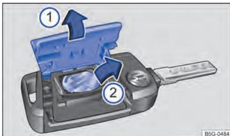
Fig. 49 Chave do veículo: substituir a bateria.
