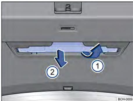
Fig. 46 Na tampa do compartimento de bagagem: suporte para o triângulo de segurança.
