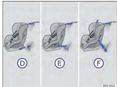
**Fig. 40** No banco traseiro: as figuras (D) e (E) mostram o princípio da fixação do sistema de retenção para crianças nos olhais de retenção inferiores e com o cinto de fixação superior. A figura (F) mostra a fixação do sistema de retenção para crianças com o cinto de segurança do veículo e com o cinto de fixação superior.
