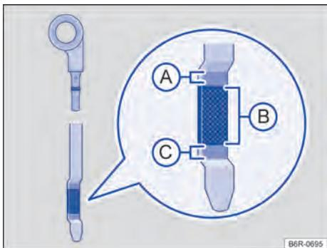
Fig. 179 Varetas de medição do óleo do motor com marcas de nível do óleo do motor.
