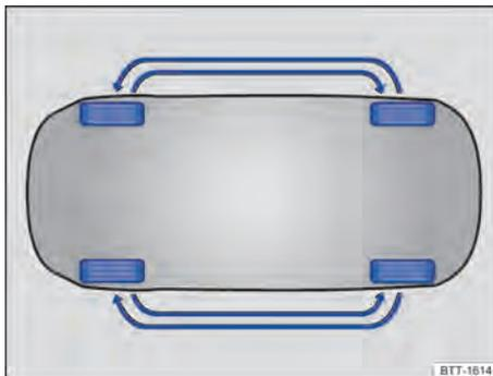
Fig. 186 Esquema para a troca das rodas.
