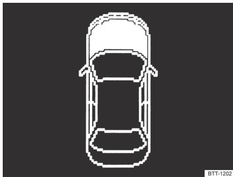
Fig. 177 No display do instrumento combinado: tampa do compartimento do motor aberta ou fechada incorretamente (representação esquemática).
