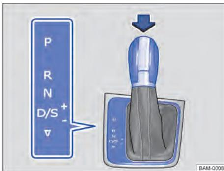
**Fig. 88** Alavanca seletora da transmissão automática com botão bloqueador (seta).
