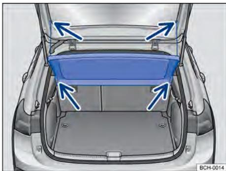
**Fig. 153** No compartimento de bagagem: remover e instalar a cobertura do compartimento de bagagem.
