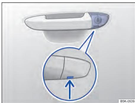
**Fig. 53** Maçaneta da porta do condutor: cilindro da fechadura coberto.
