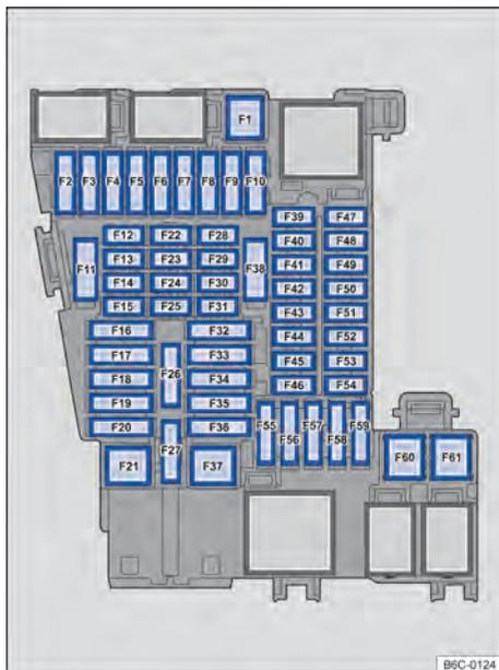
Fig. 168 No painel de instrumentos: disposição dos fusíveis.
