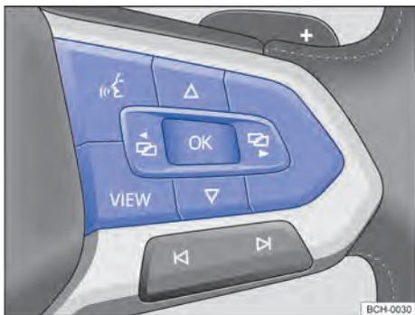
**Fig. 17** Lado direito do volante multifunções: botões para comando dos menus e exibições de informação do instrumento combinado.
