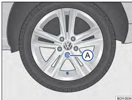
Fig. 195 Troca de roda: sequência de remoção dos parafusos da roda.
