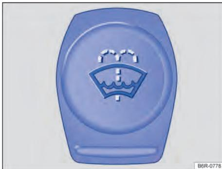
Fig. 178 No compartimento do motor: tampa do reservatório de água dos lavadores dos vidros.
