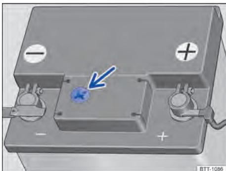
**Fig. 184** No compartimento do motor: exemplo de posição do visor no lado superior da bateria do veículo.
