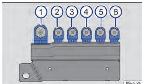
Fig. 171 No compartimento do motor em cima da bateria: disposição dos fusíveis.
