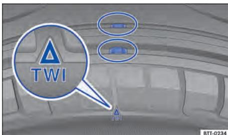
**Fig. 189** Perfil do pneu: indicadores de desgaste.
