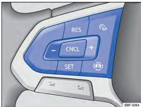
**Fig. 95** Lado esquerdo do volante multifunções (variante 2): botões para comandar o limitador de velocidade.
