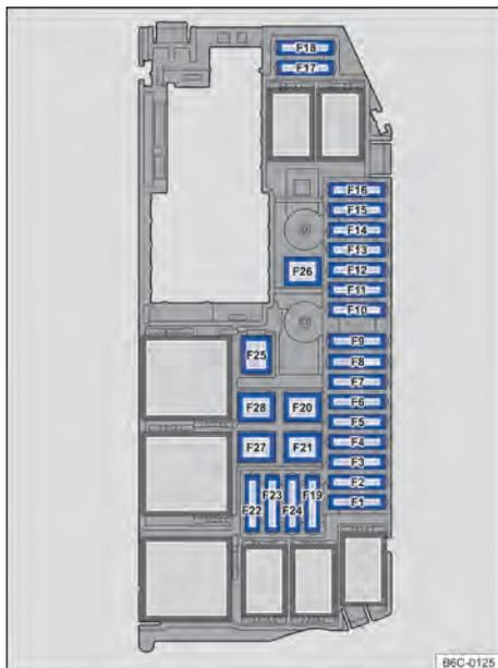
Fig. 170 No compartimento do motor: disposição dos fusíveis.
