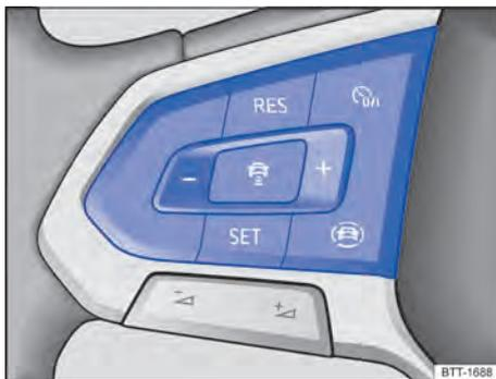
**Fig. 99** Lado esquerdo do volante multifunções: botões para comandar o ACC.
