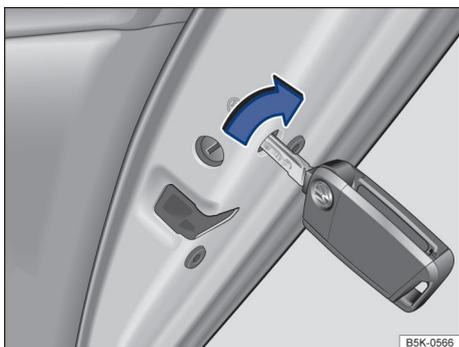
Fig. 3 Travamento de emergência do veículo com a chave do veículo (variante 1).
