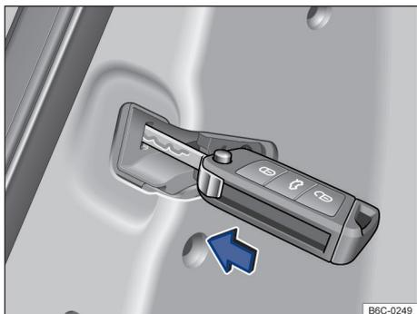
Fig. 4 Nas portas, dianteira direita e traseiras: travamento de emergência do veículo com a haste metálica da chave (variante 2).
