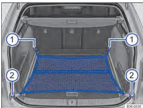
Fig. 209 No compartimento de bagagem: rede para bagagem presa de forma plana.
