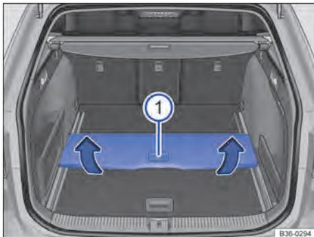
Fig. 197 No compartimento de bagagem: remover o assoalho do compartimento de bagagem deslizante.
