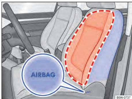
Fig. 50 Lateralmente no banco dianteiro: local de montagem e área de expansão dos airbags laterais.
