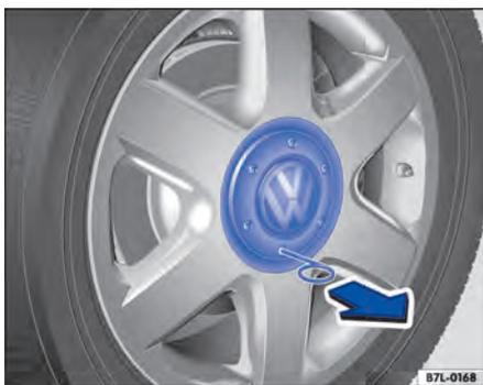
Fig. 272 Retirar a calota central.
