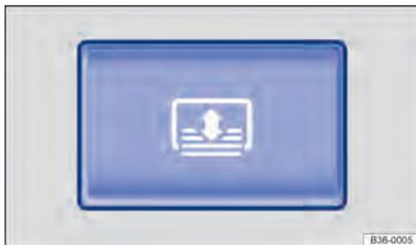
**Fig. 119** No console central: botão da cortina de proteção solar do vidro traseiro.
