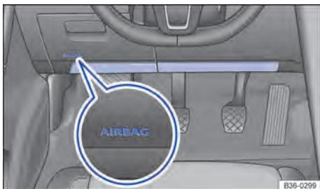
**Fig. 53** No lado do condutor: local de instalação do airbag para joelhos.
