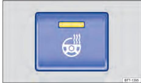
Fig. 124 Na parte inferior do console central: botão do aquecimento do volante.
