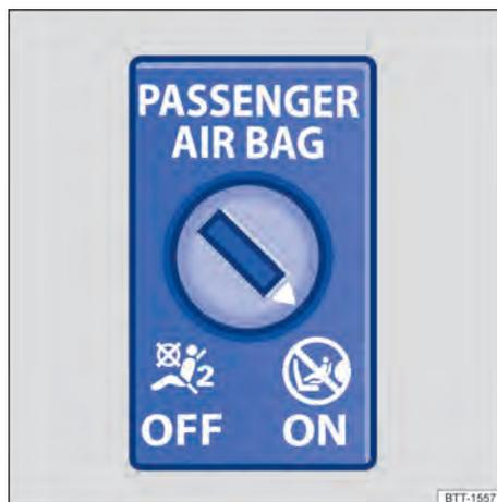
**Fig. 48** No lado do passageiro dianteiro, no painel de instrumentos ou no porta-objetos: interruptor acionado pela chave para desligar e ligar o airbag frontal do passageiro dianteiro.
