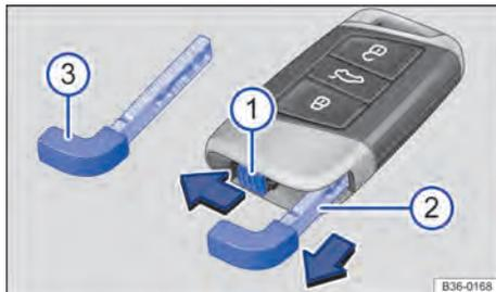
Fig. 72 Chave do veículo: destravamento da chave de emergência.
