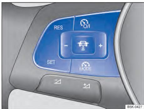
Fig. 155 Lado esquerdo do volante multifunções: botões para a operação do ACC
