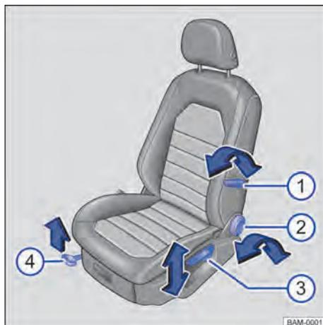
Fig. 90 No banco dianteiro esquerdo: elementos de comando (variante 1).
