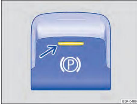
**Fig. 161** No console central: botão do freio de estacionamento eletrônico.
