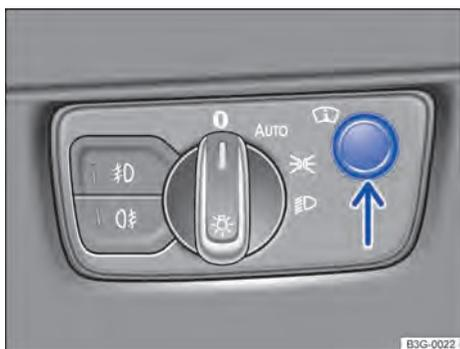
**Fig. 18** Ao lado do volante: regulador do head-up display (seta).
