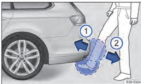
**Fig. 83** Tampa do compartimento de bagagem com abertura controlada por sensor (Easy Open). ▶
