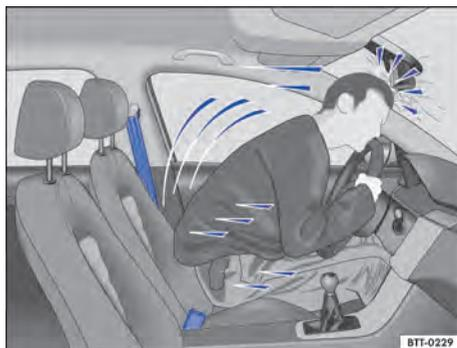
**Fig. 37** O condutor sem cinto de segurança é lançado para frente.
