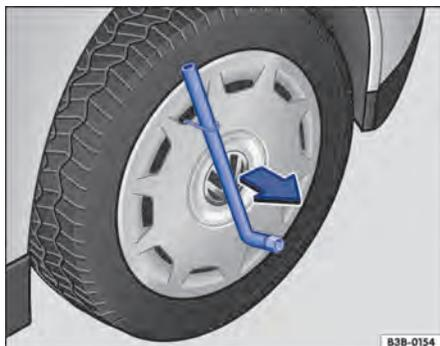
Fig. 274 Retirar a calota integral.
