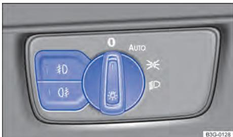
**Fig. 106** Ao lado do volante: interruptor de luzes (uma variante).
