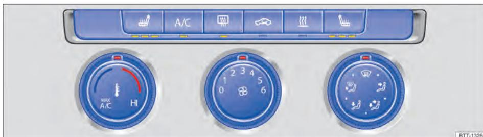
Fig. 120 Na parte superior do console central: comandos do ar-condicionado manual.
