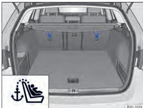
**Fig. 61** No compartimento de bagagem: cinto de fixação superior pendurado (Variant).
