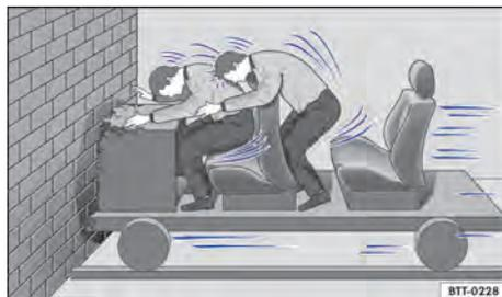
Fig. 36 Um veículo com os ocupantes do veículo sem cintos de segurança colide com o muro.
