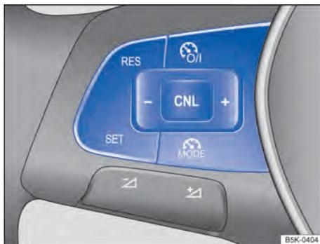
**Fig. 151** Lado esquerdo do volante multifunções: botões para comandar o limitador de velocidade.
