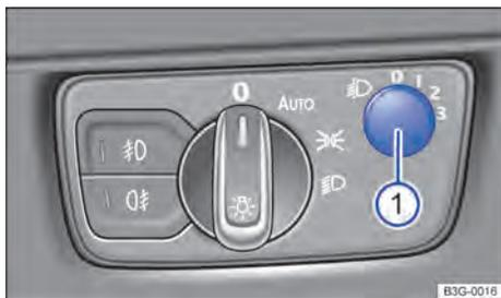
**Fig. 109** Ao lado do volante: regulador da regulagem de alcance do farol
