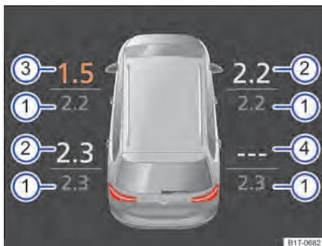
**Fig. 265** Representação esquemática do indicador do display no instrumento combinado: pressões dos pneus atuais.
