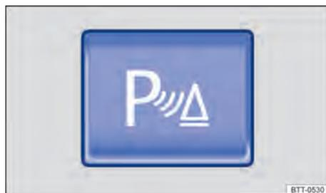
**Fig. 163** No console central: botões para ligar e desligar o auxílio de estacionamento (dependendo da versão).
