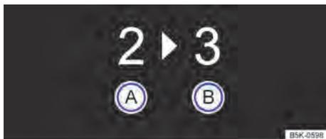
Fig. 128 No display do instrumento combinado: recomendação de marcha.
