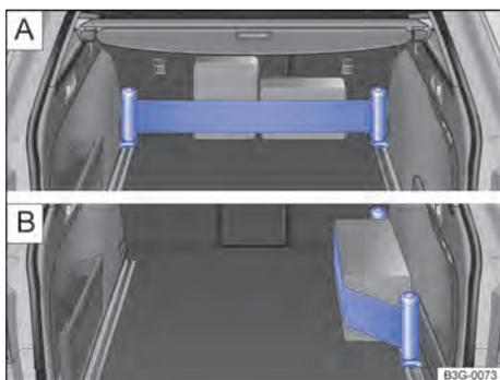
**Fig. 211** No compartimento de bagagem: **A** cinta de fixação fixada sobre dois trilhos. **B** cinta de fixação fixada sobre um trilho.
