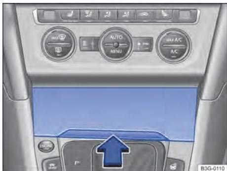
Fig. 180 No console central dianteiro: abrir o cinzeiro.
