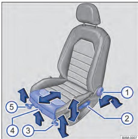
**Fig. 91** No banco dianteiro esquerdo: elementos de comando (variante 2).
