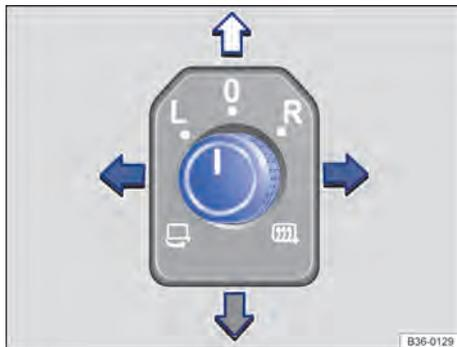
Fig. 115 Na porta do condutor: botão rotativo dos espelhos retrovisores externos.
