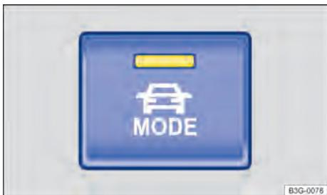
Fig. 141 Na parte inferior do console central: botão de seleção do perfil de condução.
