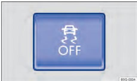
Fig. 172 No controle central: botão para desligar e ligar ASR manualmente.
