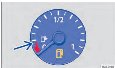
Fig. 22 No instrumento combinado: indicador do nível de combustível para gasolina e óleo diesel.
