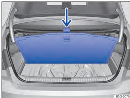
Fig. 191 No compartimento de bagagem: assoalho do compartimento de bagagem enganchado.
