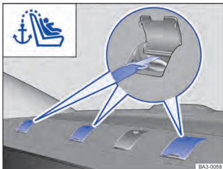
**Fig. 60** No porta-objetos atrás dos bancos traseiros: olhal de retenção do Top Tether (Passat).
