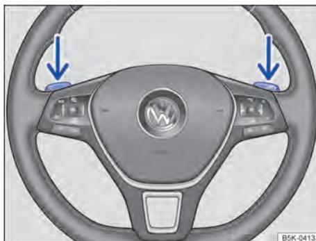
**Fig. 138** Volante com seletores basculantes do Tiptronic.
