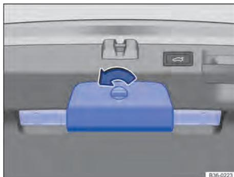
Fig. 66 Na tampa do compartimento de bagagem: suporte para o triângulo de segurança (Passat Variant).
