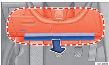
**Fig. 54** No lado do condutor: área de expansão do airbag para joelhos.
