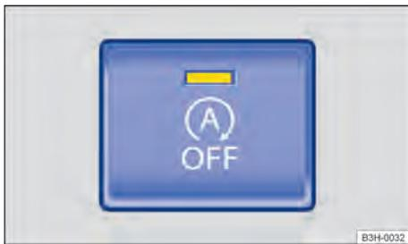
Fig. 133 Na parte inferior do console central: botão do sistema Start-Stop.
