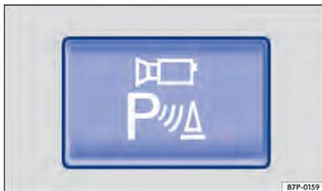
Fig. 170 No console central: botão para a ligação manual da visão do ambiente.
