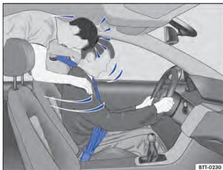
**Fig. 38** O passageiro sem cinto de segurança no banco traseiro é lançado para frente sobre o condutor com cinto de segurança.
