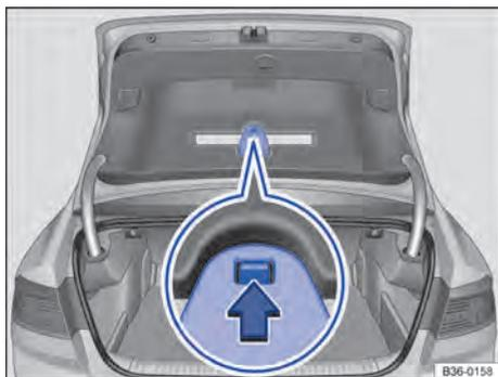
**Fig. 67** Na tampa do compartimento de bagagem: suporte para o triângulo de segurança (Passat).
