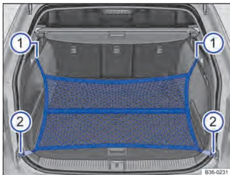
Fig. 210 No compartimento de bagagem: rede para bagagem presa no canto do compartimento de bagagem.
