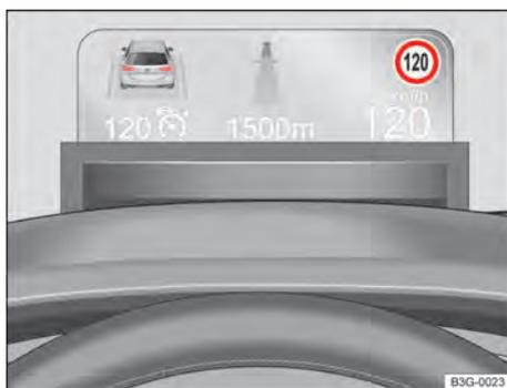
**Fig. 19** No painel de instrumentos acima do volante: exemplos de indicações no head-up display. ▶
