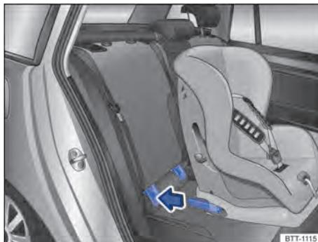
**Fig. 59** Representação esquemática: instalar a cadeira de criança ISOFIX com os braços de apoio.
