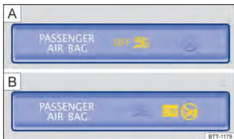
Fig. 45 Na parte superior do console central: luz de controle para o airbag frontal do passageiro dianteiro desligado [A] ou luz de controle para o airbag frontal do passageiro dianteiro ligado [B].
