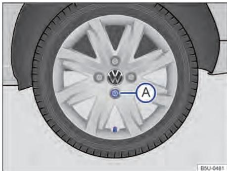
Fig. 204 Retirar a supercalota.
