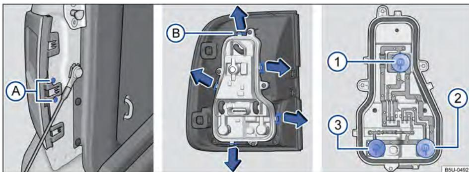
**Fig. 173** Lanterna traseira: Ⓒ desinstalar o suporte das lâmpadas e ①, ②, ③, ④ e ⑤ desinstalar as lâmpadas.
