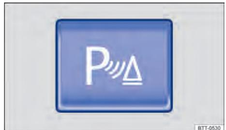
**Fig. 89** Na parte superior do console central: botão para ligar e desligar o controle de distância de estacionamento (Park Pilot). ▶
