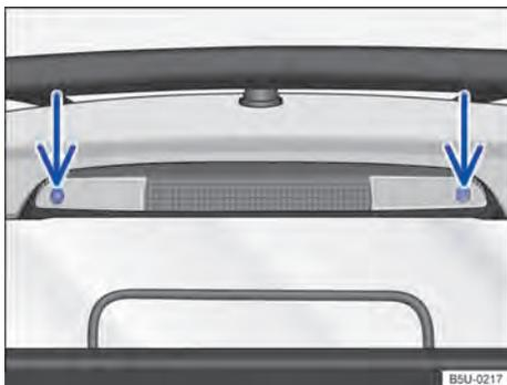
Fig. 176 No compartimento de carga: remover a lanterna de freio elevada.
