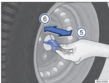
Fig. 201 Na roda de emergência: remover o cabo da roda de emergência.
