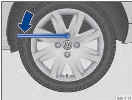
Fig. 205 Troca de roda: soltar os parafusos da roda.
