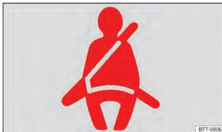
**Fig. 21** Luz de advertência no display do instrumento combinado.
