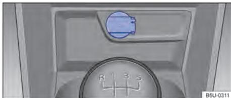
Fig. 106 No console central dianteiro: tomada 12 V.
