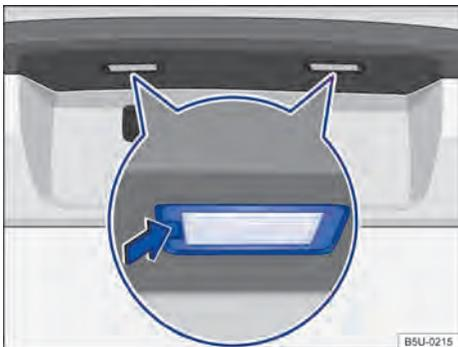
Fig. 174 No para-choque traseiro: remover a lanterna da placa de licença.
