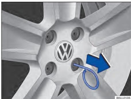
**Fig. 203** Retirar as capas de cobertura dos parafusos da roda.
