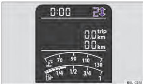
Fig. 79 No instrumento combinado: indicador de troca de marcha (variante 1).
