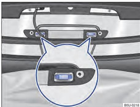
Fig. 177 Lanterna de freio elevada: remover a lâmpada incandescente da iluminação do compartimento de carga.
