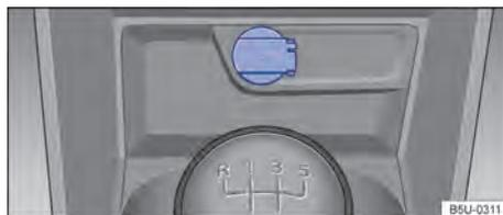
Fig. 104 No console central dianteiro: tomada 12 V.
