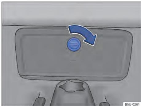
Fig. 163 No assoalho do banco traseiro: acesso à caixa de fixação das ferramentas de bordo.
