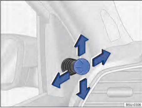
Fig. 71 Nas portas dianteiras: interruptor de ajuste dos espelhos retrovisores externos mecânicos.
