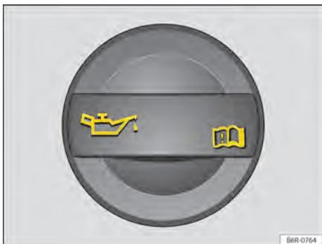
**Fig. 190** No compartimento do motor: tampa da abertura para enchimento de óleo do motor.
