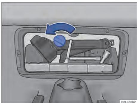
Fig. 164 Manipulo de fixação da caixa de ferramentas de bordo.
