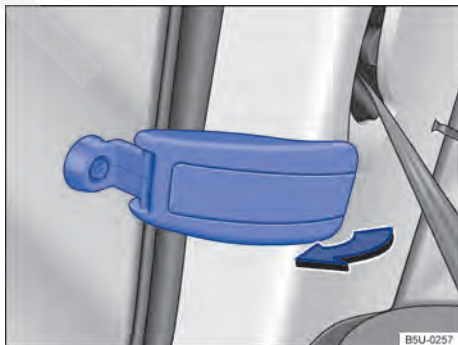
Fig. 38 Abrir o vidro basculante traseiro.
