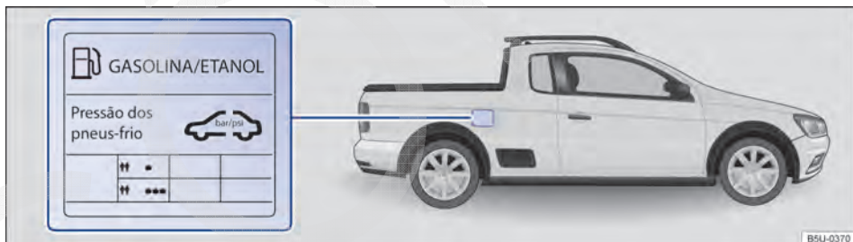
Fig. 162 Na parte interna da portinhola do tanque de combustível: etiqueta com a pressão dos pneus.
