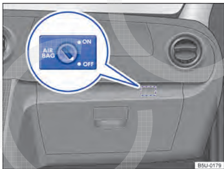
Fig. 69 No porta-luvas (Nova Saveiro Robust): interruptor desacionado pela chave para desligar e ligar o airbag frontal do passageiro.
