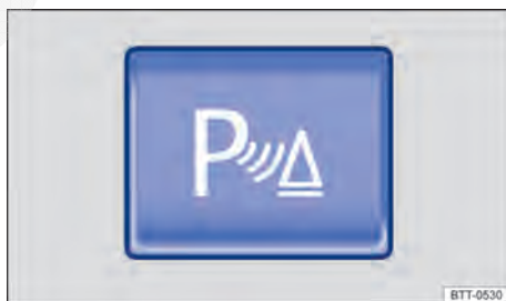
Fig. 133 Na parte superior do console central: botão para ligar e desligar o controle de distância de estacionamento (Park Pilot).
