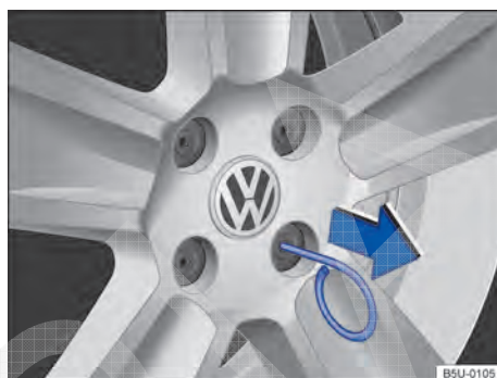
Fig. 167 Retirar as capas de cobertura dos parafusos da roda.
