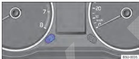
Fig. 75 No instrumento combinado (Nova Saveiro Robust): tecla de regulagem da iluminação dos instrumentos e dos interruptores.
