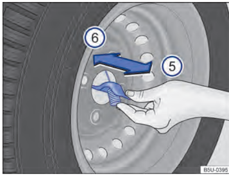
Fig. 165 Na roda de emergência: remover o cabo da roda de emergência.
