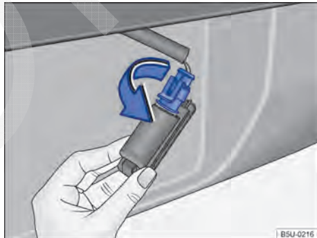
Fig. 209 Lanterna da placa de licença: remover o soquete da lâmpada.
