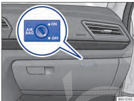
Fig. 68 No porta-luvas: interruptor desacionado pela chave para desligar e ligar o airbag frontal do passageiro.
