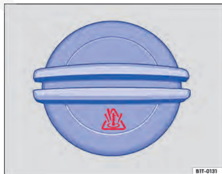
Fig. 157 No compartimento do motor: tampa do reservatório de expansão do líquido de arrefecimento do motor.
