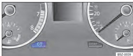
Fig. 74 No instrumento combinado: tecla de regulagem da iluminação dos instrumentos e dos interruptores.
