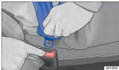
Fig. 58 Soltar a lingueta do cinto de segurança do fecho do cinto de segurança.
