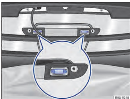
Fig. 211 Lanterna de freio elevada: remover a lâmpada incandescente da iluminação do compartimento de carga.
