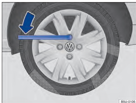
Fig. 169 Troca de roda: soltar os parafusos da roda.
