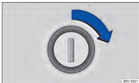
Fig. 33 Cilindro da fechadura para travar e destravar a tampa do compartimento de carga.
