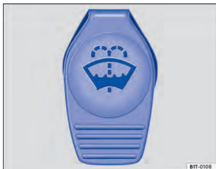
Fig. 82 No compartimento do motor: tampa do reservatório de água dos lavadores do para-brisa.
