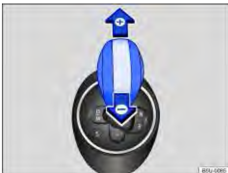
Fig. 104 Alavanca seletora na posição para condução de marcha no modo manual.
