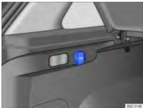
Fig. 93 No compartimento de bagagem: tomada 12 V.
