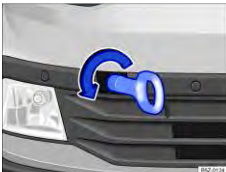
Fig. 190 No para-choque dianteiro à direita: rosquear a argola de reboque.
