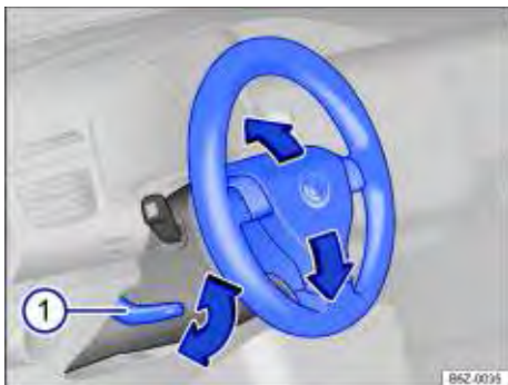
Fig. 42 Ajustar a posição do volante mecanicamente.
