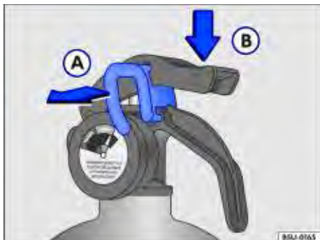
Fig. 152 Sequência de utilização do extintor de incêndio.
