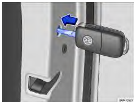
Fig. 156 Travamento de emergência do veículo com a chave do veículo.
