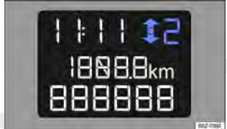
Fig. 101 No instrumento combinado: indicador de troca de marcha (variante 2).
