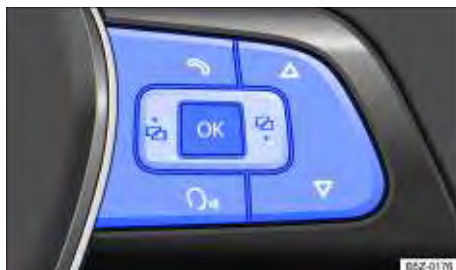
Fig. 13 Lado direito do volante multifunções: teclas de comando dos menus do instrumento combinado.
