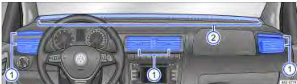
Fig. 123 No painel de instrumentos: difusores de ar.
