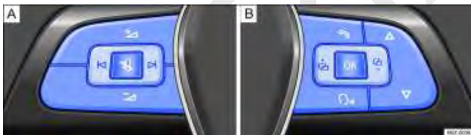
Fig. 15 Volante multifunções: teclas de comando.
