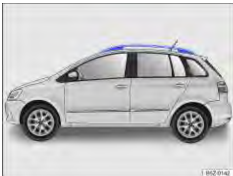
Fig. 80 Suportes longitudinais do bagageiro do teto (ambos os lados).
