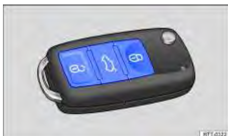
Fig. 26 Teclas na chave do veículo com comando remoto.
