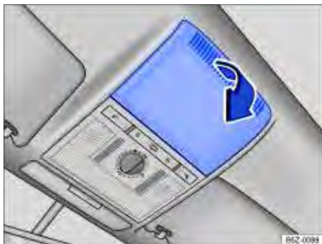
Fig. 157 No revestimento do teto: remover a cobertura.
