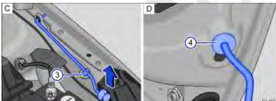
Fig. 128 C: haste de sustentação da tampa do compartimento do motor (3). D: tampa do motor protegida com a haste de sustentação da tampa (4).
