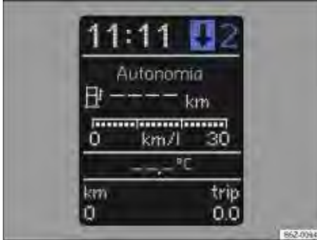
Fig. 100 No instrumento combinado: indicador de troca de marcha (variante 1).
