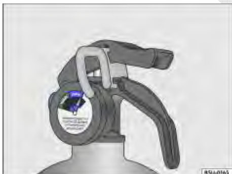
Fig. 153 No extintor de incêndio: indicador de carga (manômetro).
