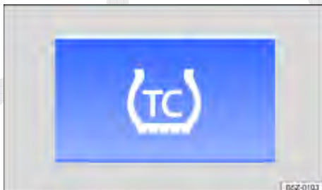
Fig. 110 No console central: botão para desligar ligar TC (controle de tração) manualmente.
