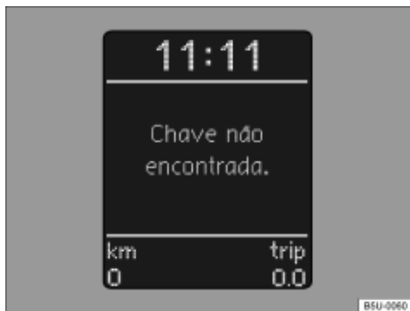
Fig. 95 No instrumento combinado: display com indicação do imobilizador ativado - veículos com Sistema de Informações Volkswagen.
