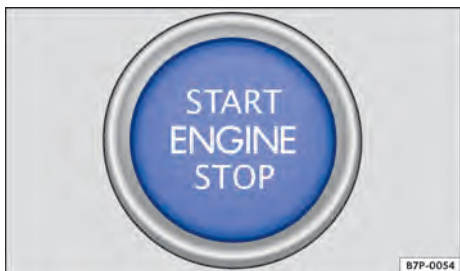
Fig. 140 Na parte inferior do console central: botão de partida do sistema de travamento e de partida Keyless Access sem chave.
