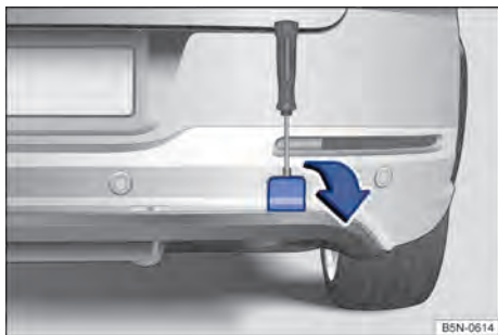
Fig. 252 Para-choque traseiro direito: cobertura do alojamento da argola de reboque.
