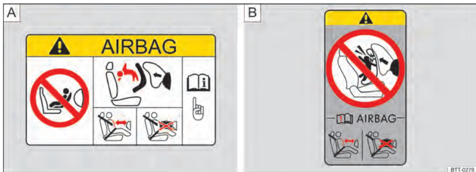
Fig. 77 Representação esquemática: etiqueta do airbag no para-sol A ou na coluna B .
