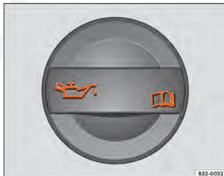
Fig. 193 No compartimento do motor: tampa da abertura para enchimento de óleo do motor.
