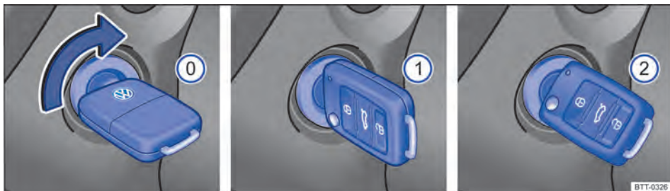
Fig. 139 Ao lado do volante, à direita: posições da chave do veículo no cilindro da ignição.
