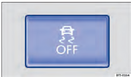
Fig. 150 No console central: botão para desligar e ligar o ASR manualmente.
