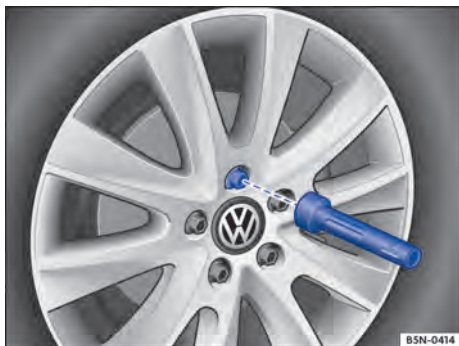
Fig. 231 Troca de roda: desaparafusar os parafusos de roda com o punho da chave de fenda.
