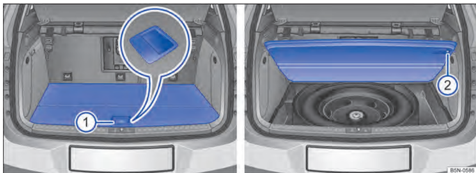
Fig. 104 No compartimento de bagagem: abrir e prender o assoalho variável do compartimento de bagagem.
