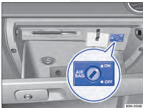
Fig. 74 No porta-luvas: interruptor acionado pela chave para desligar e ligar o airbag dianteiro do passageiro.
