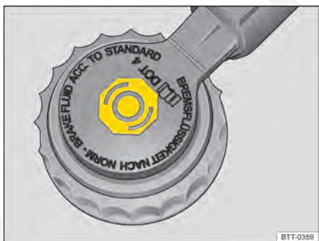
Fig. 151 No compartimento do motor: tampa do reservatório do fluido de freio.
