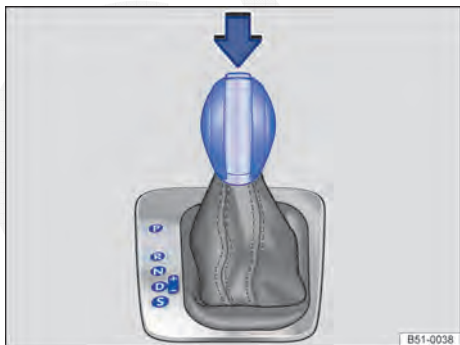
Fig. 145 Veículos com direção à esquerda: alavanca seletora da transmissão automática com botão bloqueador.
