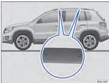
Fig. 109 Veículos com longarina do bagageiro do teto: pontos de fixação para o bagageiro do teto.
