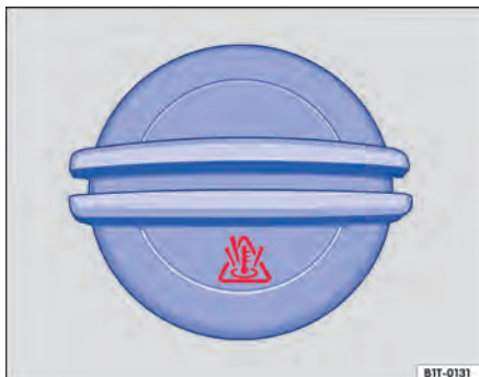
Fig. 196 No compartimento do motor: tampa do reservatório do líquido de arrefecimento do motor.
