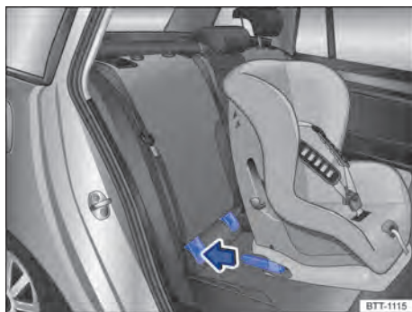
Fig. 80 Representação esquemática: instalar a cadeira de criança ISOFIX com os braços de apoio.
