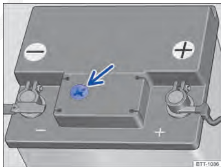
Fig. 198 Representação esquemática: visor no lado superior da bateria do veículo.
