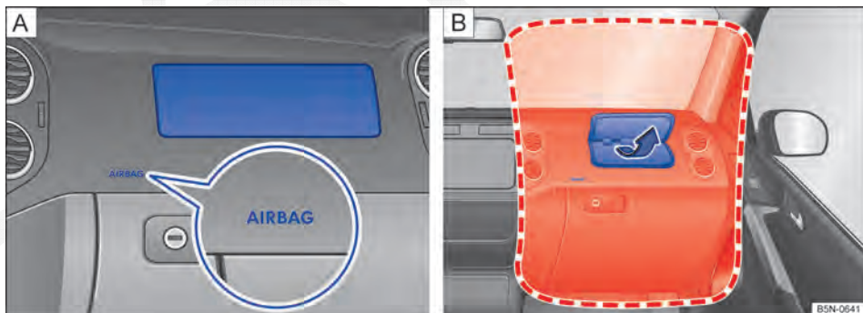
Fig. 73 A Local de instalação e B área de expansão do airbag dianteiro do passageiro dianteiro.
