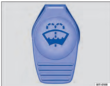
Fig. 92 No compartimento do motor: tampa do reservatório de água dos lavadores dos vidros.
