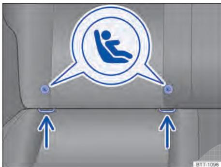
**Fig. 6** Representação esquemática: pontos de ancoragem ISOFIX para as cadeiras de crianças.
