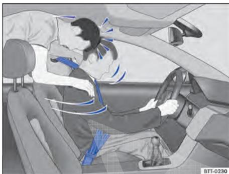
**Fig. 39** O passageiro sem cinto de segurança no banco traseiro é lançado para frente sobre o condutor com cinto de segurança.
