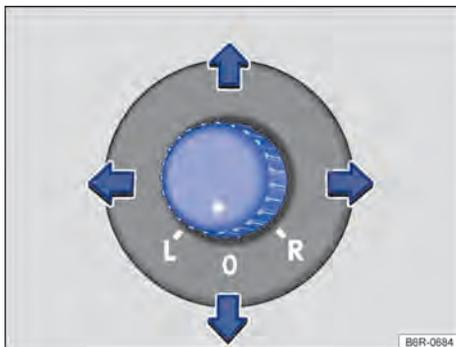
**Fig. 62** Na porta do condutor: botão rotativo de ajuste dos espelhos retrovisores externos elétricos.
