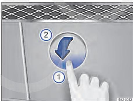
**Fig. 154** No para-choque dianteiro à direita: soltar e remover a cobertura.
