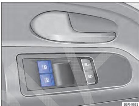
Fig. 28 Na porta do condutor: teclas dos vidros elétricos dianteiros.
