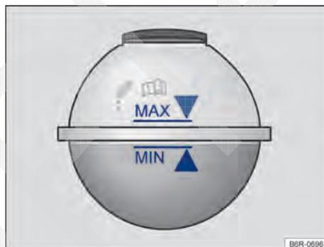
Fig. 107 No compartimento do motor: marcação no reservatório de expansão do líquido de arrefecimento do motor.
