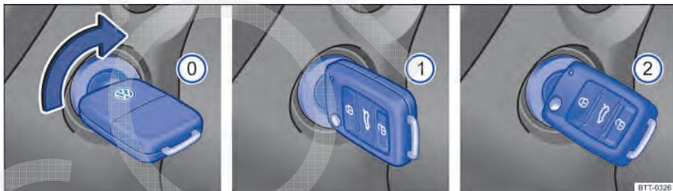
Fig. 82 Ao lado do volante, à direita: posições da chave do veículo no cilindro da ignição.
