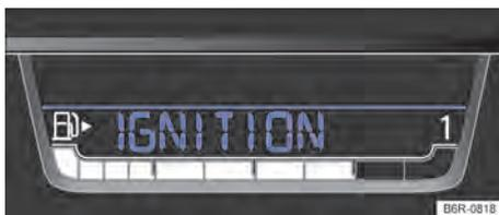
Fig. 11 No display do instrumento combinado: indicador de ignição ligada.
