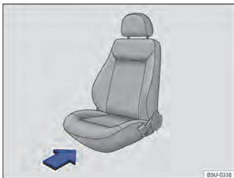
Fig. 50 Na parte frontal do banco do passageiro dianteiro: localização para instalação do suporte do extintor de incêndio.
