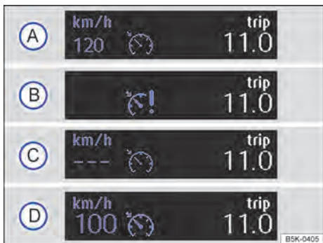
Fig. 100 No display do instrumento combinado: indicadores de status do GRA (representação esquemática).
