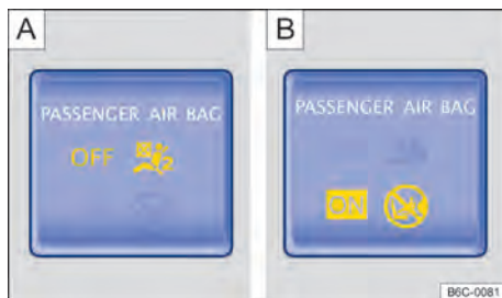
Fig. 36 Na parte superior do console central: luz de controle para o airbag frontal do passageiro dianteiro desligado [A] ou luz de controle para o airbag frontal do passageiro dianteiro ligado [B]. ▶
