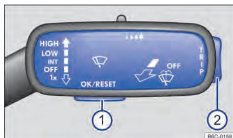
Fig. 21 Veículos sem volante multifunções: botão ① na alavanca dos limpadores do para-brisa para confirmação dos itens de menu e chave ② para alternar entre os menus.
