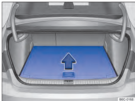
Fig. 115 No compartimento de bagagem: levantar o assoalho variável do compartimento de bagagem.
