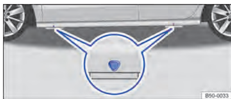
Fig. 202 Pontos de apoio do macaco.
