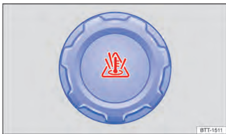
Fig. 190 No compartimento do motor: tampa do reservatório de expansão do líquido de arrefecimento do motor.
