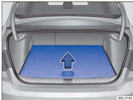
Fig. 151 No compartimento de bagagem: levantar assoalho variável do compartimento de bagagem.
