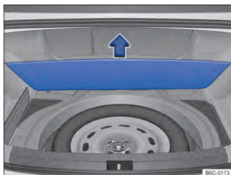
Fig. 158 No compartimento de bagagem, sob o revestimento de assoalho: roda de emergência e ferramentas de bordo.
