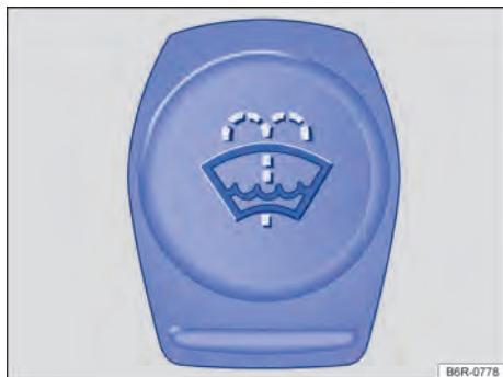
Fig. 186 No compartimento do motor: tampa do reservatório de água dos lavadores do para-brisa.
