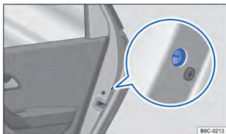
Fig. 56 Na porta traseira: travamento de emergência.
