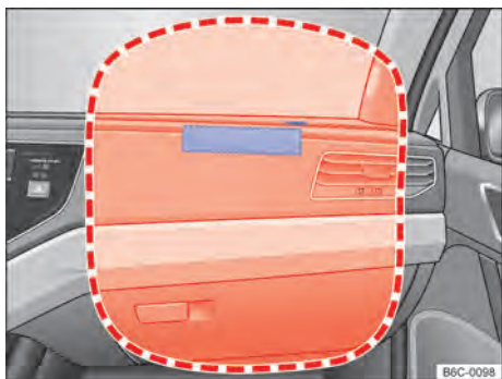
Fig. 36 Local de instalação e área de expansão do airbag frontal do passageiro dianteiro.
