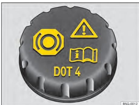
Fig. 187 No compartimento do motor: tampa do reservatório de fluido de freio.
