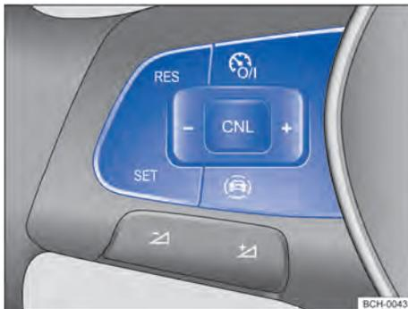
Fig. 97 Lado esquerdo do volante multifunções (variante 1): botões para comandar o limitador de velocidade.
