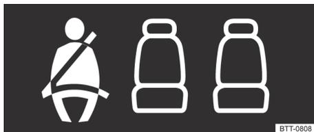
**Fig. 23** Indicador de status do cinto de segurança para os assentos traseiros no display do instrumento combinado.
