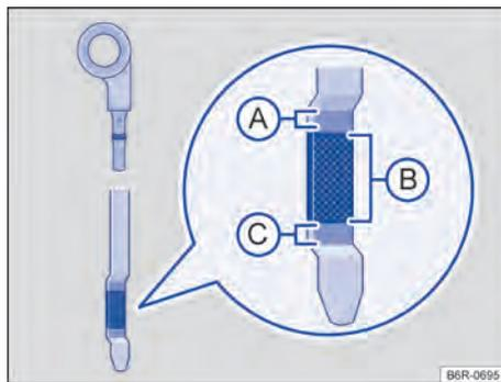
**Fig. 183** Varetas de medição do óleo com marcas de nível do óleo do motor.
