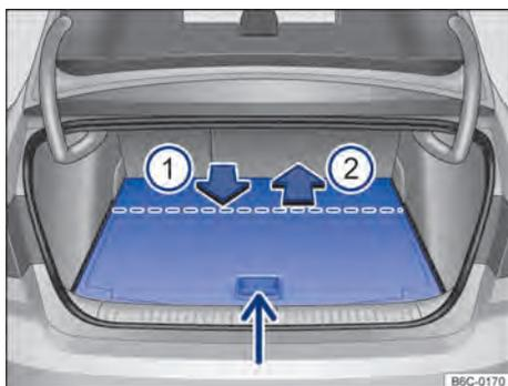
**Fig. 157** No compartimento de bagagem: ajustar a altura do assoalho variável do compartimento de bagagem.
