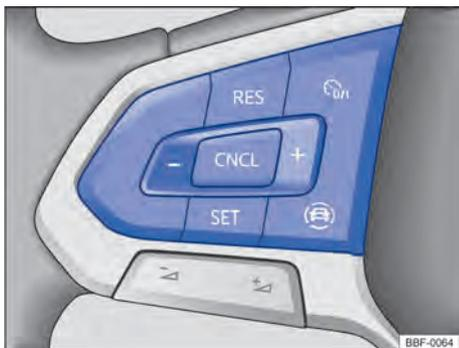
Fig. 96 Lado esquerdo do volante multifunções: botões para comandar o GRA.
