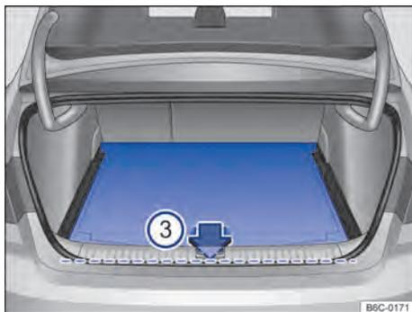
**Fig. 158** No compartimento de bagagem: assoalho variável do compartimento de bagagem .
