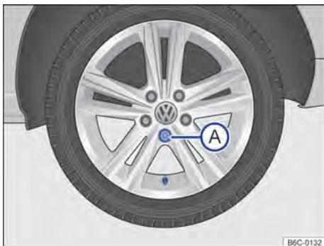
Fig. 196 Retirar a calota integral.
