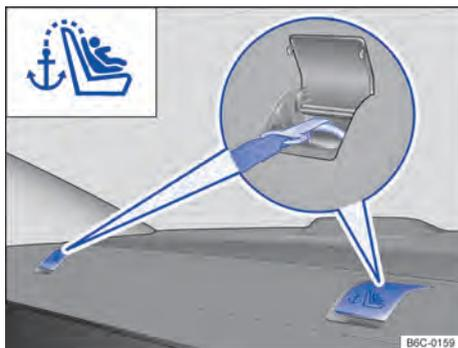
Fig. 44 Olhais de retenção para o cinto de fixação superior na cobertura do compartimento de bagagem.
