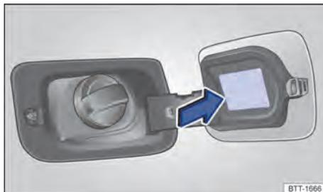
Fig. 192 Na parte interna da portinhola do tanque de combustível: etiqueta com a pressão dos pneus.
