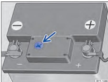
**Fig. 188** No compartimento do motor: exemplo de posição do visor no lado superior da bateria do veículo.
