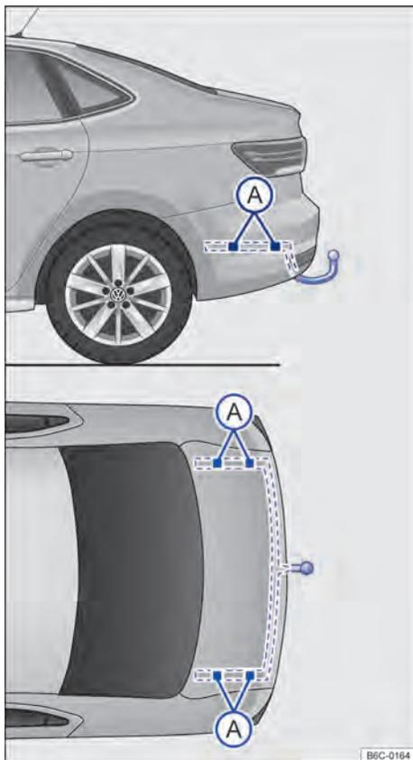
**Fig. 161** Pontos de fixação para instalar um dispositivo de reboque posteriormente.
