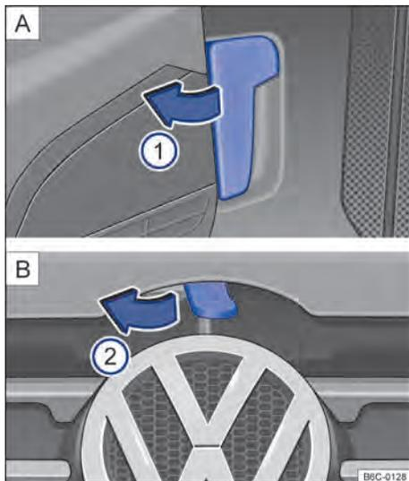
**Fig. 179** **A** Alavanca de destravamento da tampa do compartimento do motor na área para os pés do lado do condutor. **B** Alavanca de destravamento na parte interna da tampa do compartimento do motor. ▶
