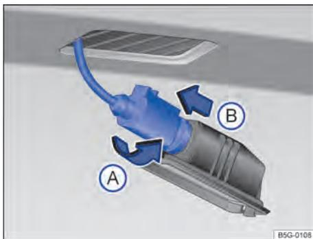
Fig. 169 Lanterna da placa de licença: desinstalar o suporte da lâmpada.
