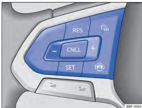
Fig. 98 Lado esquerdo do volante multifunções (variante 2): botões para comandar o limitador de velocidade.
