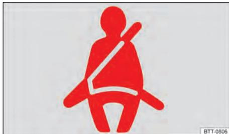
**Fig. 22** Luz de advertência no display do instrumento combinado.
