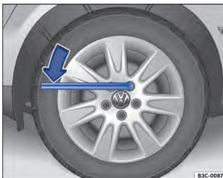
Fig. 198 Troca de roda: soltar os parafusos da roda.
