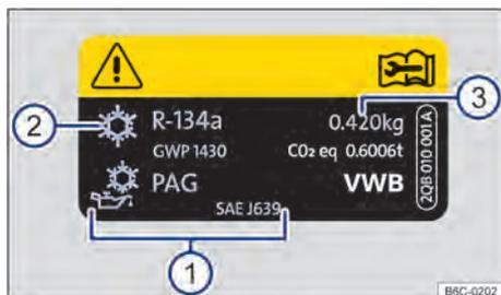
Fig. 206 Informações do ar-condicionado - motor 1.0L TSI, motor 1.4L TSI e motor 1.6L.
