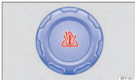
Fig. 186 No compartimento do motor: tampa do reservatório de expansão do líquido de arrefecimento do motor.
