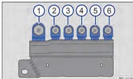
**Fig. 174** No compartimento do motor em cima da bateria: disposição dos fusíveis.
