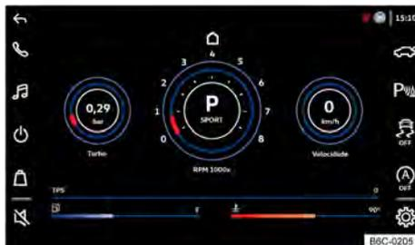
Fig. 19 No display do rádio: monitor de dados do veículo.
