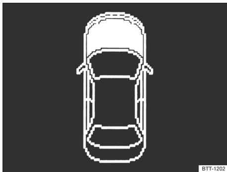
**Fig. 181** No display do instrumento combinado: tampa do compartimento do motor aberta ou fechada incorretamente (representação esquemática).
