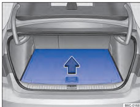
**Fig. 156** No compartimento de bagagem: levantar o assoalho variável do compartimento de bagagem.
