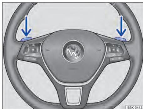
Fig. 94 Volante com seletores basculantes do Tiptronic.
