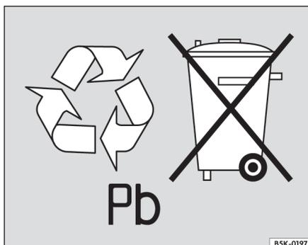
**Fig. 189** As baterias contêm substâncias tóxicas e a sua reciclagem é obrigatória. Por isso, é proibido o seu descarte / disposição com o lixo doméstico e a bateria deve ser devolvida ao revendedor, após a substituição.
