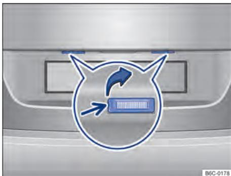
Fig. 168 No para-choque traseiro: lanterna da placa de licença.
