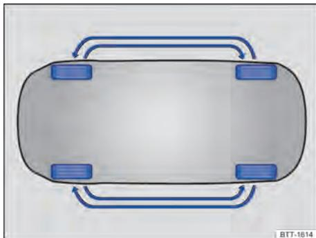
Fig. 190 Esquema para a troca das rodas.
