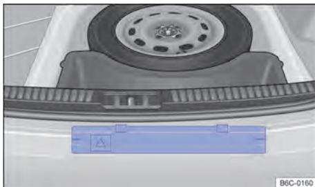
Fig. 49 No compartimento de bagagem: suporte para o triângulo de segurança.
