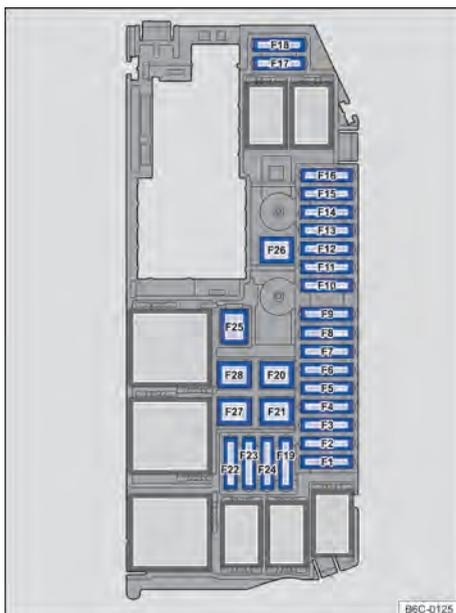
Fig. 173 No compartimento do motor: disposição dos fusíveis.
