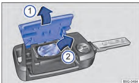
Fig. 53 Chave do veículo: substituir a bateria.
